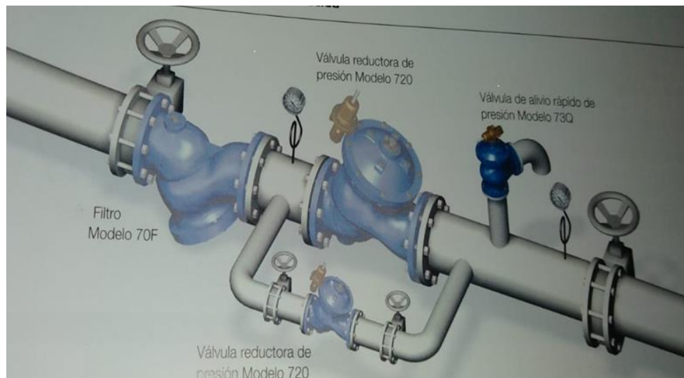
Figura 13 Esquema de un Sistema de Bypass
