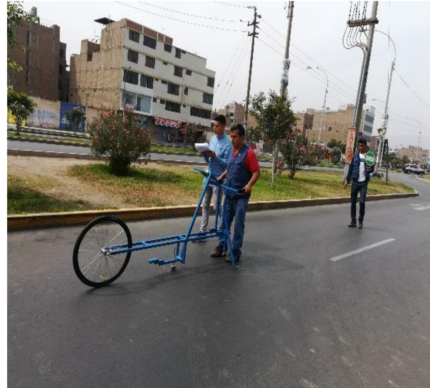
Figura 21. Cálculo de los índices de rugosidad con el equipo Merlin.
