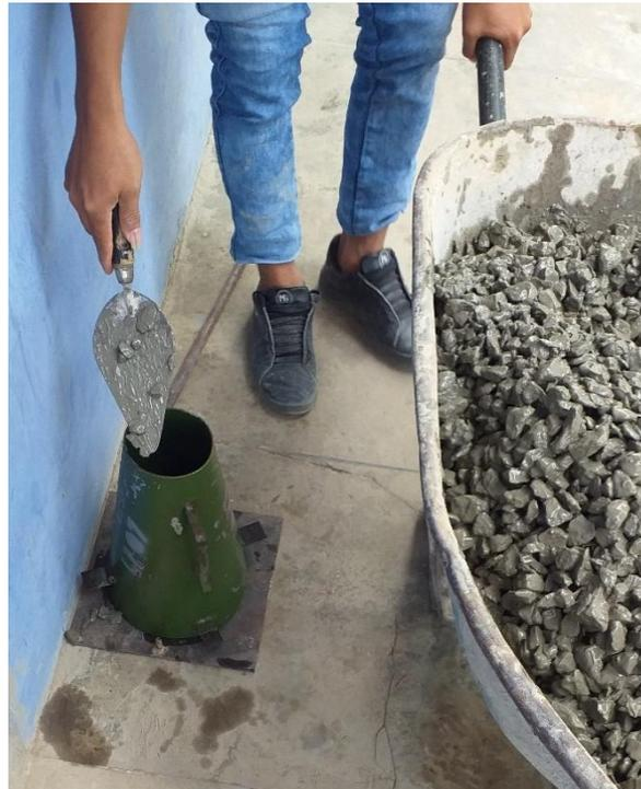
**Figura N° 21:** Vaciado de concreto poroso para ensayo de asentamiento, usando el cono de Abrams: Elaboración propia
