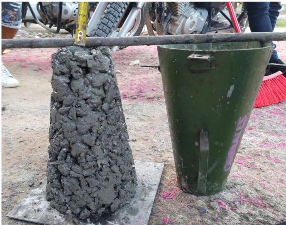
**Figura N° 22:** Determinación de cero asentamientos del concreto poroso, usando el cono de Abrams: Elaboración propia
