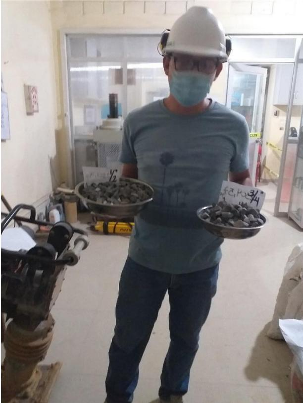
**Figura N° 06:** Pesado y Tarado del agregado, para realizar prueba de abrasión: Elaboración propia.
