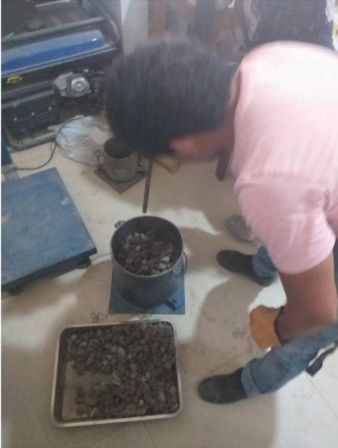
**Figura N° 16:** Compactado del agregado grueso, para determinar peso unitario compactado: Elaboración propia
