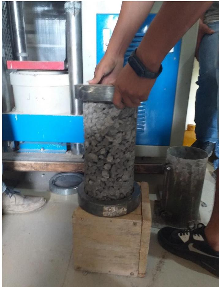
**Figura N° 28:** Proceso de colocación de las probetas de concreto poroso en la prensa para determinar la R. a la compresión: Elaboración propia
