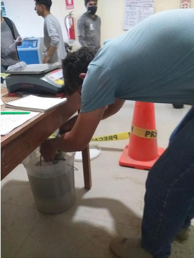
**Figura N° 14:** Sumergimiento de la muestra saturada en agua, para determinar peso específico: Elaboración propia
