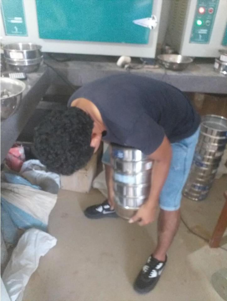
**Figura N° 12:** Tamizado del agregado grueso con los tamices ASTM: Elaboración propia
