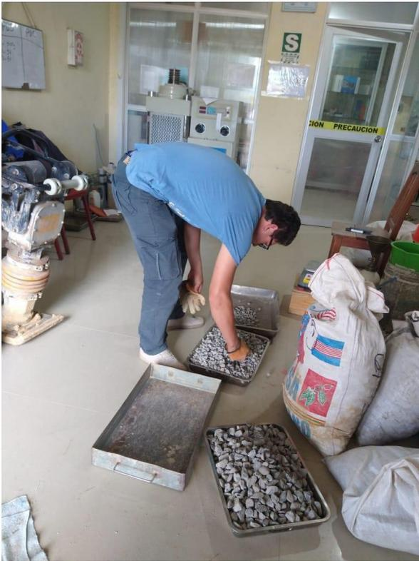
**Figura N° 18:** Pesado de los agregados para elaboración de concreto poroso: Elaboración propia
