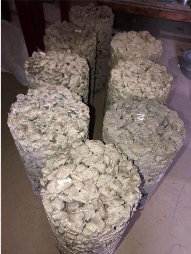
**Figura N° 20:** Testigos de concreto poroso en estado de endurecimiento: Elaboración propia
