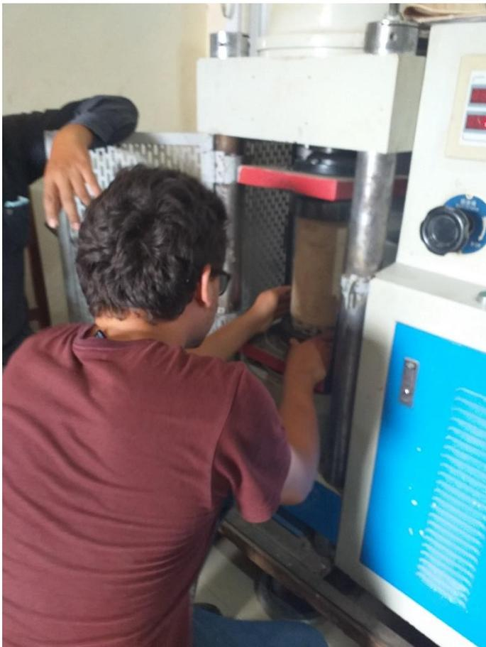
**Figura N° 29:** Proceso de colocación de las probetas de concreto poroso en la prensa para determinar la R. a la compresión: Elaboración propia
