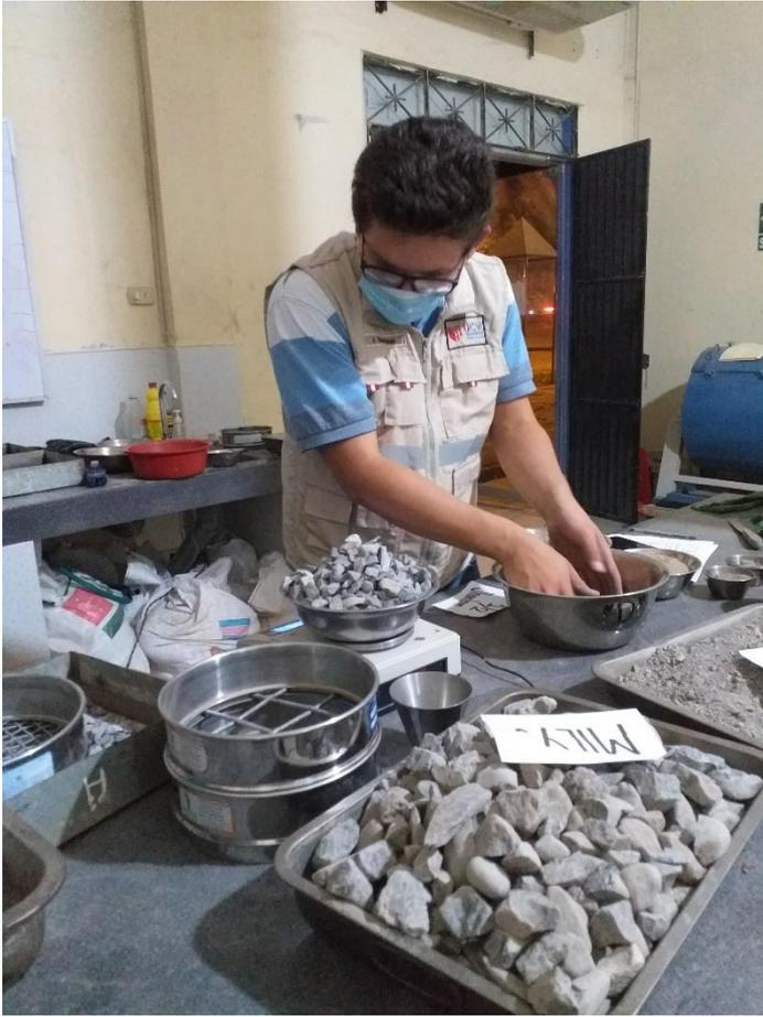
**Figura N° 09:** Pesado y Tarado del agregado grueso para colocarlo en el horno: Elaboración propia
