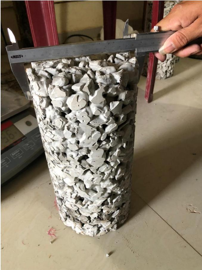
**Figura N° 24:** Determinación del diámetro de las probetas de testigo: Elaboración propia
