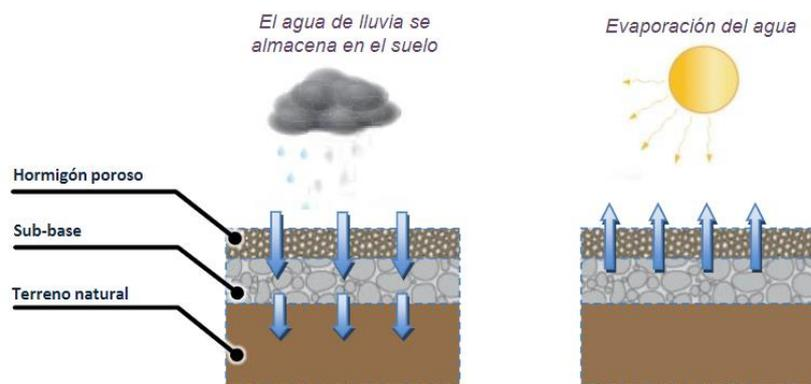
**Figura N° 02:** Partes de pavimento de Concreto Drenantes. Pavimentos de hormigón poroso - Hydromedia, 2013 (p. 4)
