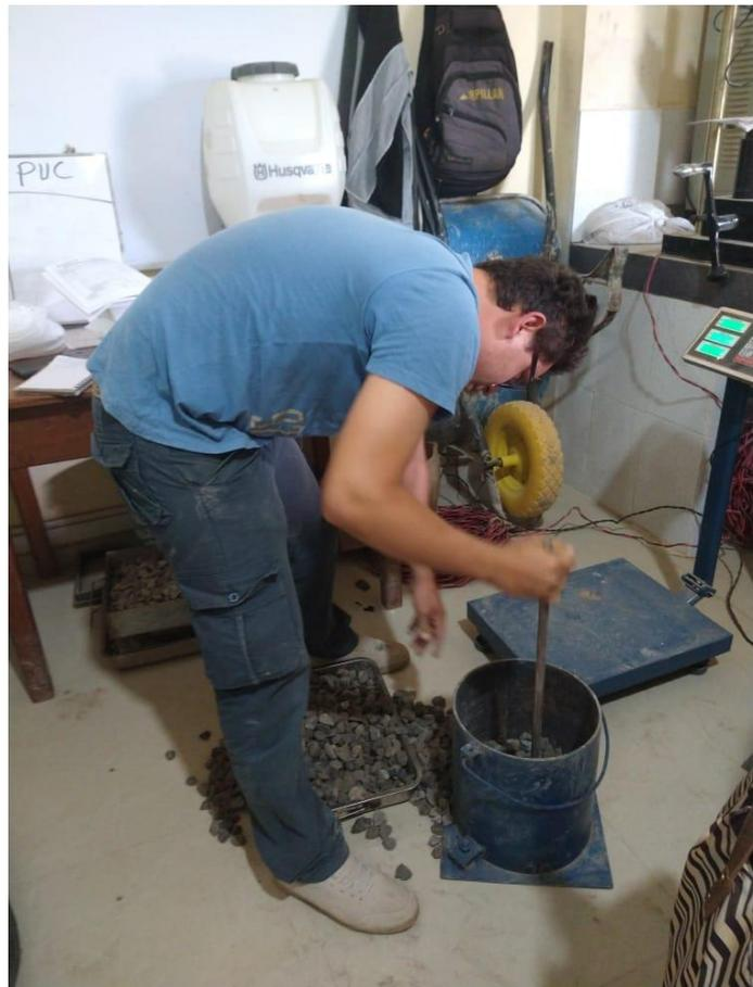
**Figura N° 16:** Compactado del agregado grueso, para determinar peso unitario compactado: Elaboración propia
