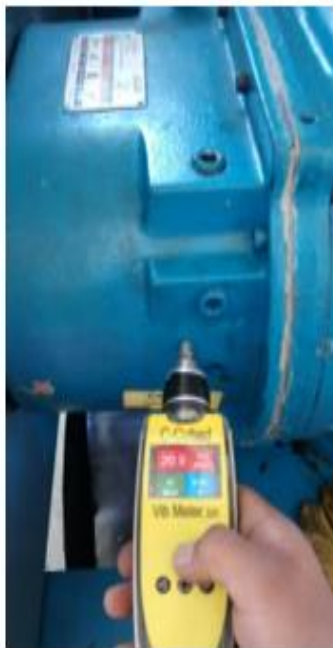
figura n°2, 3 y 4: verificación de análisis vibracionales.
