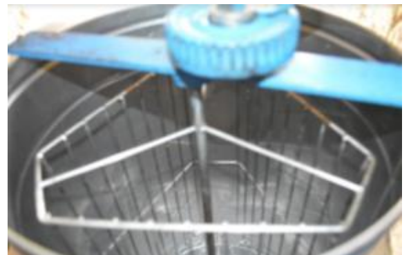
Mecanismo de vueltas para sacar la miel
