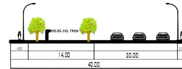
CORTE D-D' PERFIL VIAL AV. FERROCARRIL
