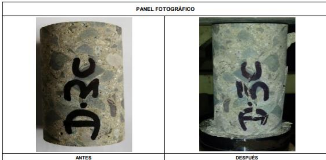
Figura 29: Testigos de concreto, un antes y después del ensayo de compresión.
