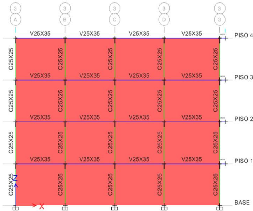
Figura 35. Vista de elevación.
