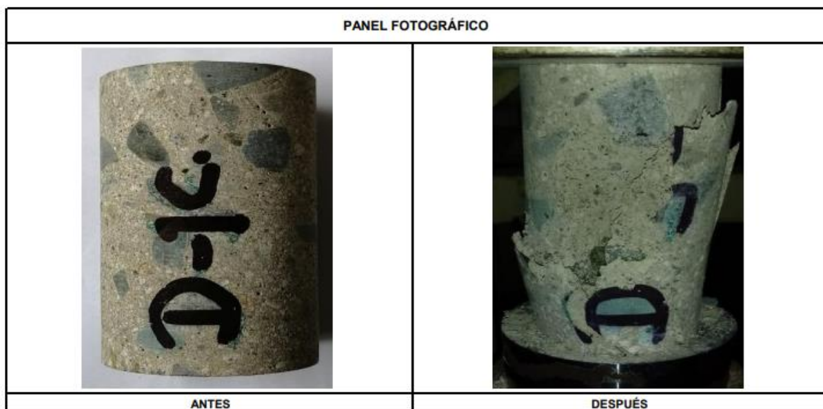
Figura 27: Testigos de concreto, un antes y después del ensayo de compresión.
