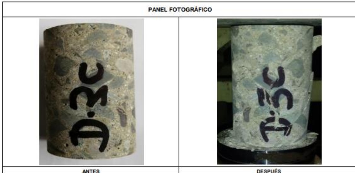
Figura 30: Testigos de concreto, un antes y después del ensayo de compresión.
