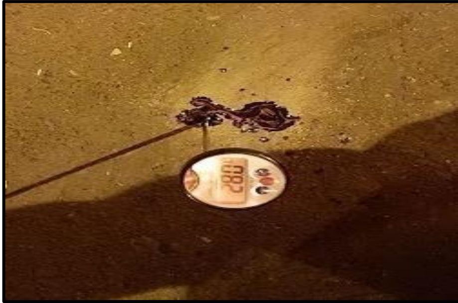
Figura 20. Colocación de aceite al agujero de 5 cm para medir temperatura al pavimento
