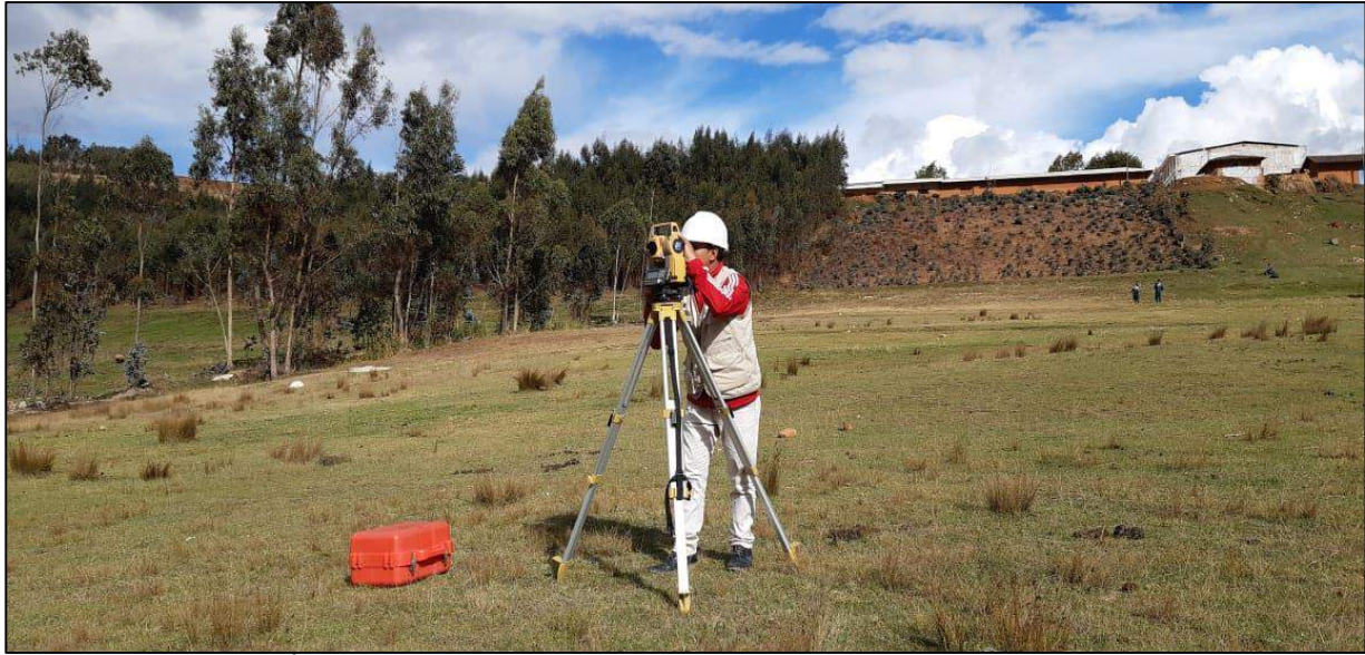
FOTOGRAFÍA N° 12: Se observa la toma de datos con la estación total top con es-105 en la parte más baja, ubicada en el Río Curgos.
