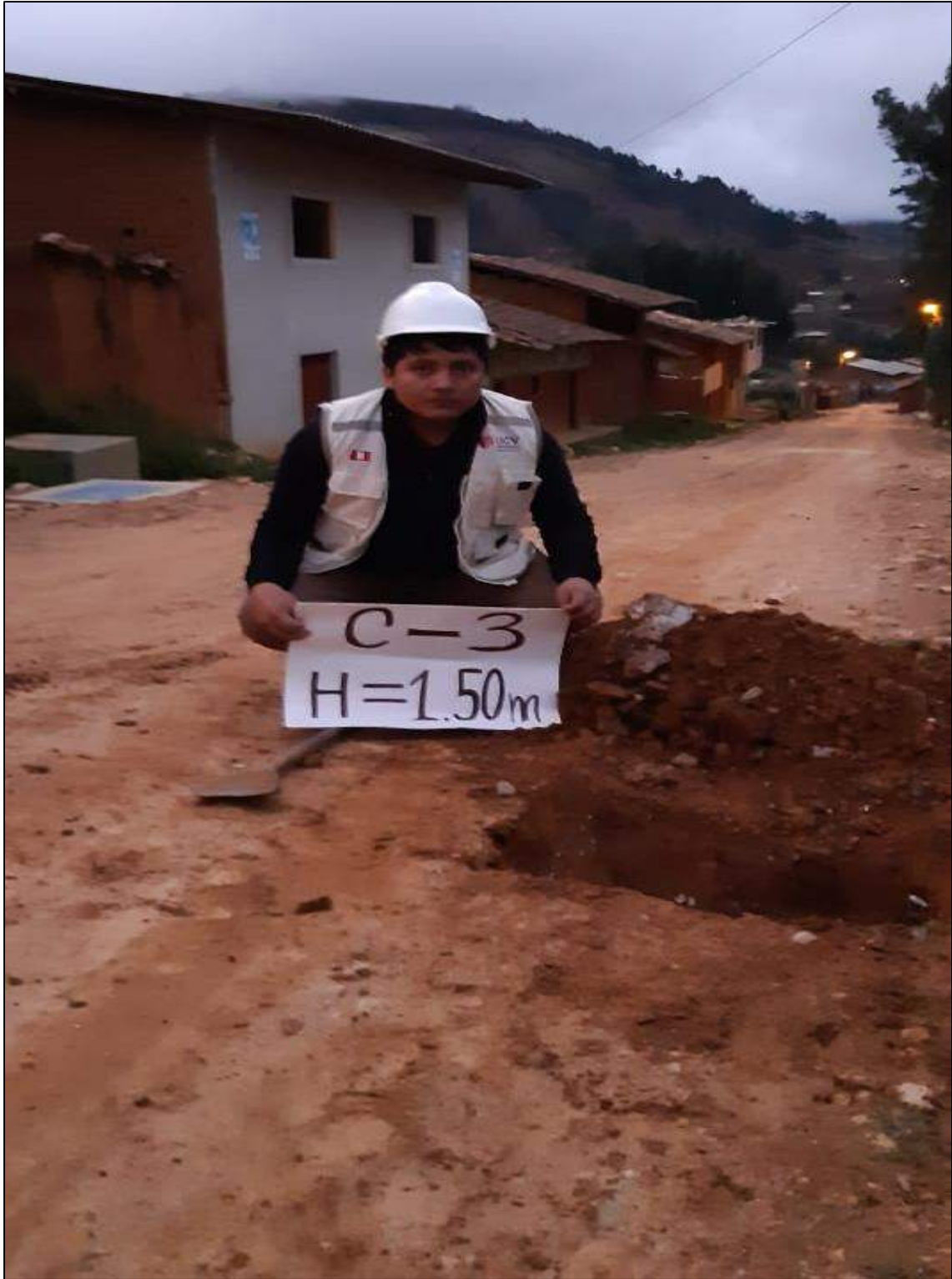
FOTOGRAFÍA N° 15: Se observa la recolección de muestra de la calicata, ubicada entre la Av. Sánchez Carrión. y la Calle 8 de Febrero.
