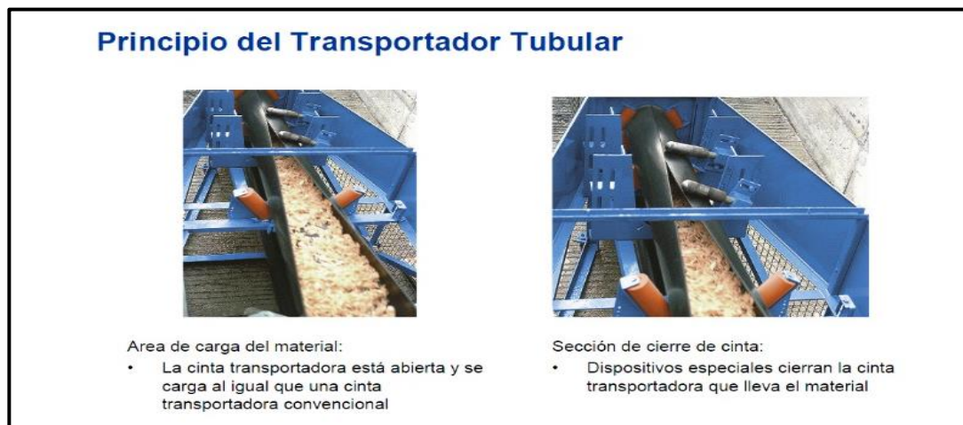
Figura 29. Principio de Transportador Tubular - 1
