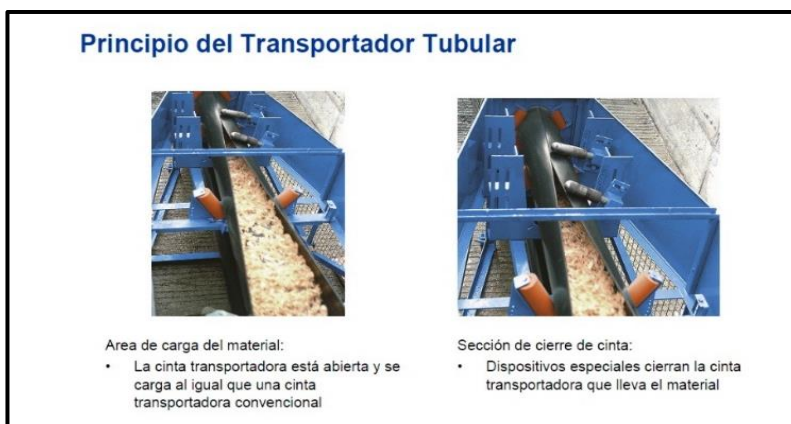
Figura 8. Faja tubular en área de carga
