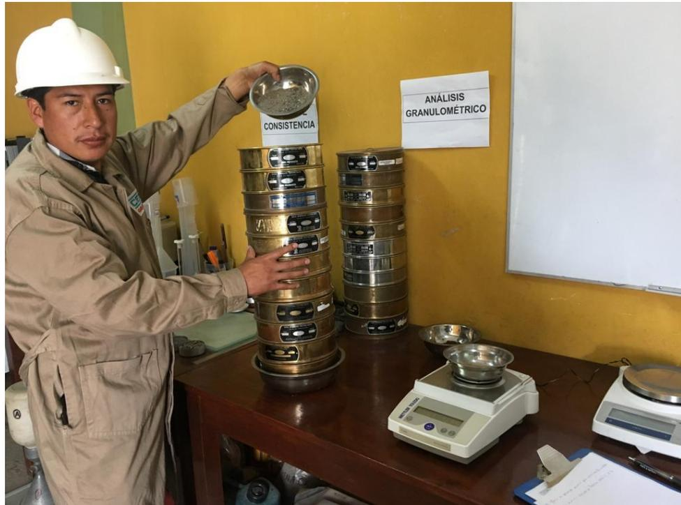
*Imagen No. 5: Juego de tamices utilizados para el análisis granulométrico.*
