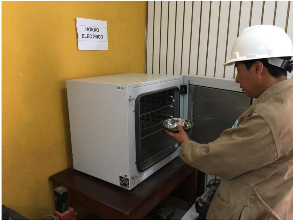
*Figura 1. Secado de material en horno.*
