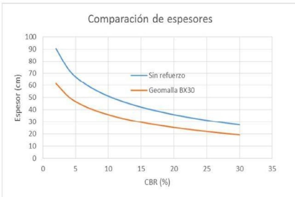
**Figura 11. Comparación de espesores con aplicación de geomallas**
