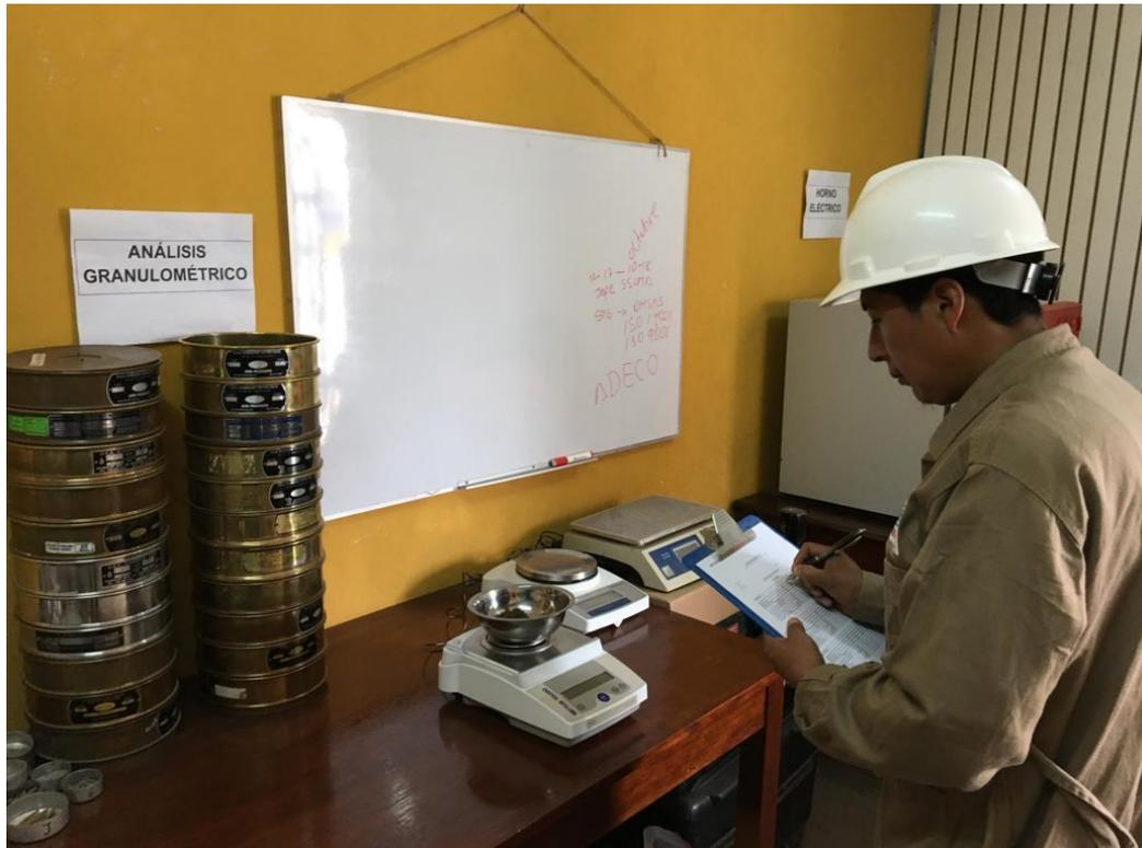
**Figura 2. Pesado de muestra de material.**
