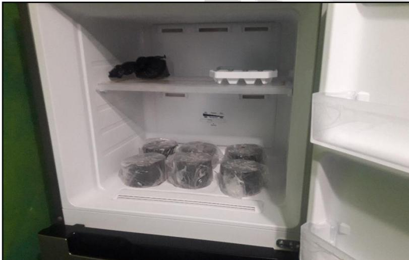
**Fotografía 27.** Todas las briquetas sometidas al baño maría se envuelven en plástico y se refrigeran a una temperatura de -19°C por un periodo de 16 horas.
