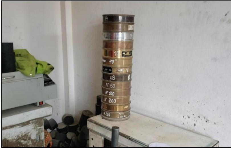
**Fotografía 7.** Tamices para el análisis granulométrico.
