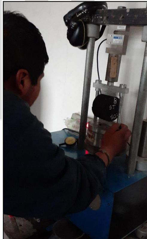
**Fotografía 34 y 35.** Los grupos de briquetas Saturadas y No saturadas con inclusión de aditivo al 0.90% y 1.00%, se ingresan a la prensa Marshall con la mordaza Lottman.
