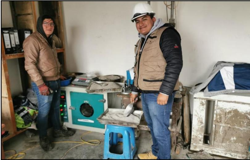
**Fotografía 13.** Combinación de agregados gruesos para el diseño de mezcla asfáltica.
