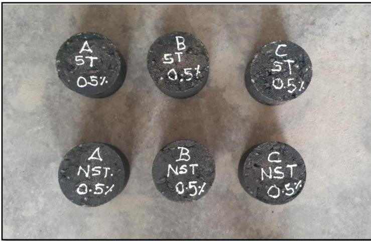
**Fotografía 22.** Primer grupo de briquetas con inclusión del aditivo RICOT Z 3000 al 0.50%, las cuales se subdividen en dos grupos, grupo en vía de humedad (Saturados) y grupo seco (No saturados)
