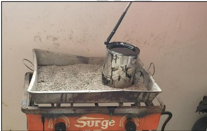
**Fotografía 5.** Incorporación del Cemento Asfáltico (PEN 120 / 150)
