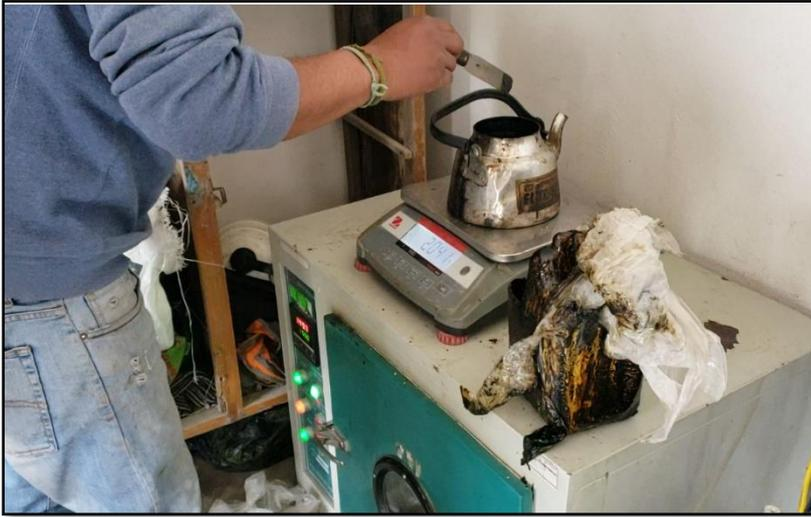
**Fotografía 16.** Combinación del cemento asfáltico (PEN 120/150) con el aditivo RICOT Z 3000.
