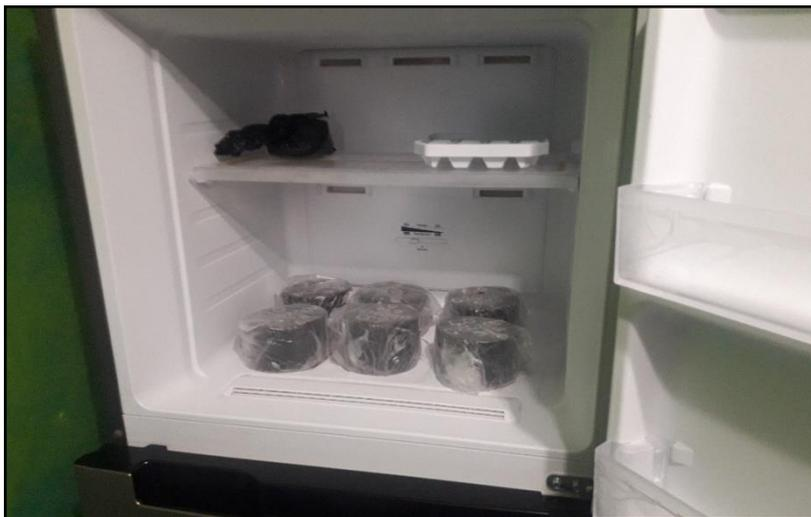
**Fotografía 11.** Congeladora para obtener el congelamiento de la mezcla asfáltica.
