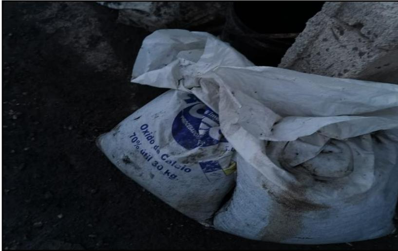
**Fotografía 4.** Incorporación de la Cal Hidratada Tipo C (Fíller)
