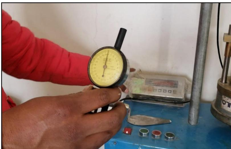
**Fotografía 9.** Flujometro para el análisis del flujo de la mezcla.
