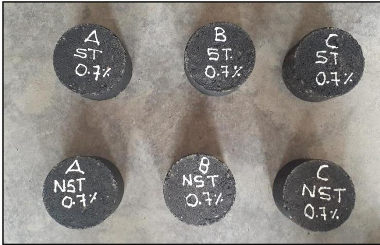
**Fotografía 23.** Segundo grupo de briquetas con inclusión del aditivo RICOT Z 3000 al 0.70%, las cuales se subdividen en dos grupos, grupo en vía de humedad (Saturados) y grupo seco (No saturados)
