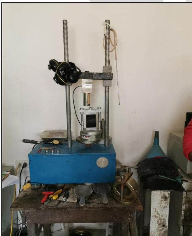
**Fotografía 12.** Prensa Marshall utilizando la mordaza Lottman para hallar la resistencia a la tracción indirecta.
