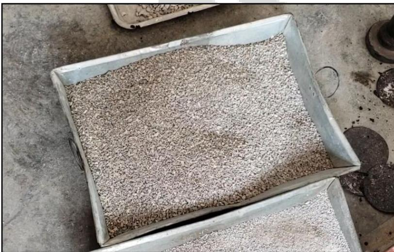
**Fotografía 2.** Selección de los agregados a utilizar en la mezcla asfáltica en caliente:
