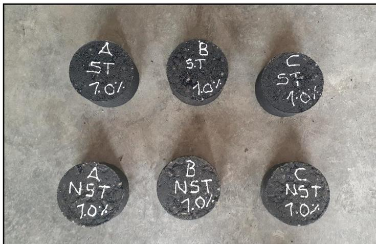
**Fotografía 25.** Cuarto grupo de briquetas con inclusión del aditivo RICOT Z 3000 al 1.00%, las cuales se subdividen en dos grupos, grupo en vía de humedad (Saturados) y grupo seco (No saturados)
