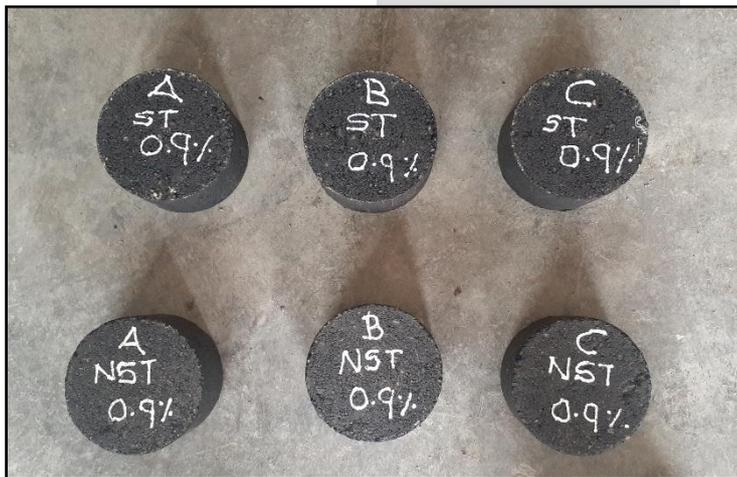
**Fotografía 24.** Tercer grupo de briquetas con inclusión del aditivo RICOT Z 3000 al 0.90%, las cuales se subdividen en dos grupos, grupo en vía de humedad (Saturados) y grupo seco (No saturados)
