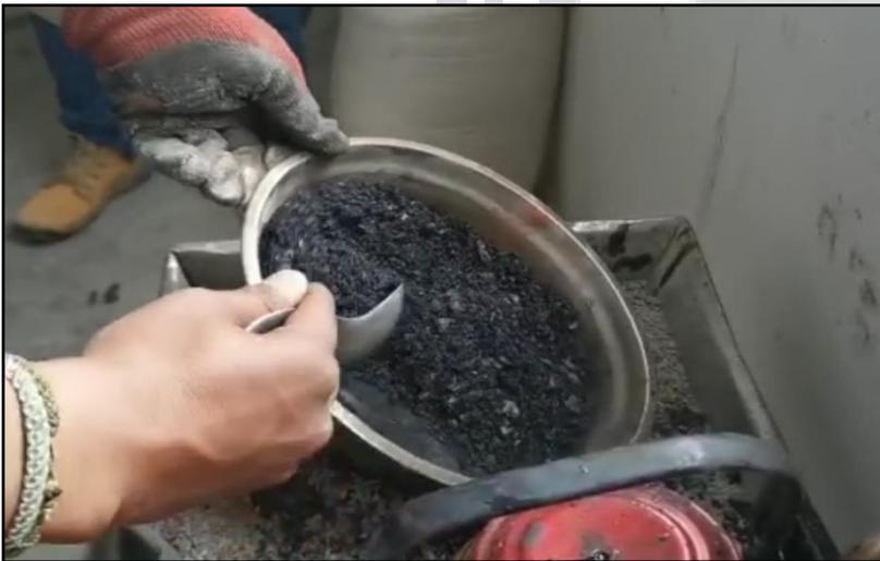
**Fotografía 20.** Preparación de la Mezcla asfáltica en Caliente.
