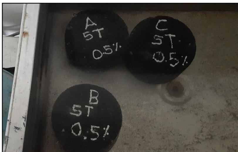
**Fotografía 28.** El grupo de briquetas en vía de humedad (Saturados) con inclusión del aditivo RICOT Z 3000 al 0.50%, se ingresan al baño maría en un promedio de 24 horas. A una temperatura de +60°C aproximadamente.
