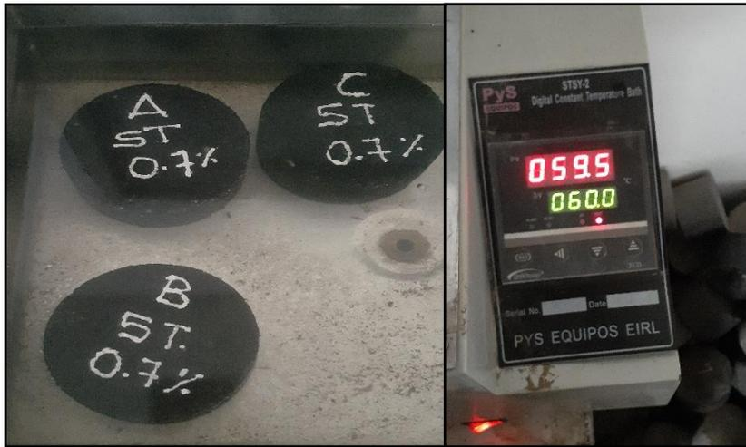
**Fotografía 29.** El grupo de briquetas en vía de humedad (Saturados) con inclusión del aditivo RICOT Z 3000 al 0.70%, se ingresan al baño maría en un promedio de 24 horas. A una temperatura de +60°C aproximadamente.
