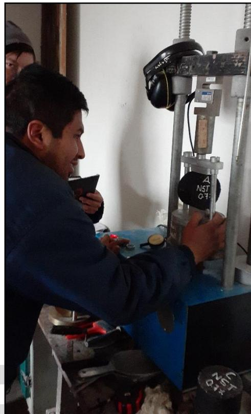
**Fotografía 32 y 33.** Los grupos de briquetas Saturadas y No saturadas con inclusión de aditivo al 0.50% y 0.70%, se ingresan a la prensa Marshall con la mordaza Lottman.
