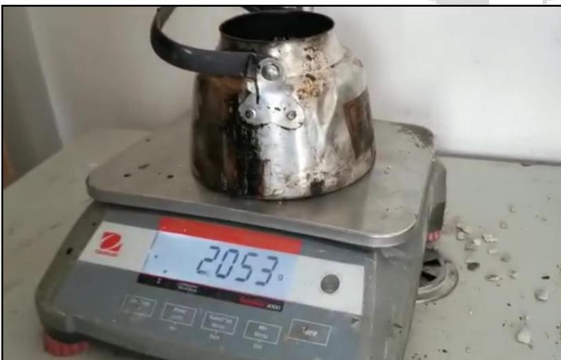
**Fotografía 18.** Peso del Cemento Asfáltico en combinación del aditivo es de 2,053gr.
