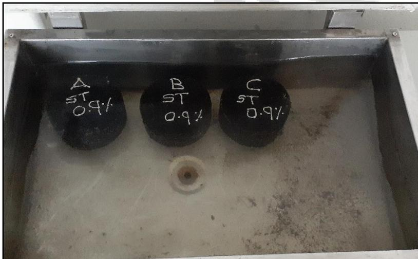
**Fotografía 30.** El grupo de briquetas en vía de humedad (Saturados) con inclusión del aditivo RICOT Z 3000 al 0.90%, se ingresan al baño maría en un promedio de 24 horas. A una temperatura de +60°C aproximadamente.
