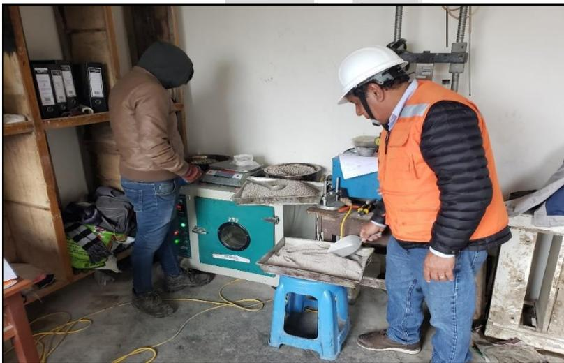
**Fotografía 14.** Combinación de agregados finos para el diseño de mezcla asfáltica.
