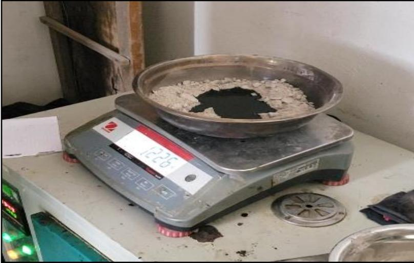
**Fotografía 19.** Combinación de los agregados Pétreos con Cemento asfáltico (PEN 120/150) y el aditivo RICOT Z 3000, con un peso de 1,226gr.
