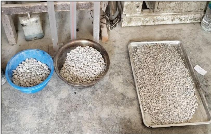
**Fotografía 1.** Selección de los agregados a utilizar en la mezcla asfáltica en caliente:
