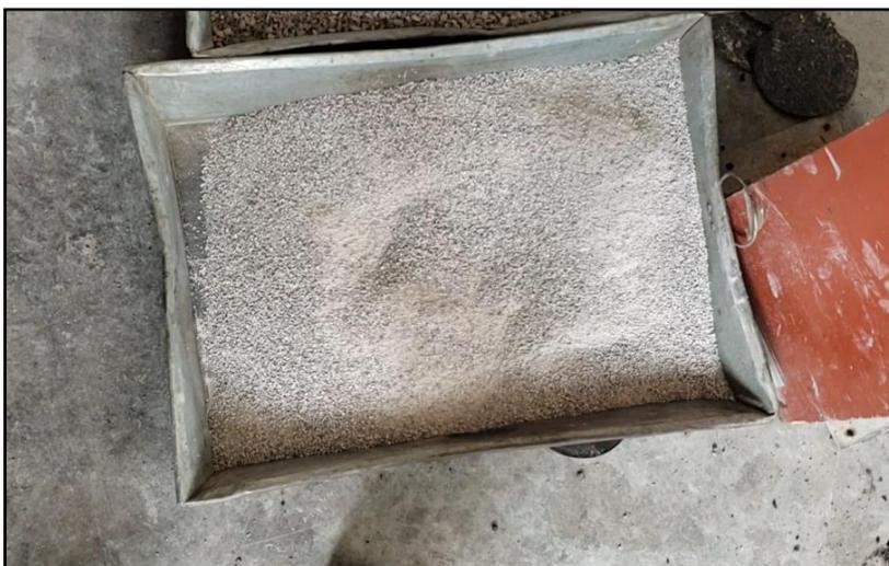
**Fotografía 3.** Selección de los agregados a utilizar en la mezcla asfáltica en caliente:
