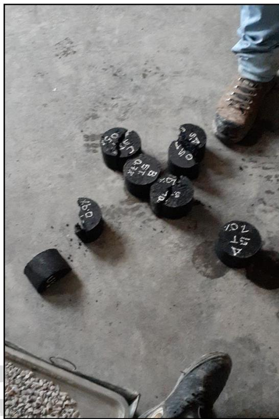
**Fotografía 36 y 37.** Se evalúan las briquetas en el punto de ruptura y se analiza el TSR (Resistencia a la Tracción Indirecta)
