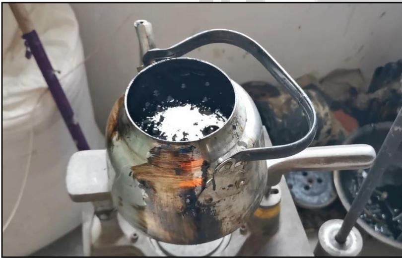
**Fotografía 17.** Reacción química del PEN con la inclusión del aditivo.
