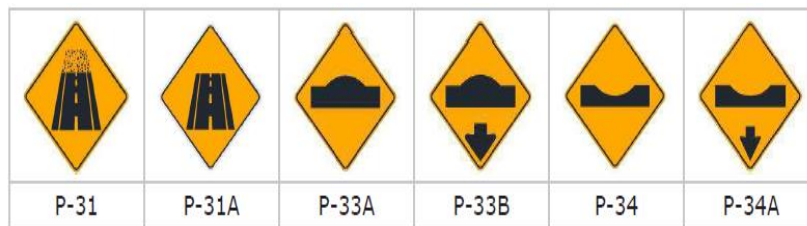
Figura 26. Señal Preventiva – Superficie de Rodadura.
