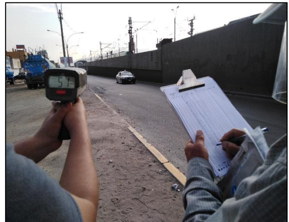
Foto 28. Medición de velocidades sentido S-N.
