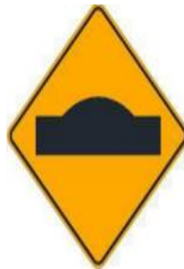
Figura 42. Señal de proximidad reductor de velocidad tipo resalto.
