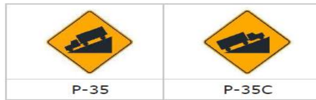
Figura 25. Señal Preventiva – Pendiente Longitudinal.
