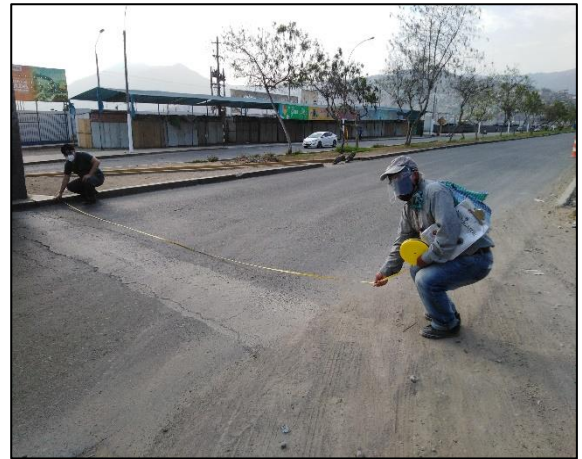
Foto 22. Mediciones de las gibas existentes S-N.
