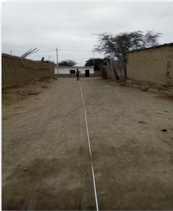
Fotos N° 5: medición de calles para planos del caserío santa Isabel
