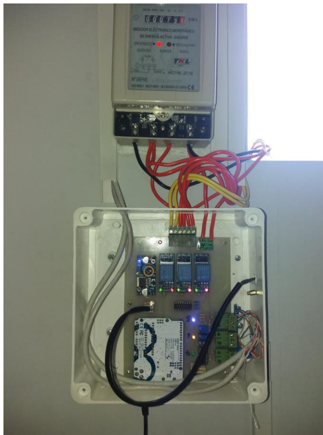
Anexo 26. PCB y conexiones incorporadas en la caja de paso
