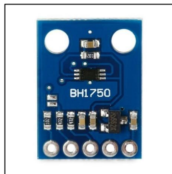
Figura 6. Módulo sensor de luz digital BH1750.
