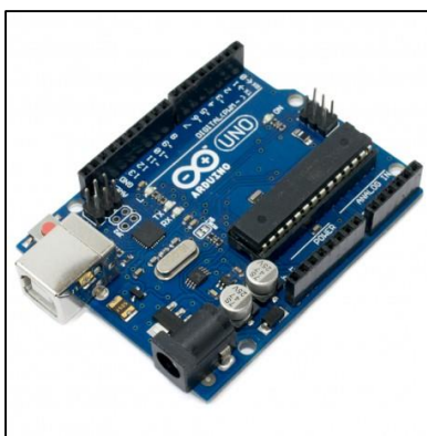
Figura 7. Tarjeta Arduino UNO R3.
