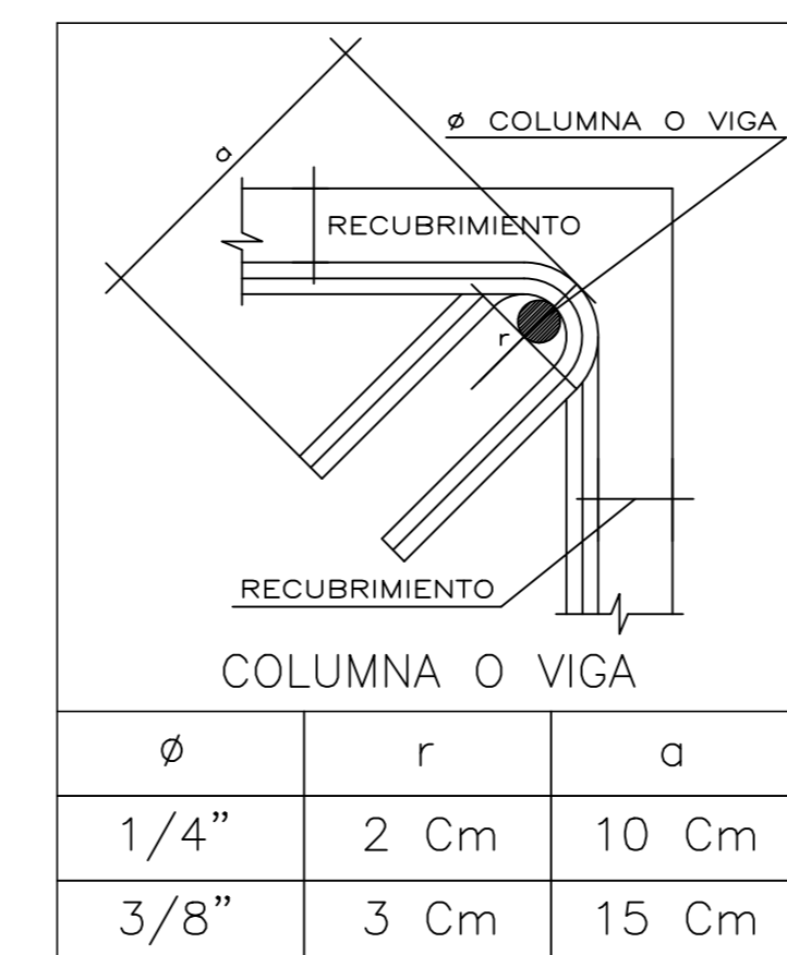
DETALLE DE DOBLADO DE ESTRIBOS ESC. 1/5
