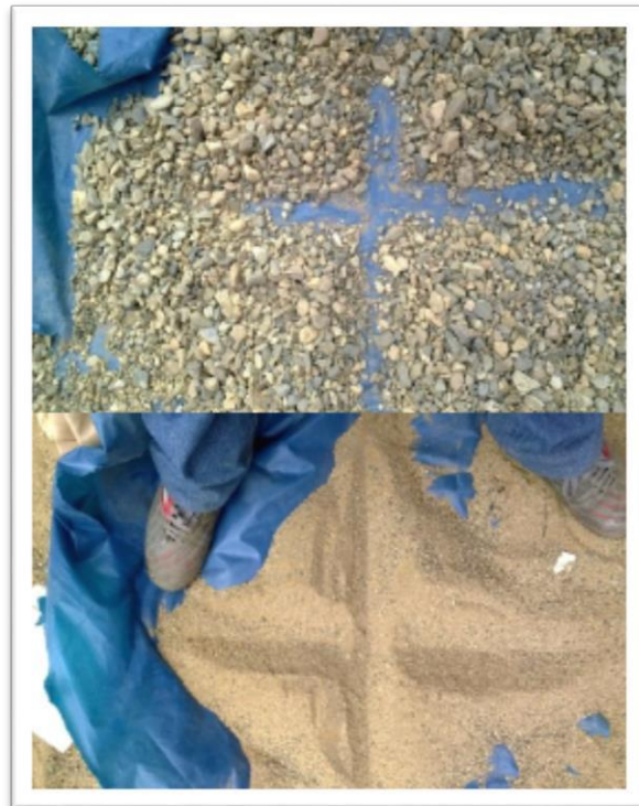
Figura N° 2: en la siguiente figura se observa el agregado utilizado para el proceso de fabricación de la muestra. Arena del Cumbaza y piedra chancada del Huallaga.
