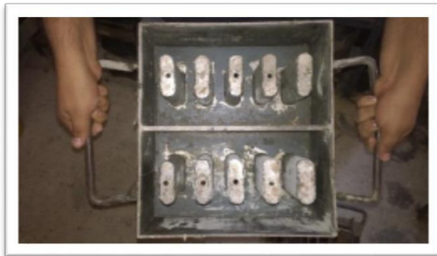
Figura N° 5: En la Figura se observa el molde hecho de acero para la fabricación de los especímenes.
