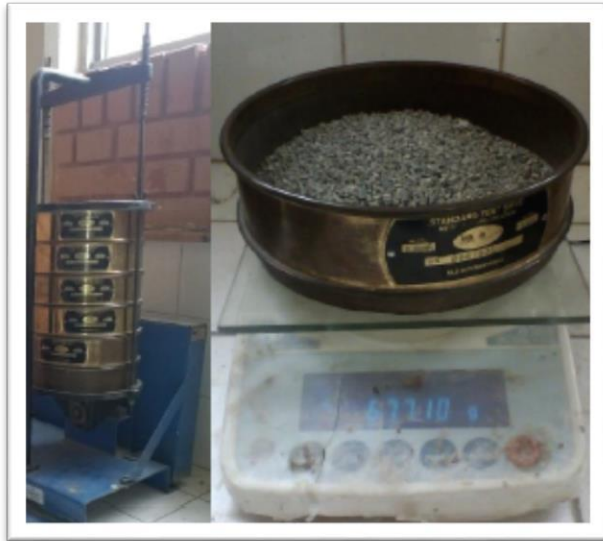
Figura N° 3: En la figura se observa el proceso de tamizado del material de piedra chancada y la toma de muestra en seco.
