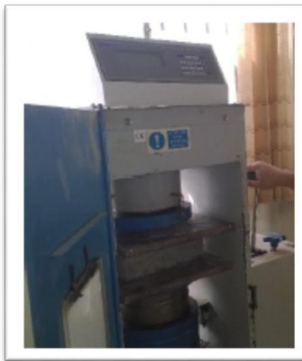
Figura N° 8: En la figura se puede observar el proceso de compresión axial a una unidad de ladrillo.
