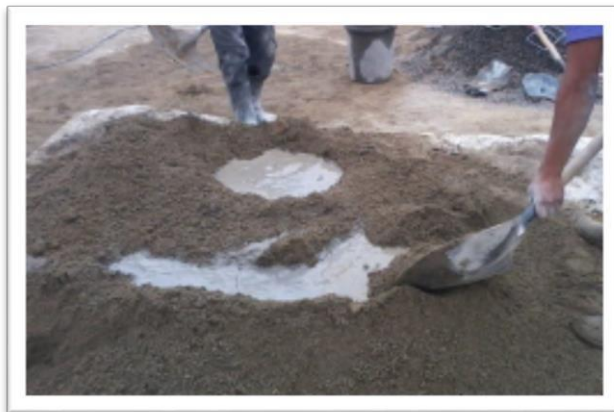
Figura N° 4: En la figura se muestra el proceso de mezclado de los agregados para la fabricación de los especímenes.
