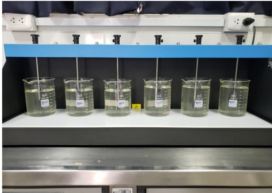
Imagen 8: Realizando la prueba de jarras con su la respectiva cantidad de los coagulantes empleados.
