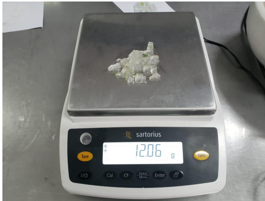
Imagen 6: Pesaje del coagulante Aloe Vera con las cantidades designadas por el investigador.
