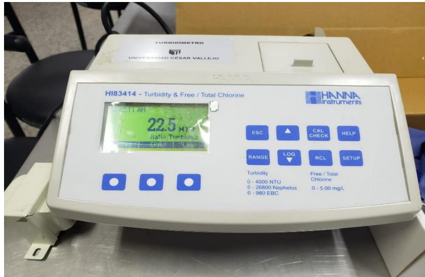
Imagen 12: Determinación de la turbiedad con los resultados obtenidos de la prueba de jarras con los coagulantes aplicados.
