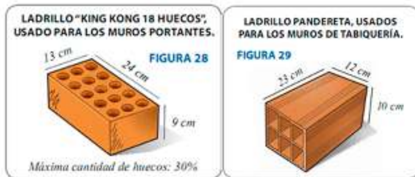
Figura 2. Tipos de unidad de albañilería.
