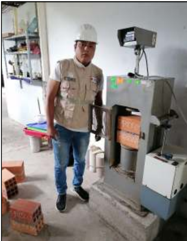
Foto 10: Resistencia a la compresión de prismas de ladrillo con 10% de silicato cálcico reciclado.
