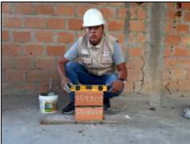
Foto 8: Codificación de las pilas de ladrillos de arcilla.
