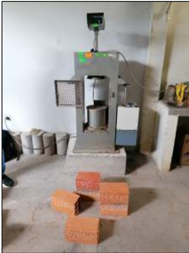
Foto 9: Verificación de los ladrillos para el ensayo de la resistencia a la compresión.
