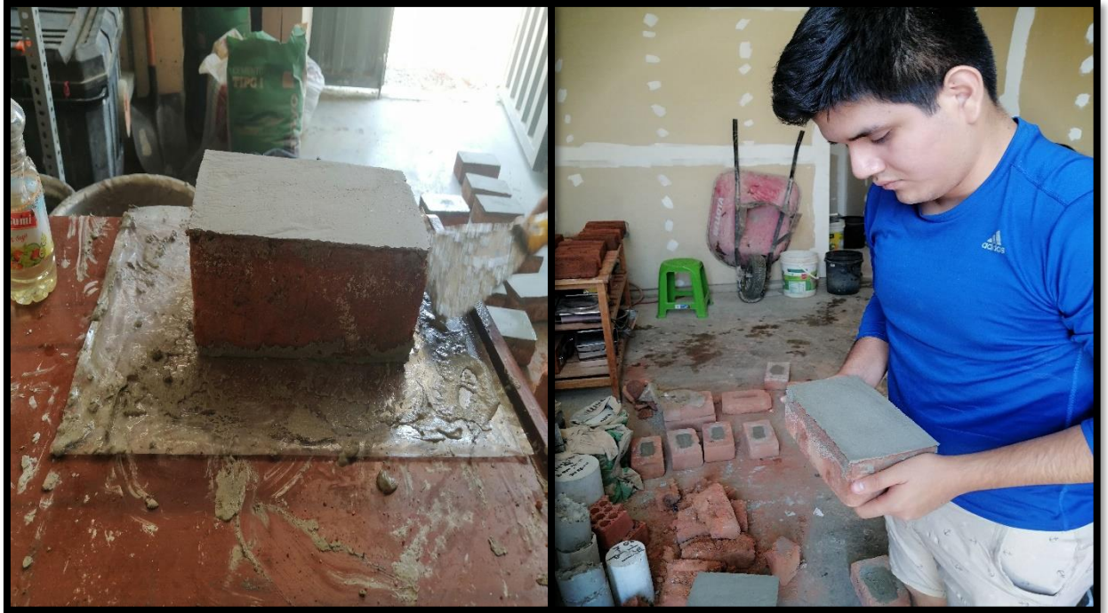
FOTO N°18: Se observa que el ladrillo contiene la superficie en ambas caras
