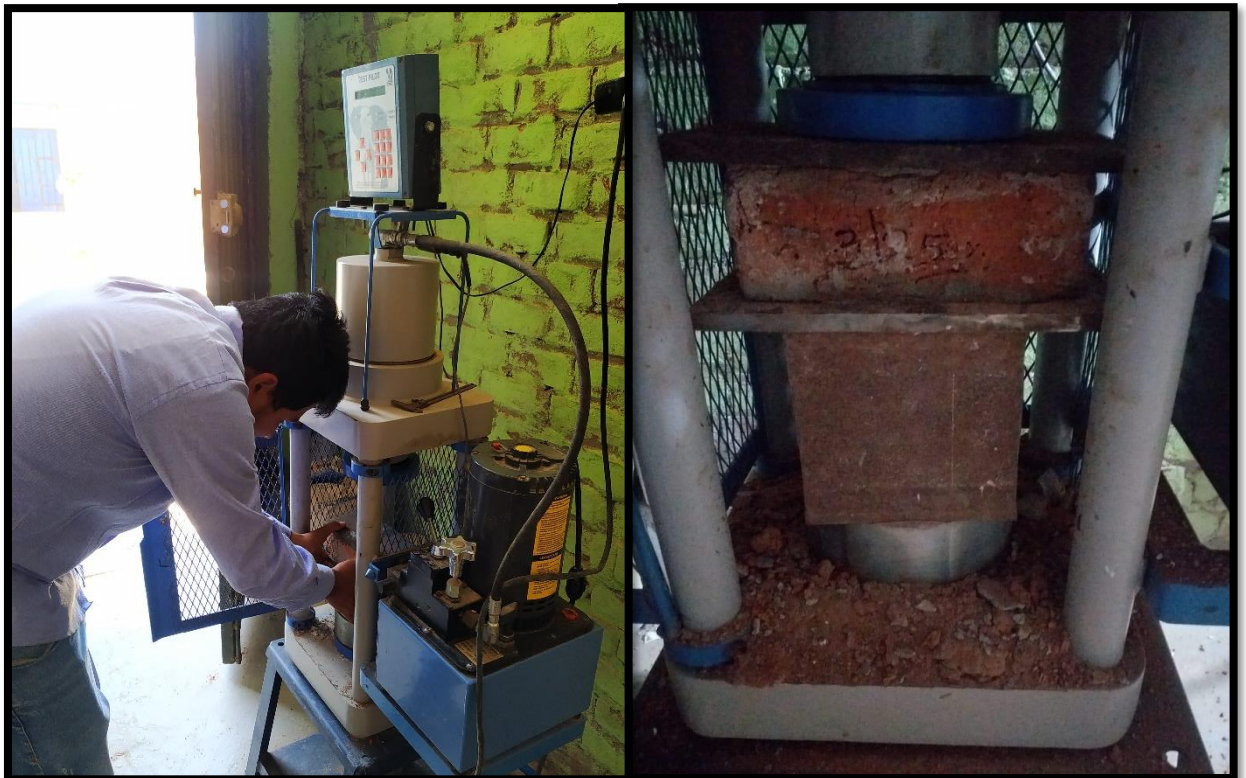
FOTO N°19: Como se observa en la foto se hace el ensayo de compresión las cuales solo el ladrillo con 15% PET despunta como el mejor tipo ladrillo dentro de los 4 tipos de ladrillo propuestos.
