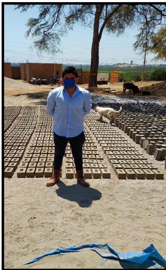
FOTO N°07: Se observa al tesista Avilés en el proceso del secado, posteriormente los ladrillos serán llevados a los hornos para su cocción.
