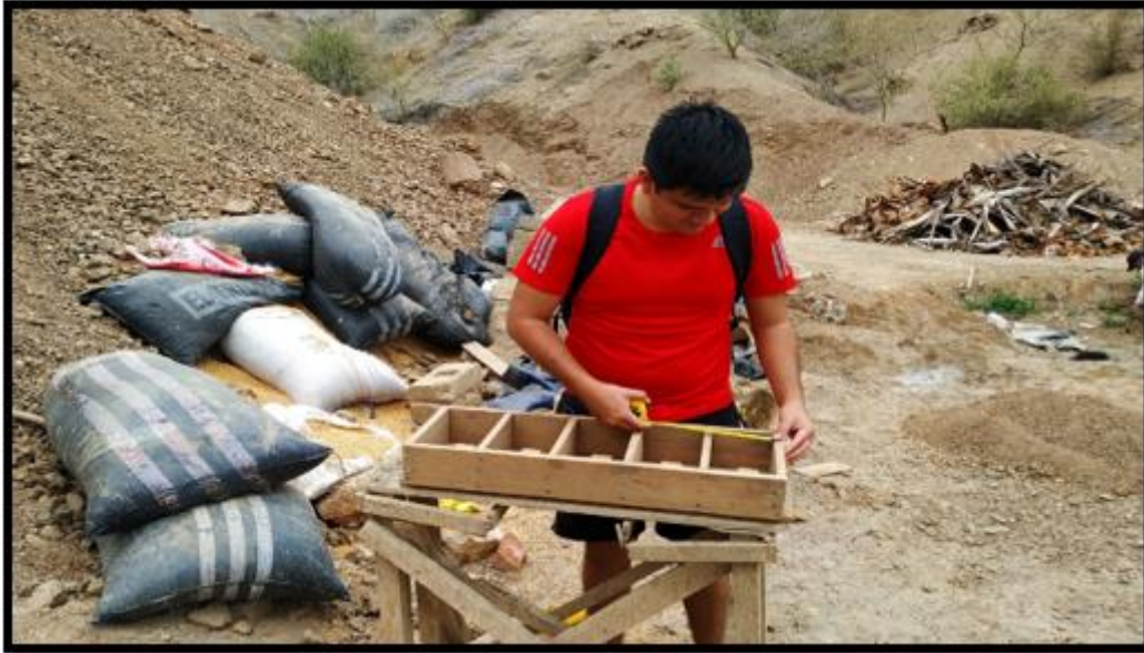
FOTO N°05: Se observa al tesista Avilés tomando las dimensiones del molde de dimensiones 22x12x9.5(cm)
