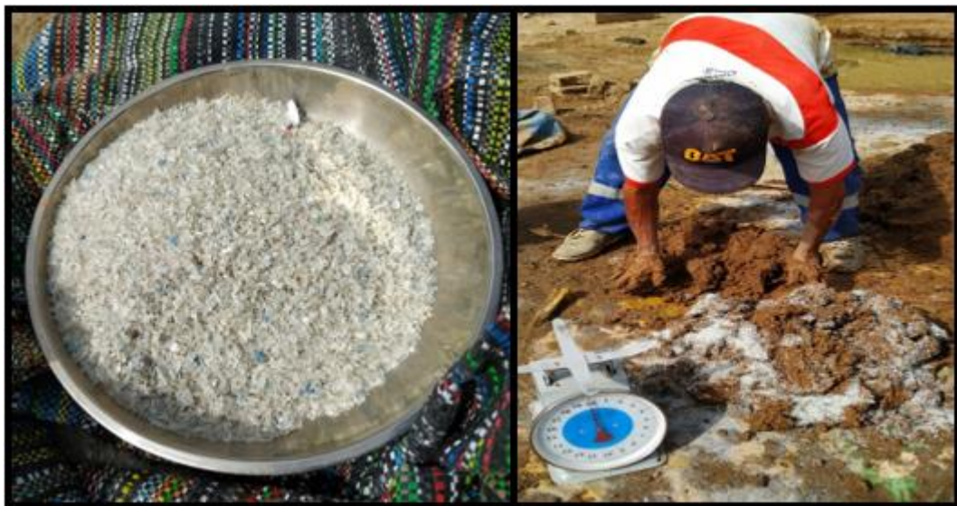
FOTO N°04: Se observa el material triturado escamas de PET y con la ayuda del señor encargado de dicha cantera amasando la mezcla previa al moldeo.
