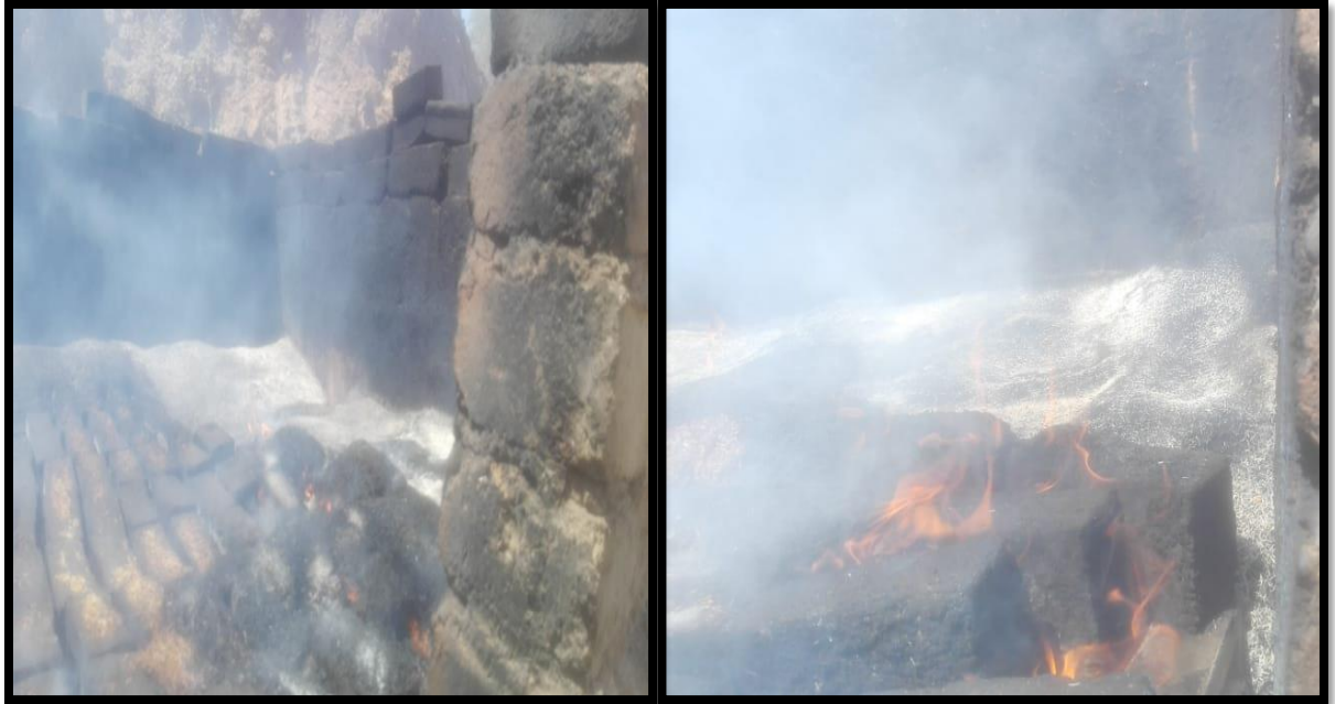
FOTO N°10: Como se observa en la figura tenemos el quemado de los ladrillos en el horno el tiempo de quemado son entre 10 a 14 días y el tiempo de enfriamiento es de 4 días.
