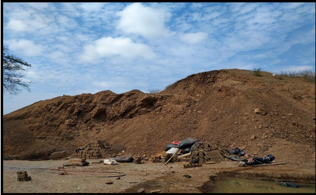
FOTO N°01: Se observa el material de donde se extraerá para la elaboración de los ladrillos, en la mezcla emplean la arcilla, agua y la ceniza con el fin de disminuir la plasticidad.
