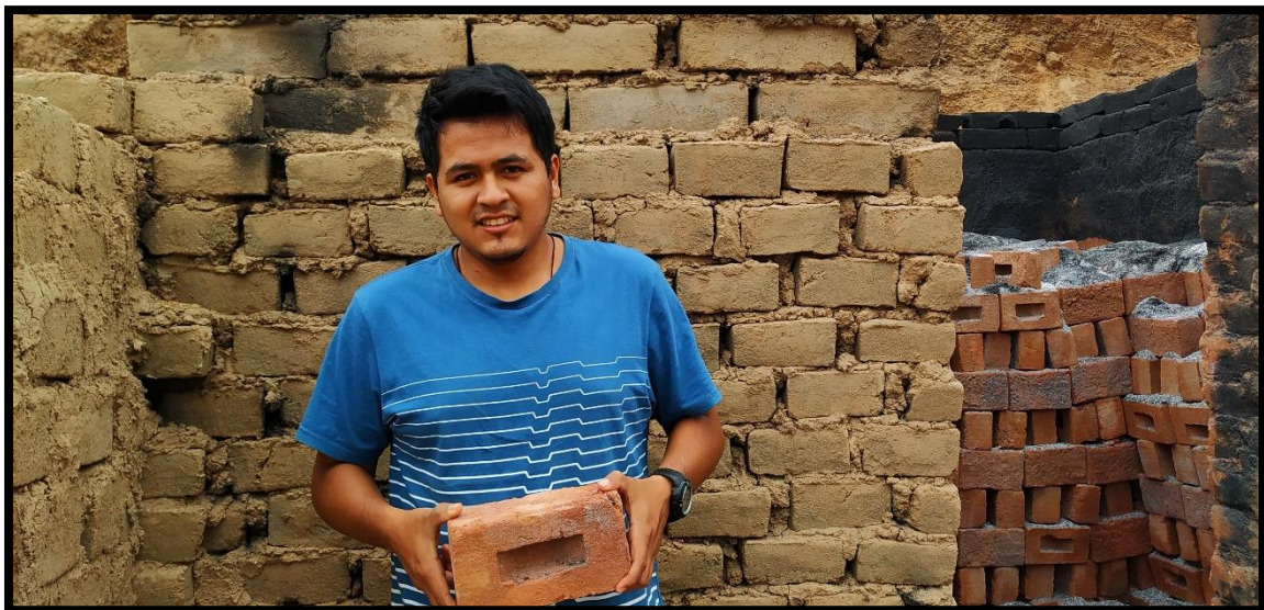
FOTO N°11: Como se observa al tesista Carrasco en la conclusión del periodo del quemado, los ladrillos con porcentaje de 15% y 25% se salieron en un buen estado a la comparación del ladrillo al 50%.
