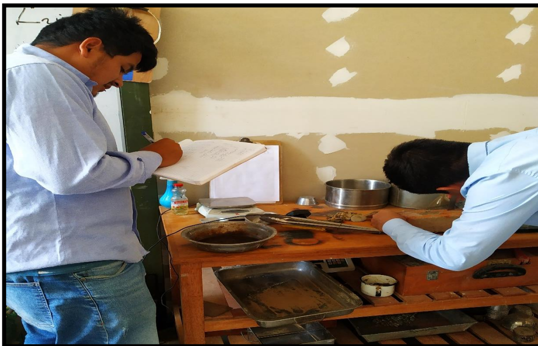
FOTO N°14: En esta fotografía se observa a los tesistas realizando el ensayo de Alabeo donde consiste en identificar si este posee incongruencias como curvaturas, ya sean cóncavas o convexas.
