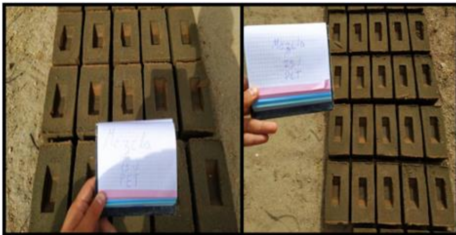
FOTO N°06: Se observa que las muestras se colocan a la intemperie para su secado durante 7 días, aprovechando la energía natural que el sol brinda, para lograr un secado uniforme.
