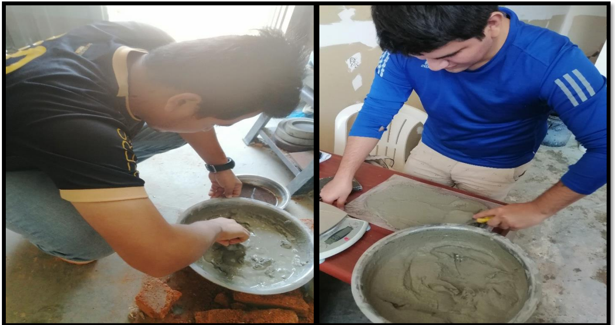
FOTO N°17: Como se observa los tesistas Avilés y Carrasco elaborando la mezcla de cemento, yeso y agua colocando una superficie en ambas capas para llevar a cabo el ensayo de compresión.
