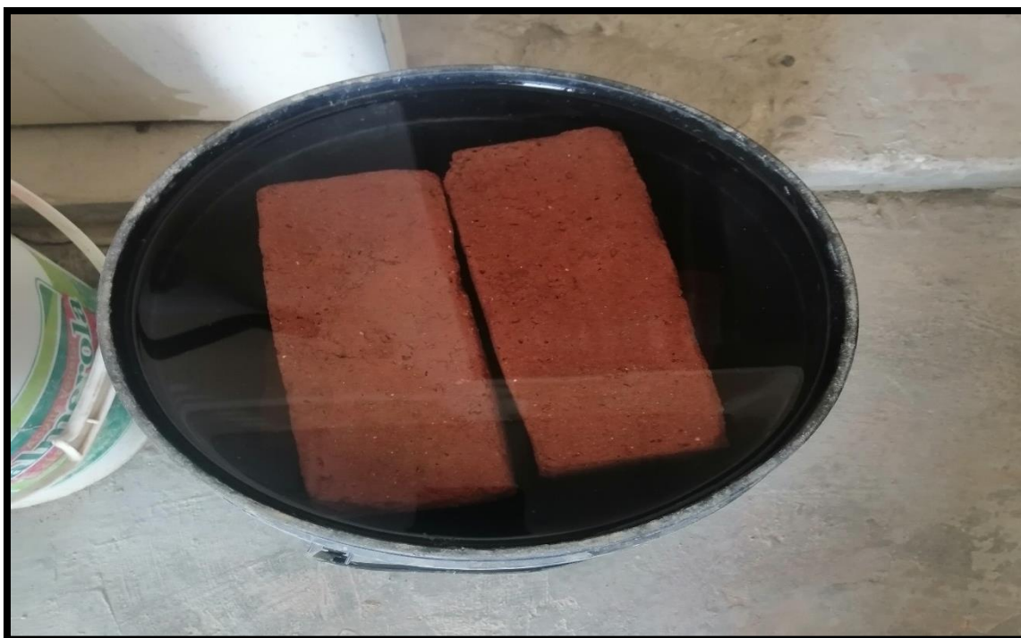
FOTO N°15: Se muestra los ladrillos artesanales con plástico triturado sumergidos en agua para determinar el ensayo de absorción, así como el ensayo de compresión.
