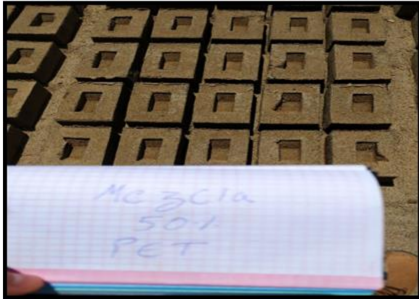
FOTON°06: Se observa la mezcla al 50% de material PET a la intemperie para su secado.
