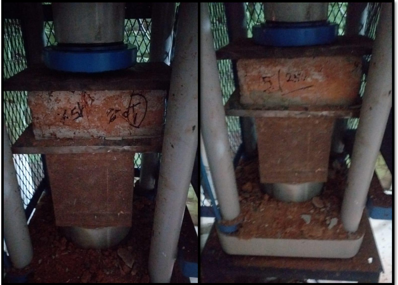
FOTO N°20: Como se observa se realiza el ensayo a la compresión con las muestras del 15% y 25%.
