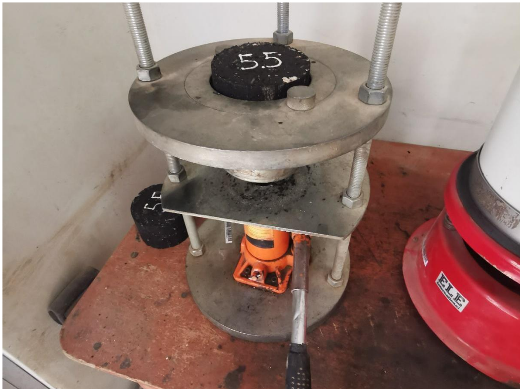
Figura 26. Proceso de desmoldado de briquetas.
