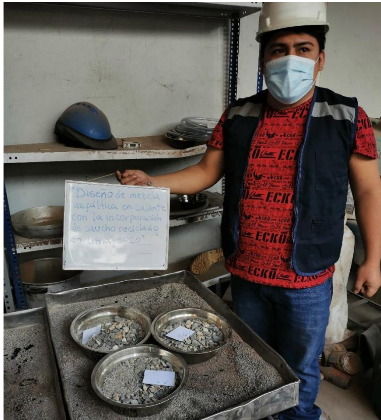
Figura 13. Calentamiento en 150°C de los agregados
