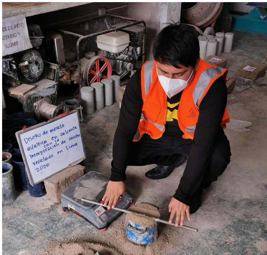
Figura 2. Rasante arena gruesa sin compactar
