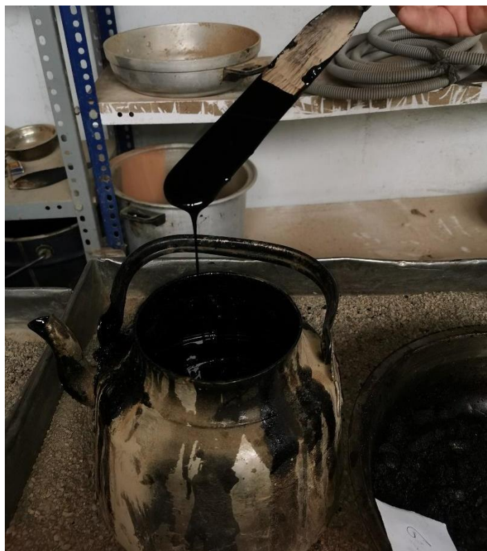
Figura 22. Cemento asfáltico PEN 60/70 mezclado con el 1.5 % de Caucho reciclado triturado.
