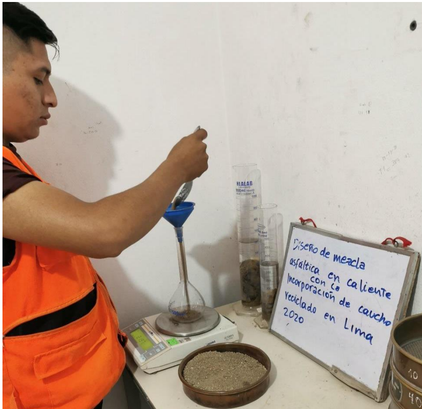
Figura 11. Peso específico arena gruesa
