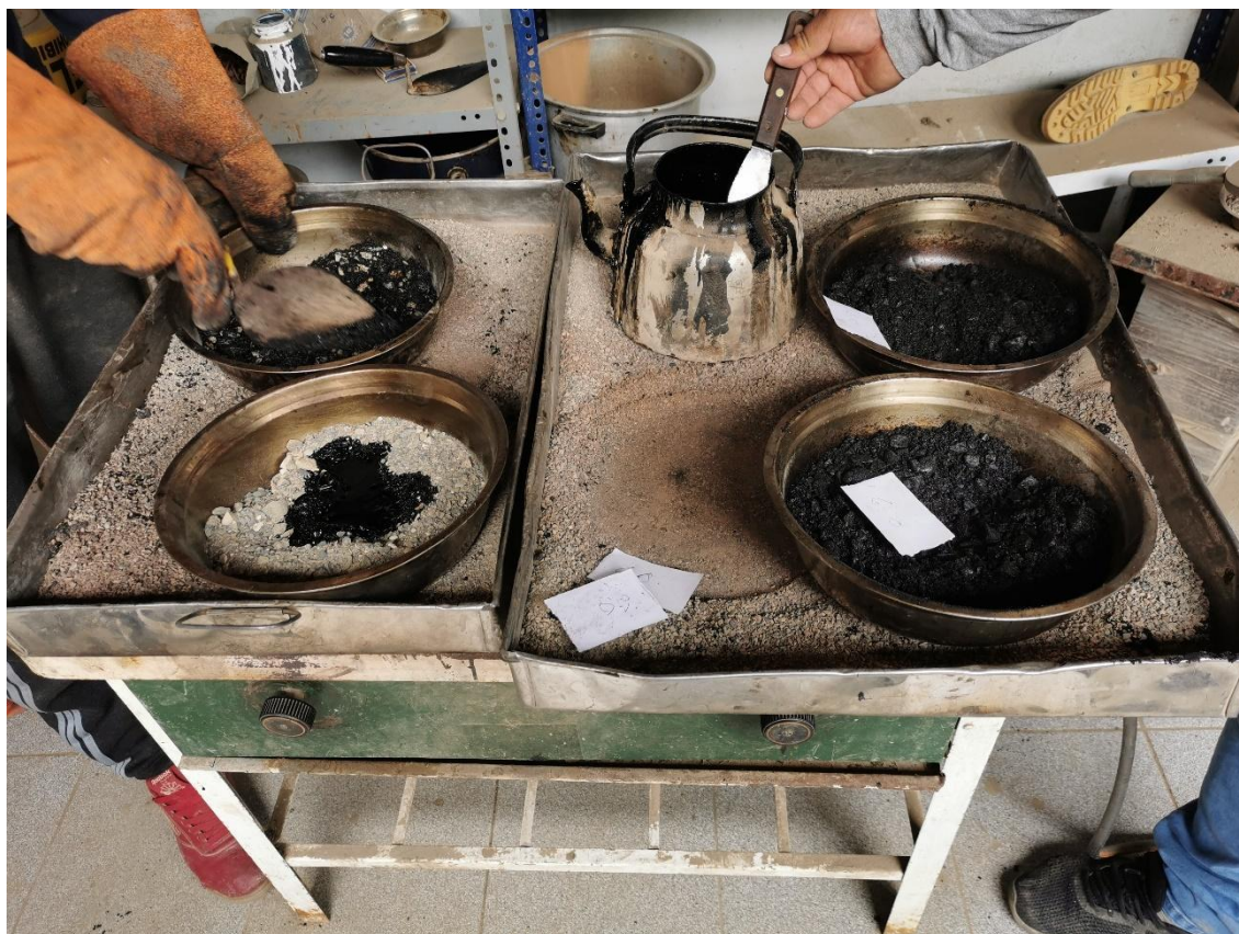
Figura 21. Calentamiento y mezclado de cemento asfáltico PEN 60/70 incorporando caucho reciclado.
