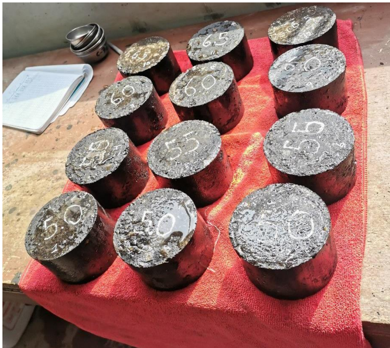
Figura 28. Proceso de desmoldado de briquetas.
