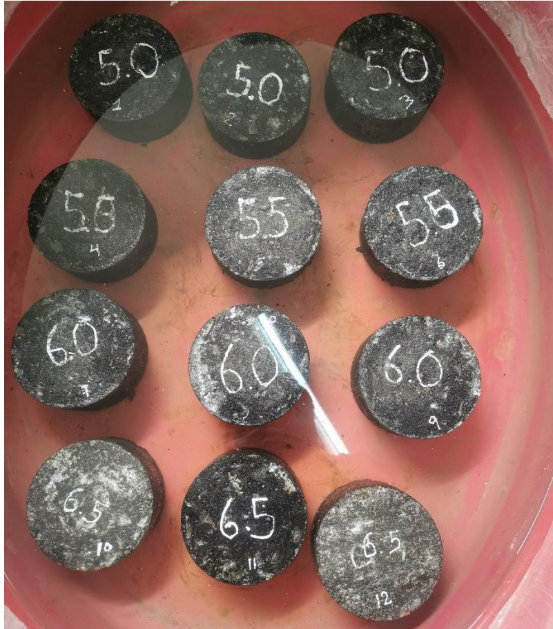
Figura 27. Briquetas con 5% 5.5% 6% y 6.5% de cemento asfáltico incorporando el 1.5 % de caucho reciclado en todas las muestras.
