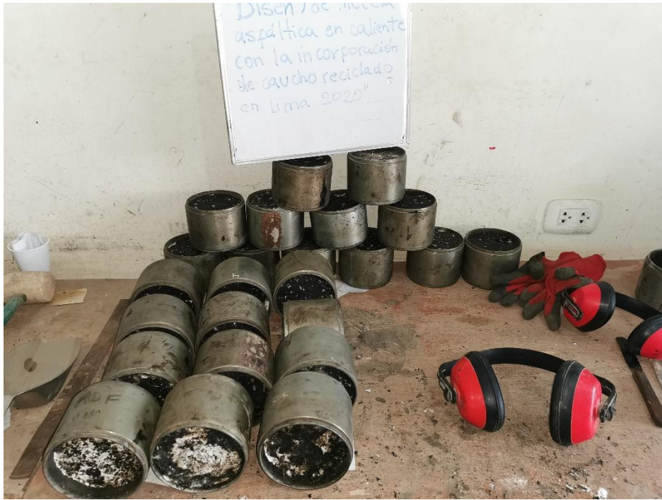
Figura 25. Proceso de reposo de las 24 briquetas
