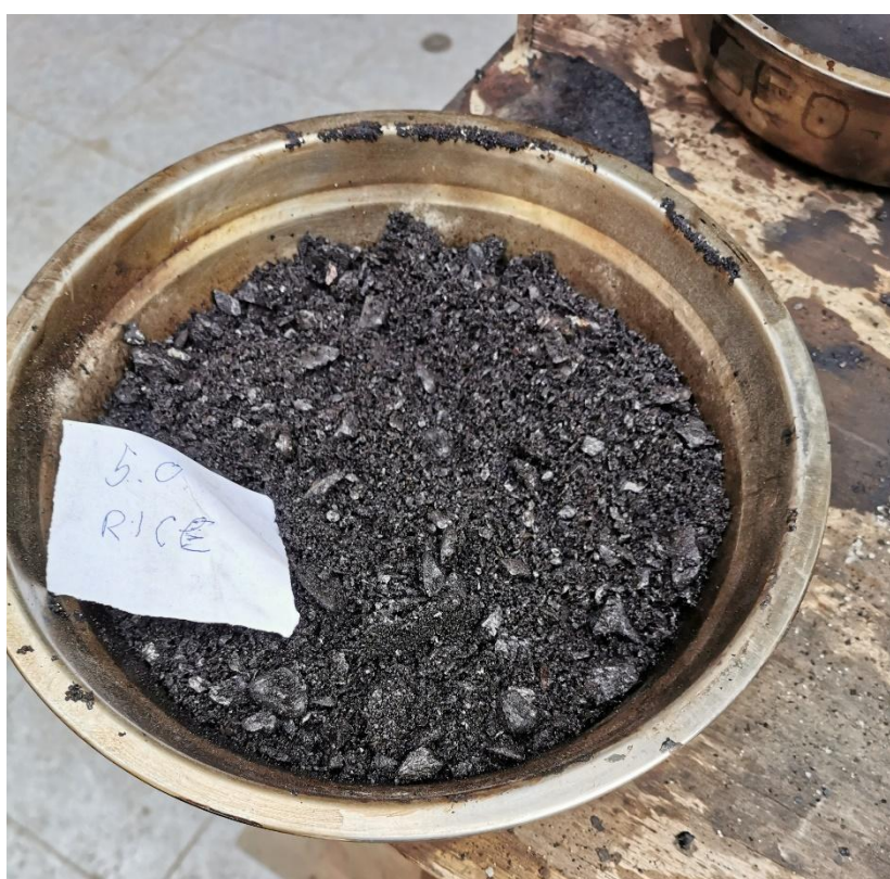
Figura 17. Muestra rice 5% y 5.5% de cemento asfaltico PEN 60/70
