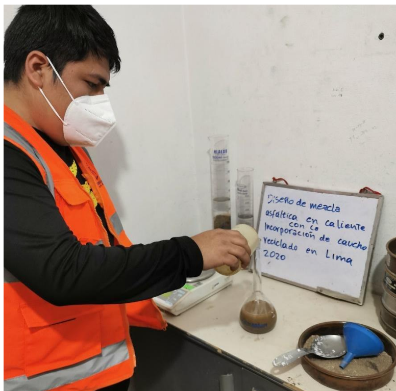
Figura 12. Peso específico arena gruesa
