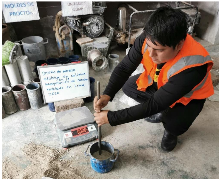
Figura 4. Arena gruesa compactado 25 golpes en 3 capas.
