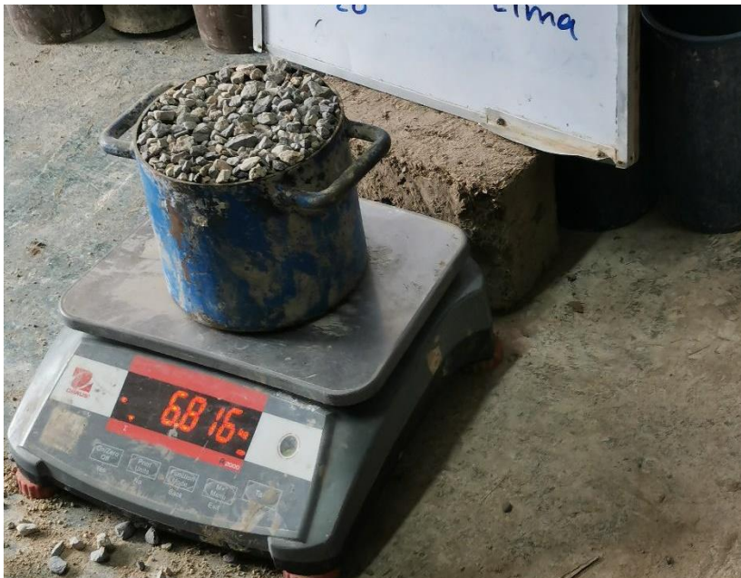
Figura 6. Pesaje correspondiente compactado y sin compactar.
