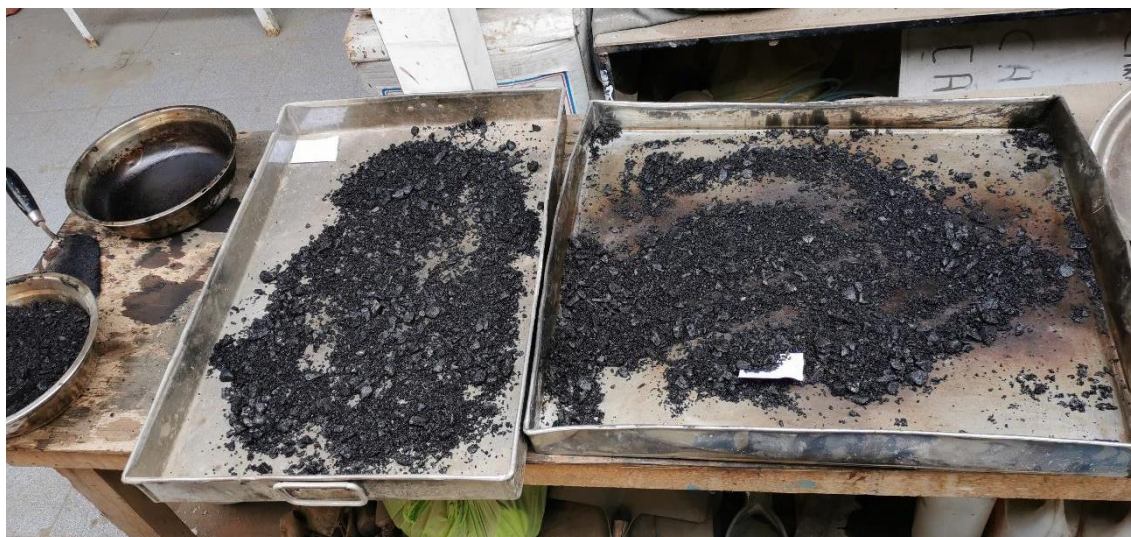
Figura 17. Muestra rice 5% y 5.5% de cemento asfaltico PEN 60/70
