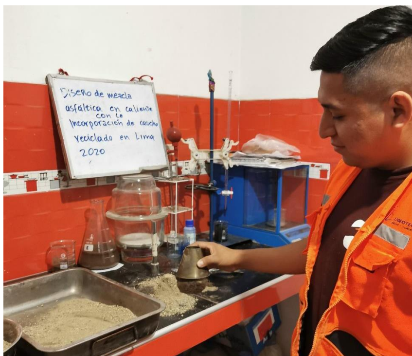
Figura 10. Pesaje correspondiente compactado y sin compactar.
