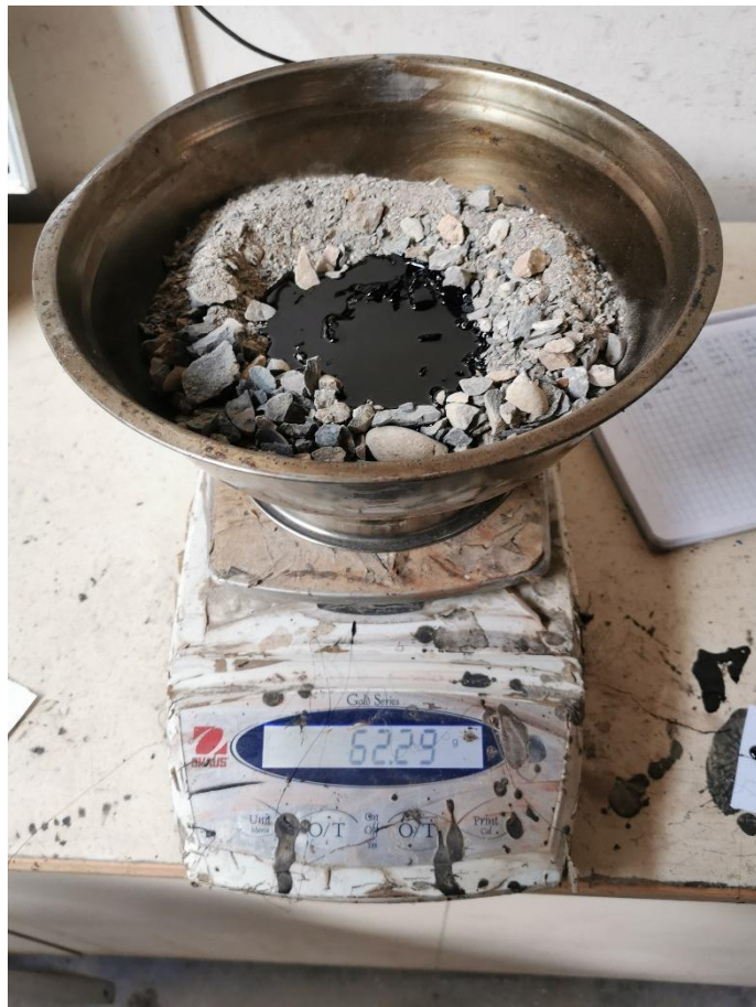
Figura 16. Aplicando cemento asfaltico PEN 60/70
