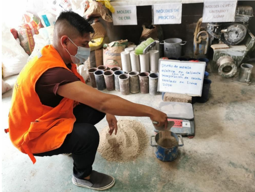
Figura 1. caída libre arena gruesa sin compactar.
