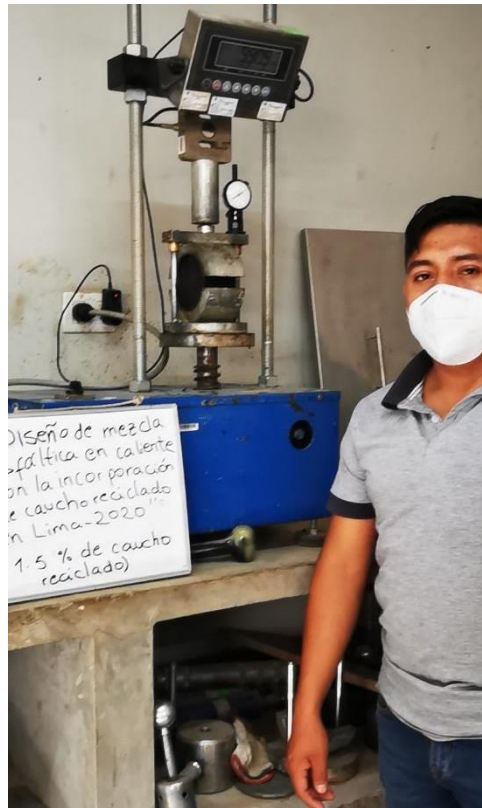
Figura 29. Rotura de briquetas con la prensa Marshall.
