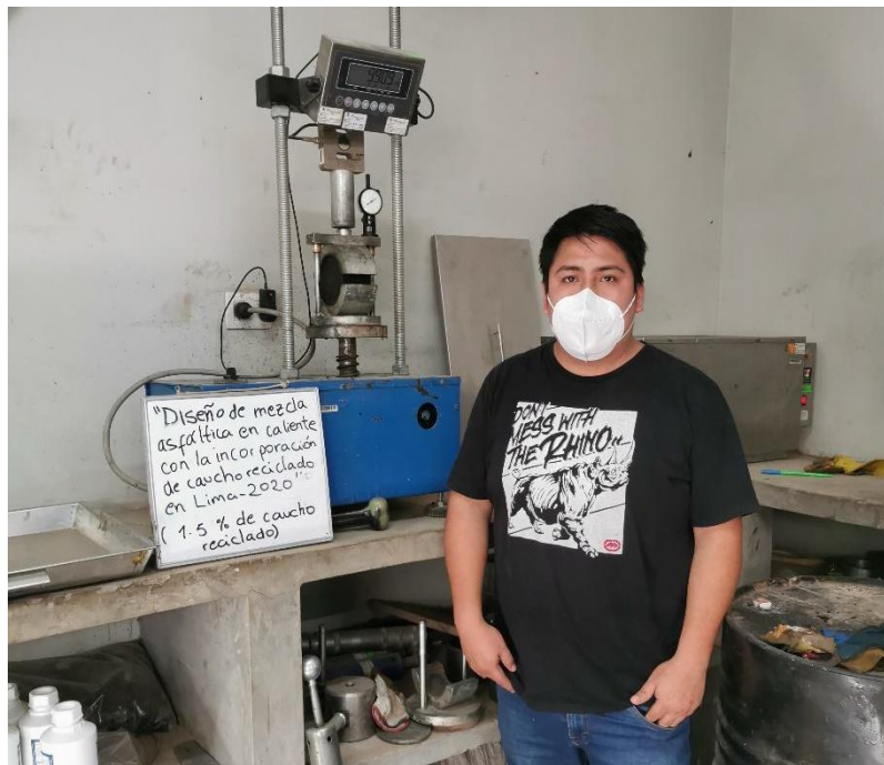
Figura 30. Rotura de briquetas con la prensa Marshall, lectura de flujo y estabilidad.
