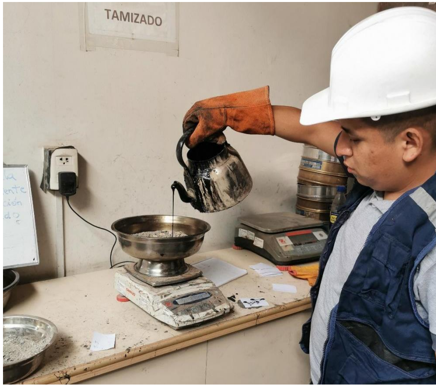
Figura 15. Aplicando cemento asfaltico PEN 60/70
