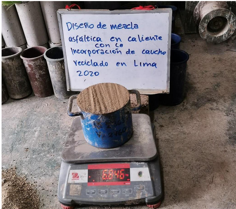
Figura 3. Rasante arena gruesa sin compactar
