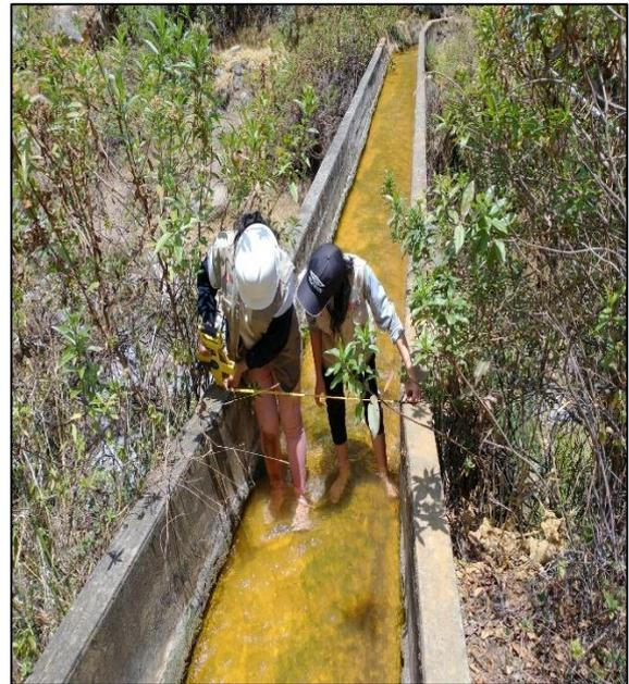
Figura 20 y 21: Se midieron las secciones transversales del canal desde la progresiva 0+000 a 6+440
