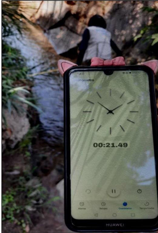
Figura 22: Se realizó el aforo por el método de flotadores en la progresiva 0+050 a 0+060 y en la 6+430 a 6+440.
