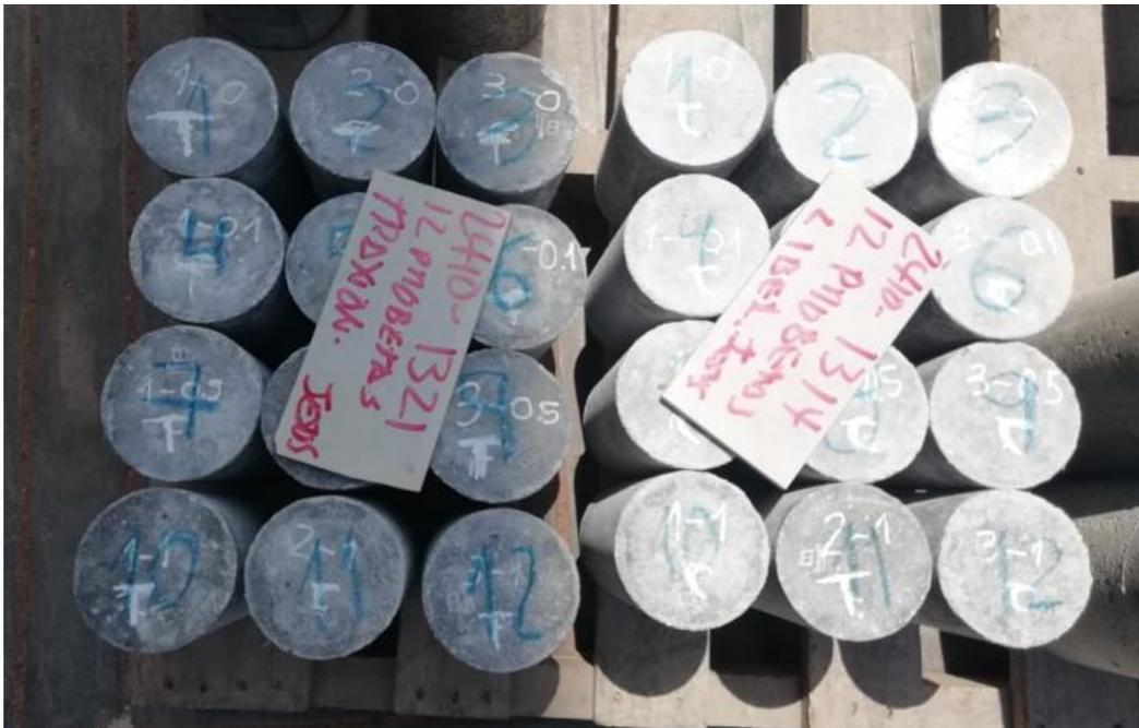
Figura 34. Muestras de probetas en el LEM-UNI para el ensayo de resistencia a la compresión y tracción
