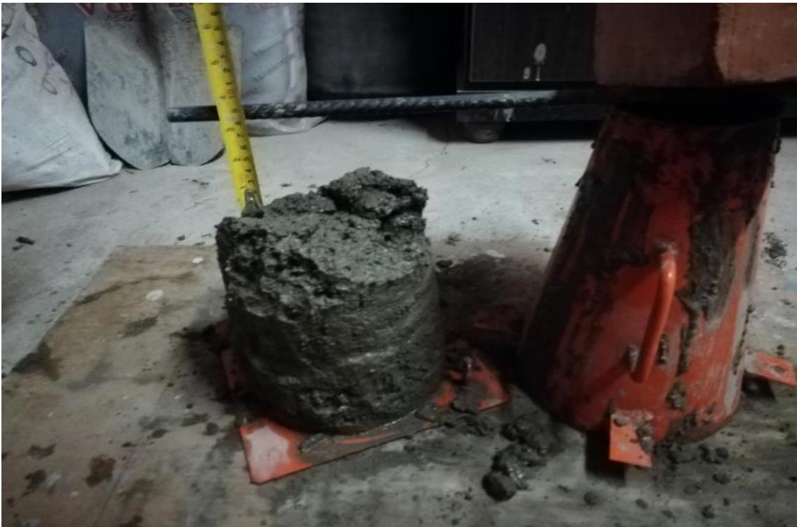
Figura 26. Slump de 3.5" para el tercer volumen unitario de agua prueba, 220 l/m<sup>3</sup>.
