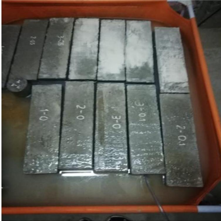
Figura 33. Presencia de eflorescencias durante el curado de las muestras
