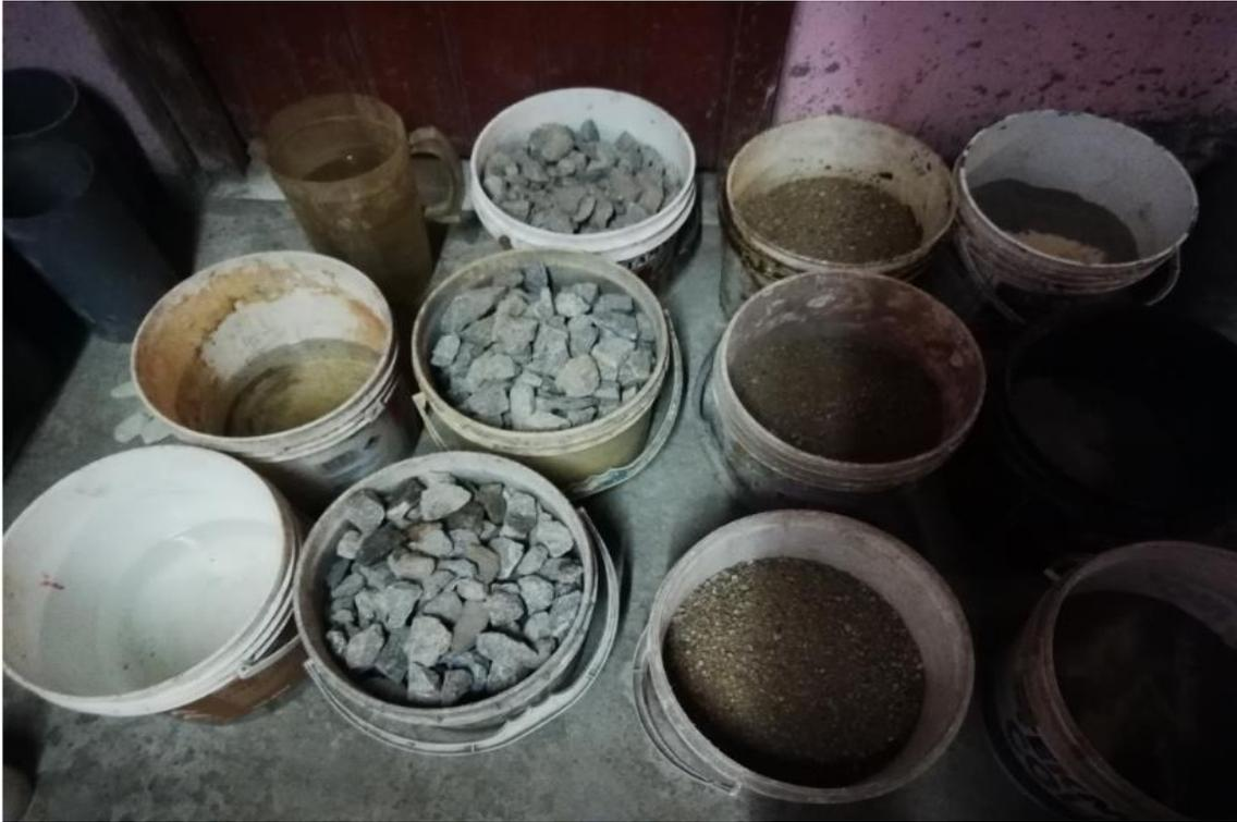
*Figura 29.* Cantidad de materiales para la fabricación de 9 probetas, con diferentes adiciones de polvo de algas marinas
