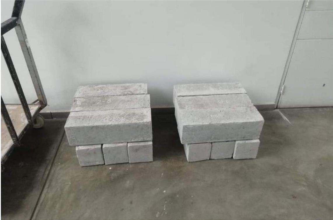
*Figura 35.* Muestras de vigas en el Laboratorio de Materiales de la UCV para el ensayo de resistencia a la flexión.
