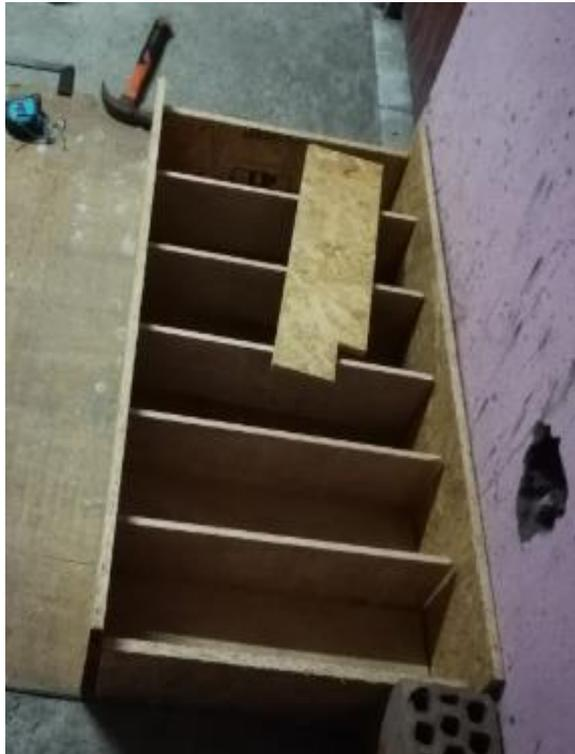
*Figura 24.* Fabricación de molde para vigas de 15x15x50cm
