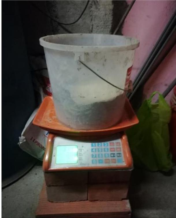
*Figura 27.* Pesaje de la cantidad de cemento para fabricar 3 probetas.
