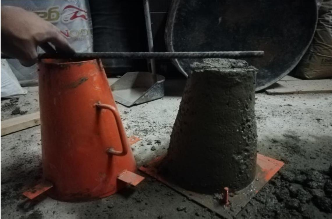
Figura 25. Slump de 1" para el primer volumen unitario de agua prueba, 193 l/m<sup>3</sup>
