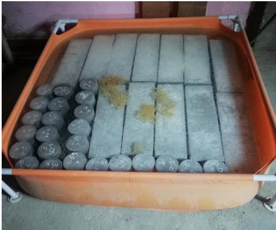
*Figura 32. Curado de las probetas y vigas durante 28 días*
