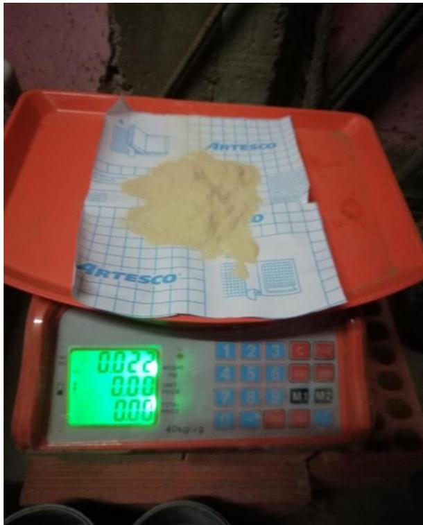
*Figura 28.* Pesaje del polvo de algas marinas para la fabricación de 3 probetas.
