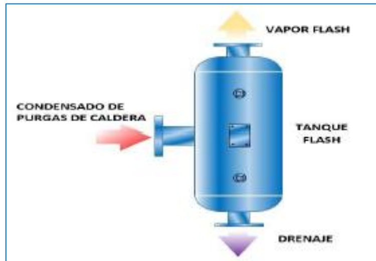
Ilustración 3. Tanque de revaporizado
