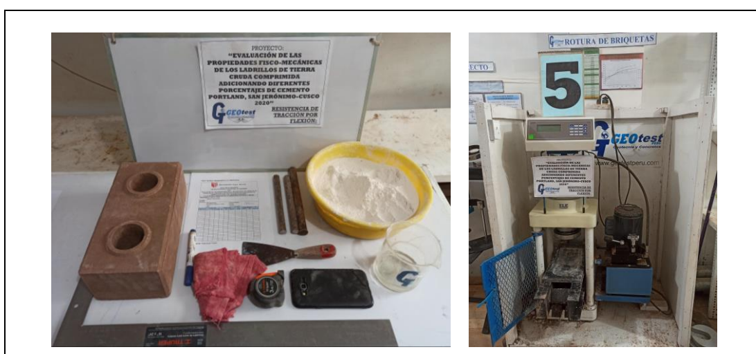
Figura 54. Materiales y equipos empleados en la prueba de resistencia a tracción por flexión
