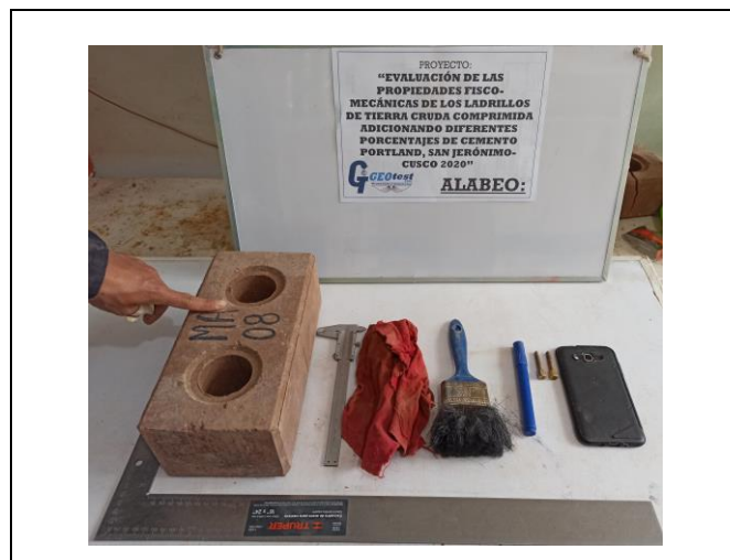
Figura 37. Materiales y equipos empleados en la prueba de alabeo
