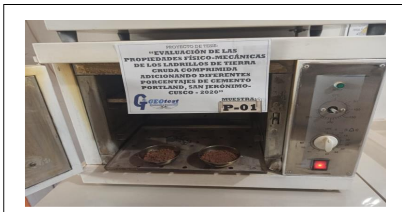
Figura 21. Proceso a seguir de la prueba de contenido de agua
