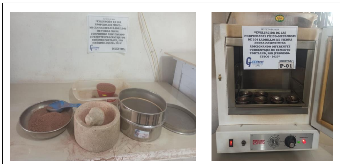
Figura 12. Materiales y equipos empleados en la prueba de límites de Atterberg
