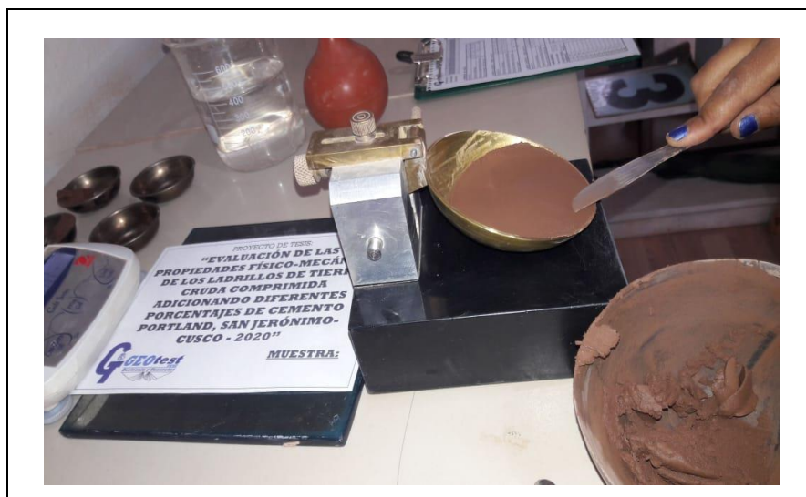
Figura 13. Proceso a seguir de la prueba de límites de Atterberg
