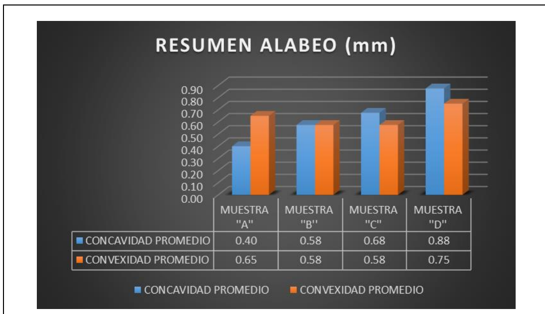
Figura 81. Resumen resultados de la prueba de alabeo
