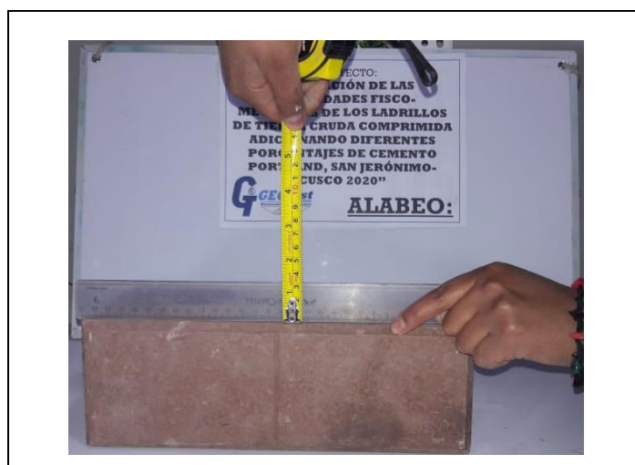
Figura 38. Proceso a seguir de la prueba de alabeo
