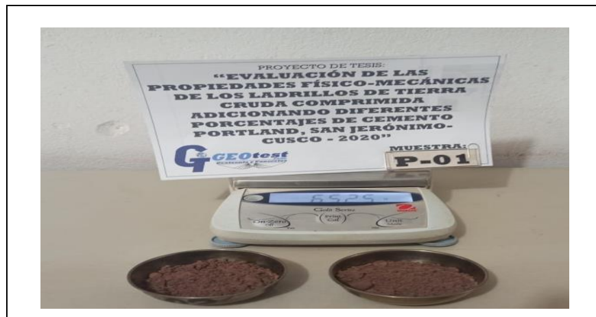
Figura 20. Proceso a seguir de la prueba de contenido de agua
