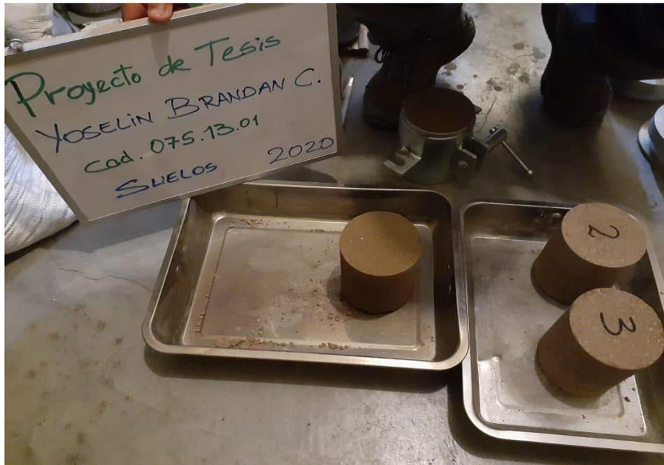
Ensayo de Compresión Uniaxial
