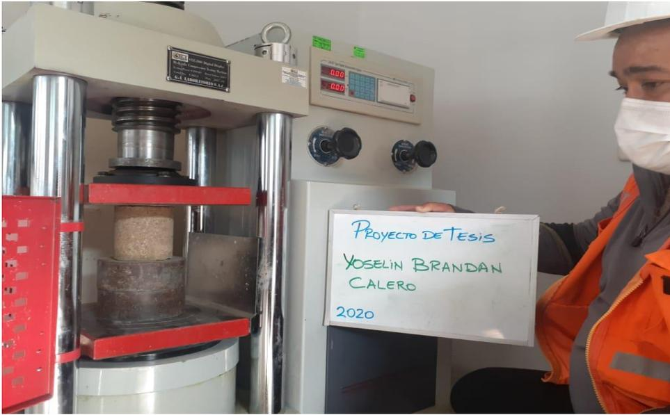
Ensayo de Compresión Uniaxial de Suelos
