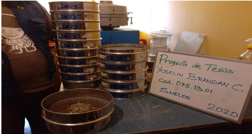
Ensayo de Granulometría por tamizado
