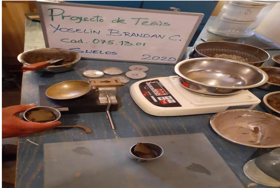
Ensayo de Limite de consistencia
