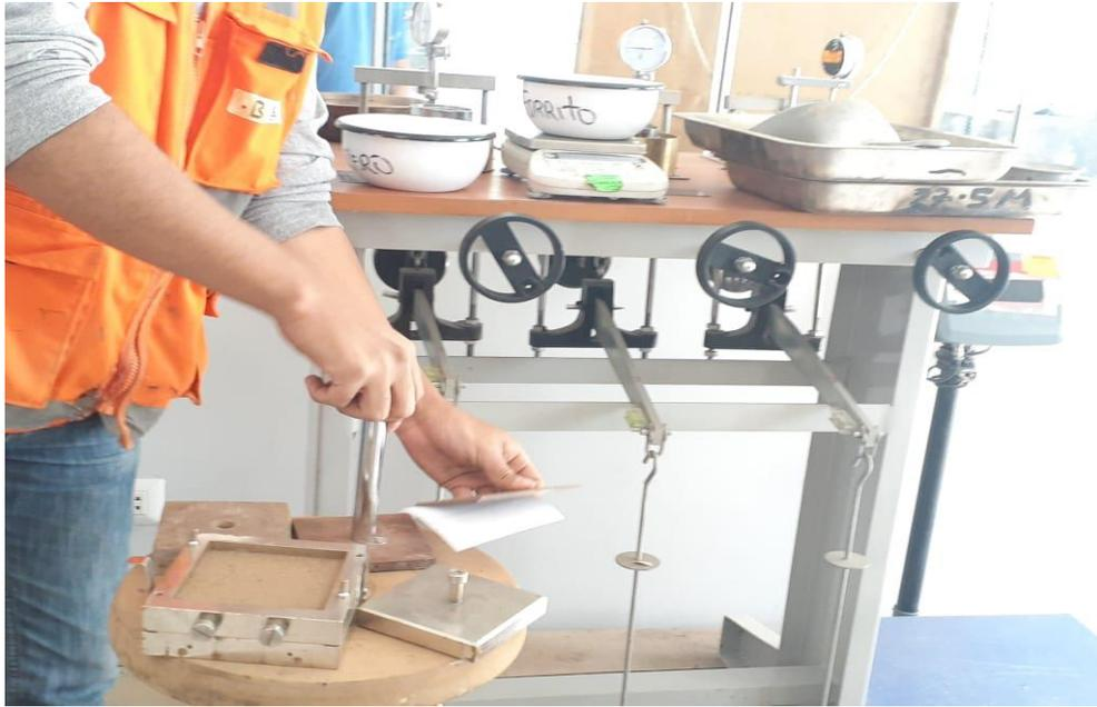
Moldeo de Ensayo de Corte Directo
