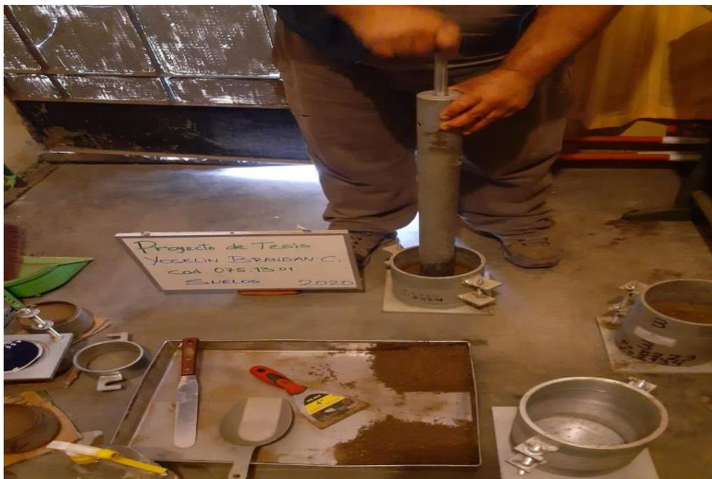
Ensayo de Próctor Modificado
