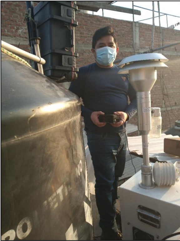
Gráfico 19: Validación de prototipo con equipo profesional muestreador Bravo Plus
