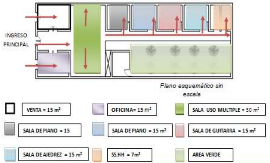
Fig. 03: Plano indicando la zonificación de la infraestructura.
