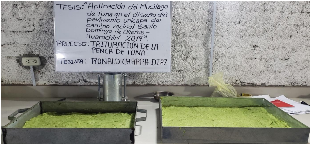
Foto N°26. Después de haber sido triturado la penca de tuna en la licuadora, se obtuvo una sustancia viscosa - espesa, luego se procedió a colarlo en una manta de tal forma que se retengan las partículas de la muestra y se elimine el agua, tal y como se aprecia en la foto. Fuente: Elaboración propia.
