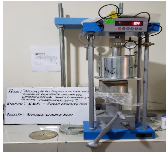
Foto N°16. Ensayo en prensa CBR suelo natural con cemento portland 12% (ASTM D1883) Fuente: Elaboración propia.
