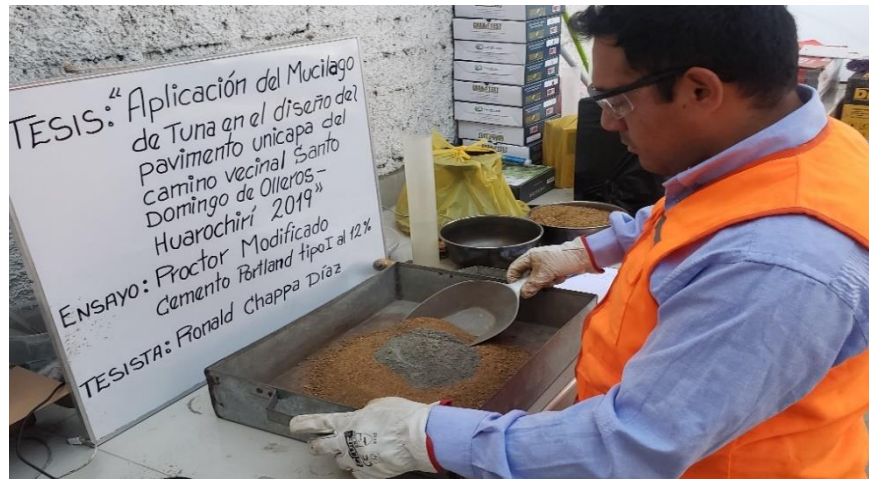
Foto N°12. Ensayo Proctor Modificado suelo natural con cemento portland 12% Fuente: Elaboración propia.
