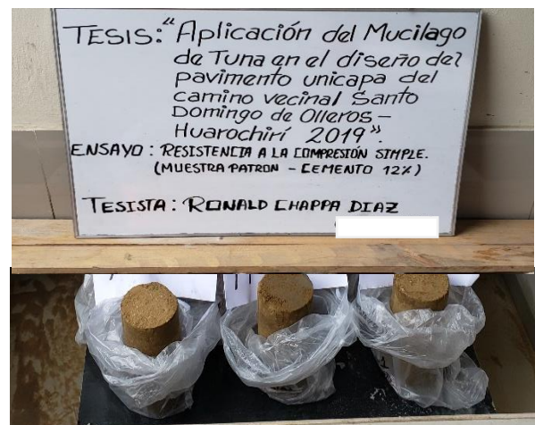
Foto N°18. Ensayo Resistencia a la Compresión Simple suelo natural con cemento portland 12% (especímenes – muestra patrón) (MTC E 1103) Fuente: Elaboración propia.
