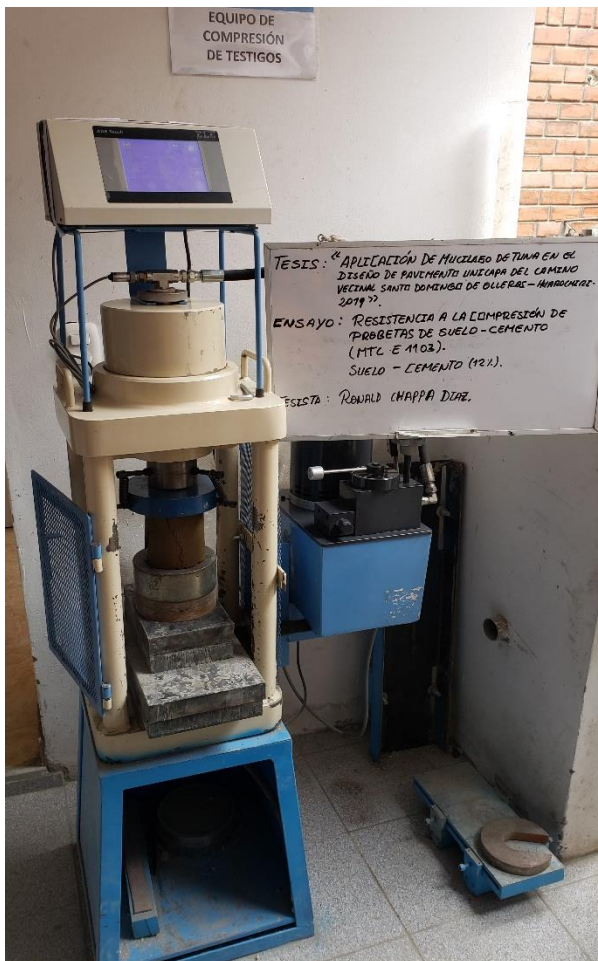
Foto N°48. Ensayo Resistencia a la Compresión Simple suelo natural con cemento portland 12% - prensa hidráulica (MTC E 1103) Fuente: Elaboración propia.
