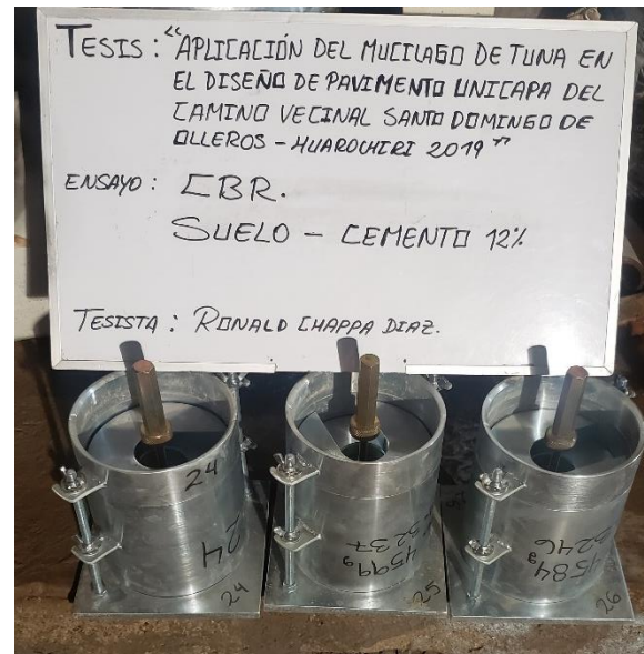
Foto N°14. Ensayo CBR suelo natural con cemento portland 12% Fuente: Elaboración propia.
