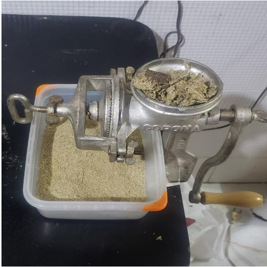
Foto N° 30. Proceso de molienda para obtener Mucílago de tuna en polvo. Para ello se usó un moledor casero. Fuente: Elaboración propia
