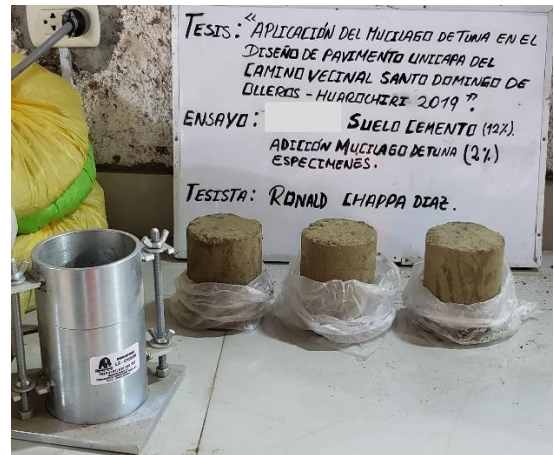
Foto N°44. Ensayo Resistencia a la Compresión Simple suelo natural con cemento portland 12% + adición de Mucílago de Tuna 2% (elaboración de especímenes) (MTC E 1103)
