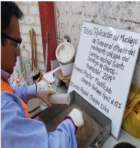
Foto N°13. Ensayo Proctor Modificado suelo natural con cemento portland 12% Fuente: Elaboración propia.
