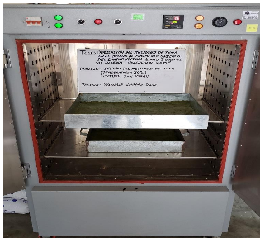
Foto N°27. Proceso de secado en el horno de laboratorio del Mucilago de tuna a una temperatura de 80°C, por un lapso de tiempo de 4 horas.
