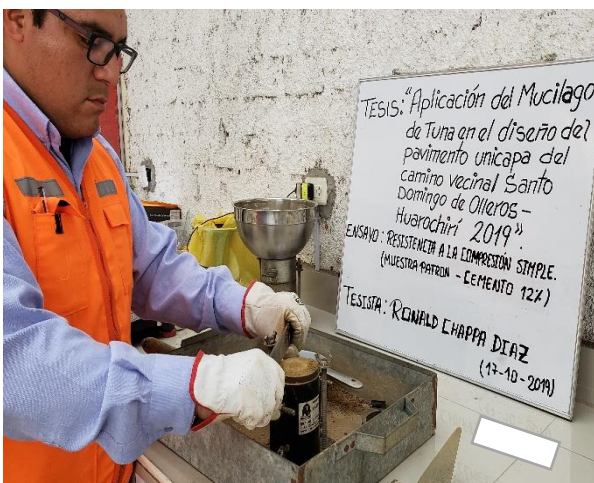
Foto N°17. Ensayo Resistencia a la Compresión Simple suelo natural con cemento portland 12% (elaboración de especímenes) (MTC E 1103) Fuente: Elaboración propia.
