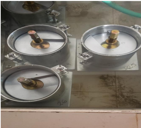
Foto N°15. Ensayo CBR suelo natural con cemento portland 12% sumergido en una poza. Fuente: Elaboración propia.
