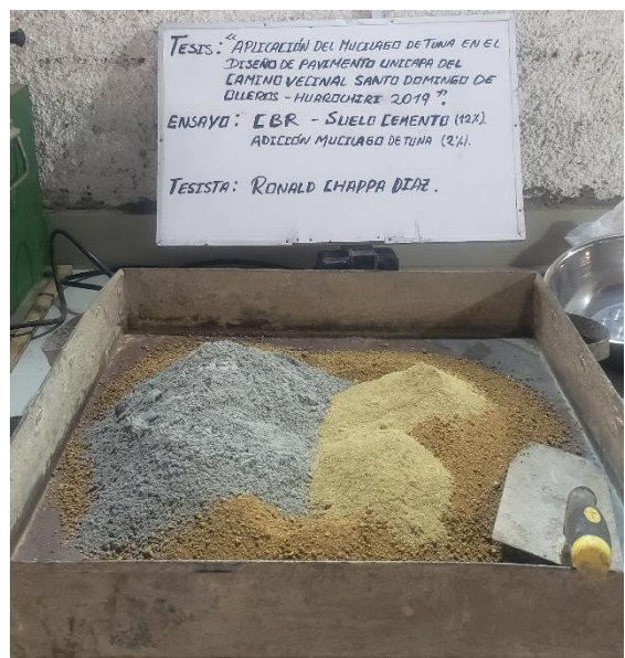
Foto N°36. Ensayo CBR - suelo natural con cemento portland 12% + adición de Mucilago de Tuna 2% Fuente: Elaboración propia.
