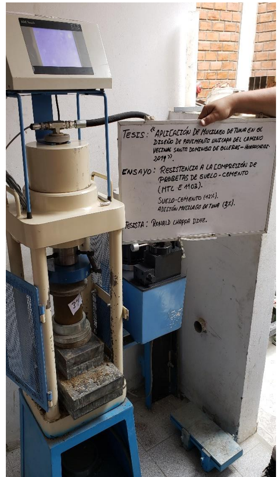
Foto N°51. Ensayo Resistencia a la Compresión Simple suelo natural con cemento portland 12% + adición de Mucílago de Tuna 3% - prensa hidráulica (MTC E 1103) Fuente: Elaboración propia.
