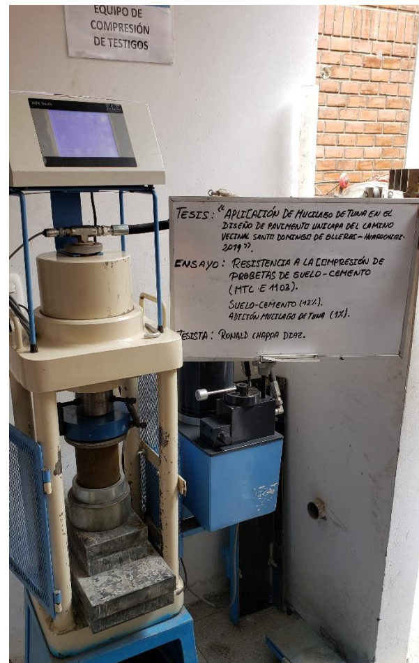
Foto N°49. Ensayo Resistencia a la Compresión Simple suelo natural con cemento portland 12% + adición de Mucílago de Tuna 1% - prensa hidráulica (MTC E 1103) Fuente: Elaboración propia.
