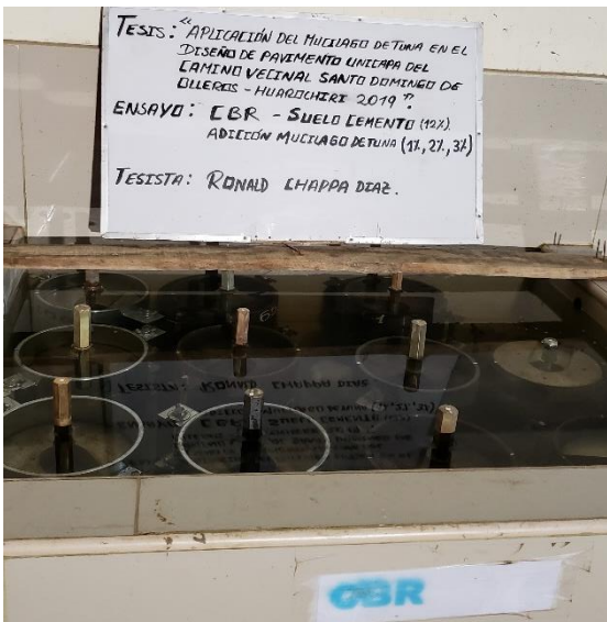
Foto N°39. Ensayo CBR – compactación en los moldes y sumergidos. Suelo natural con cemento portland 12% + adición de Mucilago de Tuna (1%, 2%, 3%). Fuente: Elaboración propia.
