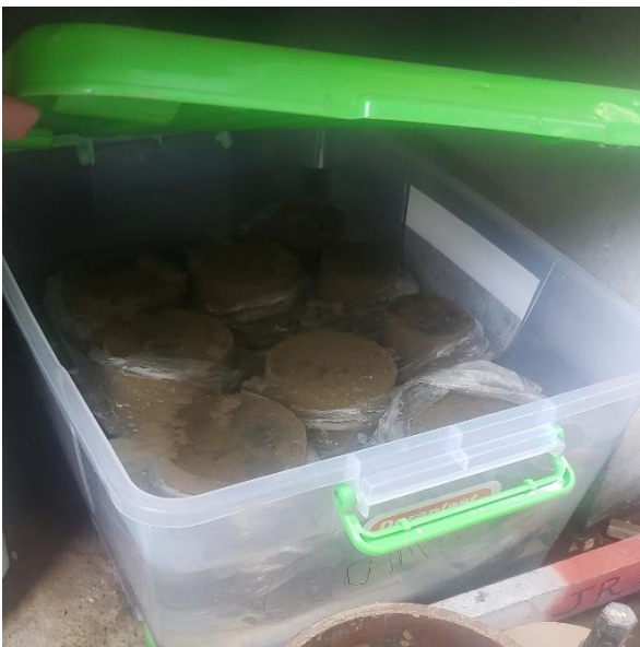
Foto N°47. Para el ensayo de Resistencia a la Compresión Simple de probetas suelo natural con cemento portland 12% y suelo natural con cemento portland 12% + adición de Mucílago de Tuna (1%, 2%, 3%), después del curado por 7 días en una cámara de humedad, las probetas se sumergen en agua por un lapso de 4 horas para que inmediatamente después de cumplido con el tiempo referido se sometan al ensayo de resistencia. (MTC E 1103) Fuente: Elaboración propia.
