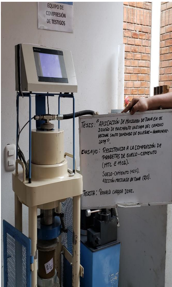
Foto N°50. Ensayo Resistencia a la Compresión Simple suelo natural con cemento portland 12% + adición de Mucílago de Tuna 2% - prensa hidráulica (MTC E 1103) Fuente: Elaboración propia.
