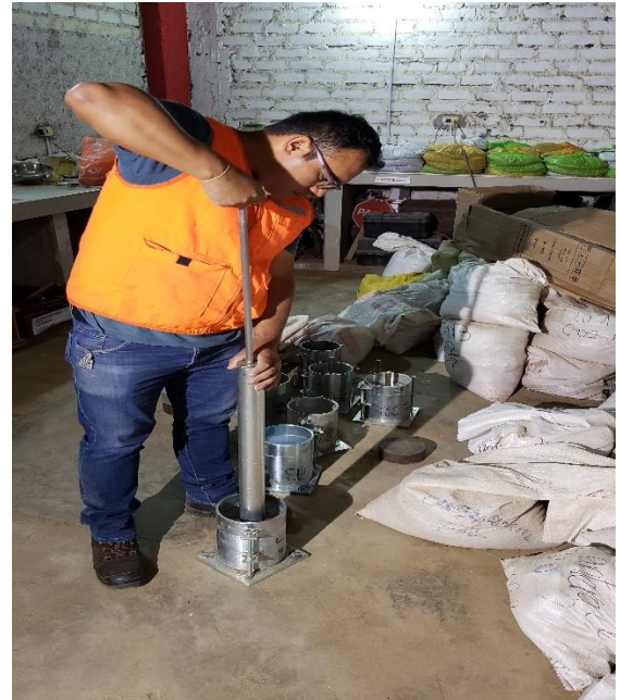
Foto N°38. Ensayo CBR – compactación en los moldes, suelo natural con cemento portland 12% + adición de Mucilago de Tuna (1%, 2%, 3%). Fuente: Elaboración propia.
