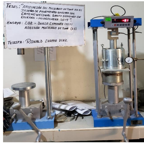
Foto N°42. Ensayo en prensa CBR suelo natural con cemento portland 12% + adición de Mucílago de Tuna 3% (ASTM D1883) Fuente: Elaboración propia.
