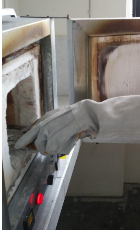
Figura 19. Colocación de probeta en el horno para tratamiento térmico
