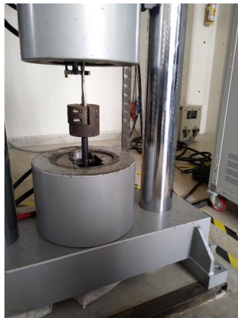
Figura 20. Adecuación de probeta para ensayo de tracción
