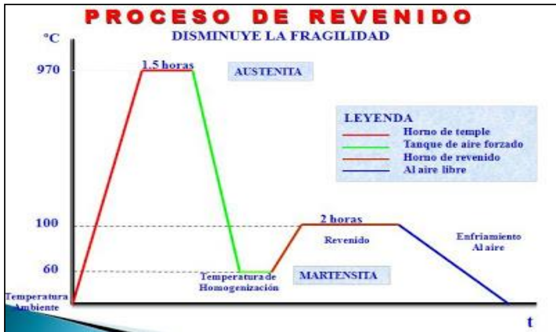
Figura 03. Proceso de templeado y revenido (Molera, 2009).
