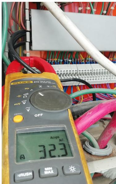
*Figura 22. Medición del consumo de energía eléctrica en la cámara de almacenamiento*
