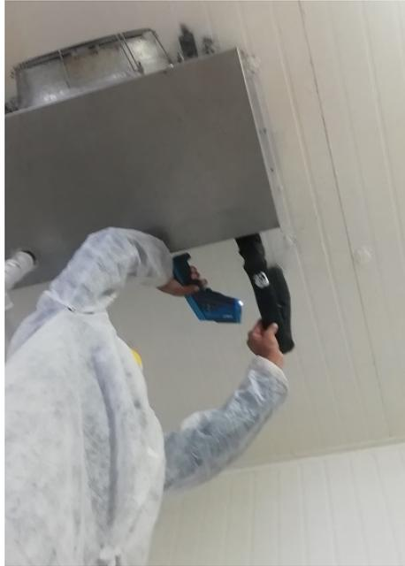
*Figura 21. Medición de temperatura de recalentamiento a la salida del evaporador de la cámara de Salmuera*
