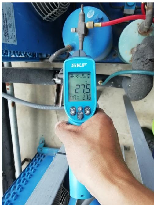
*Figura 19. Medición de temperatura de sub-enfriamiento en unidad condensadora de refrigeración de cámara de envasado*
