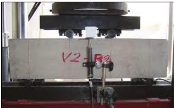
Figura 2: Ensayo de resistencia a flexión.
