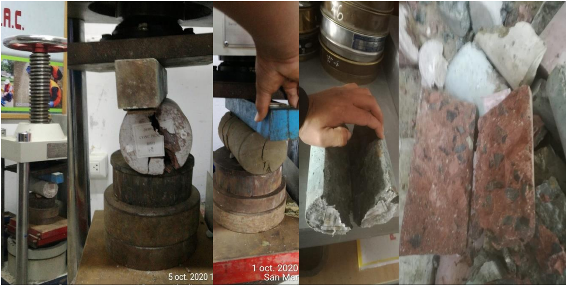
N° 11: Ensayo a tracción por compresión diametral de concreto patrón, rojo amarillo y verde en porción de 3% y 5%.
