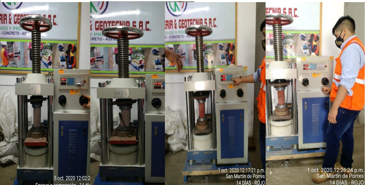
N° 7: Ensayo a compresión del concreto pigmentado rojo al 3%, 5% y 7%.
