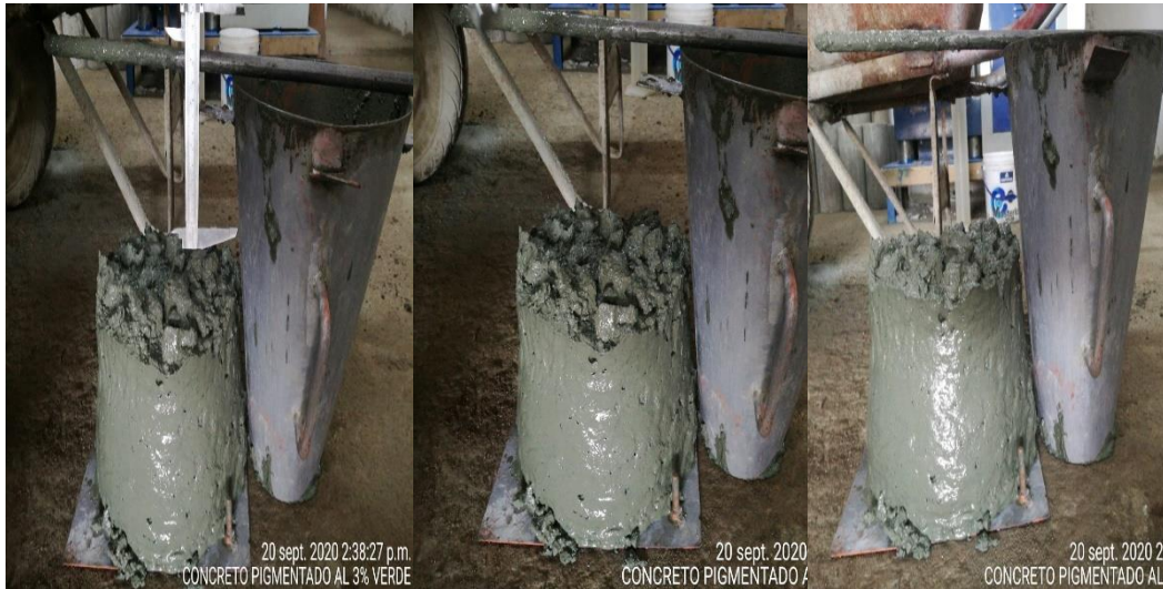
Figura 16: Medida del asentamiento del concreto verde 3%, 5% y 7%.
