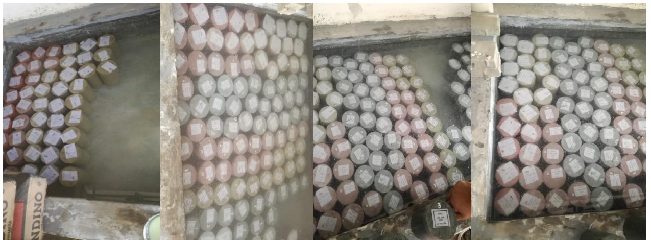
N° 4: Curado de probetas en condiciones normales.
