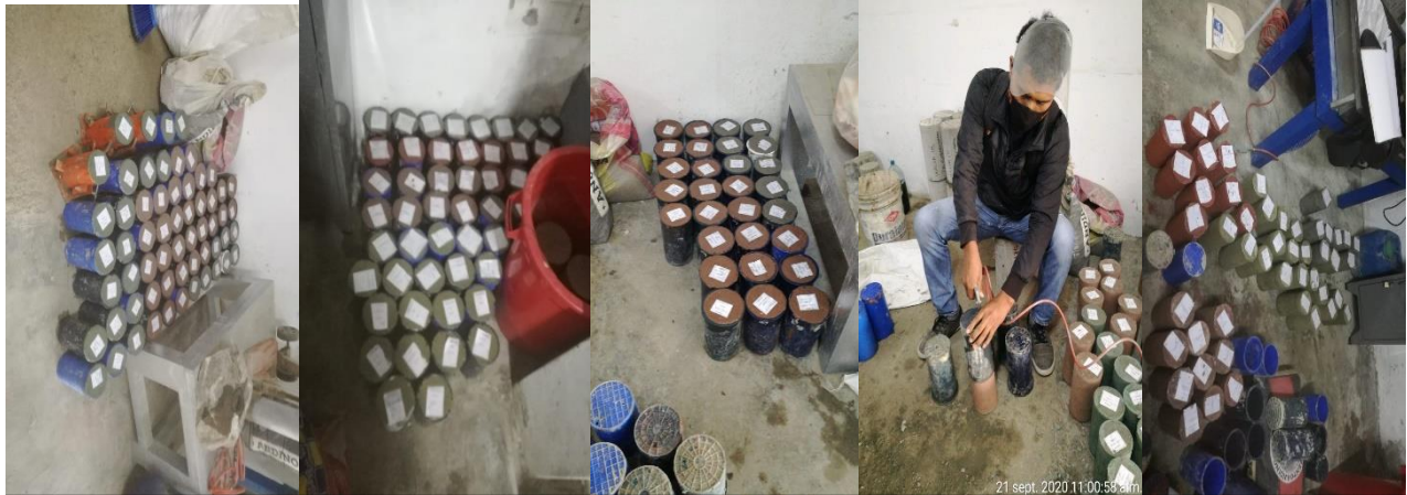
N° 3: Encofrado y desencofrado del concreto patrón y pigmentado.
