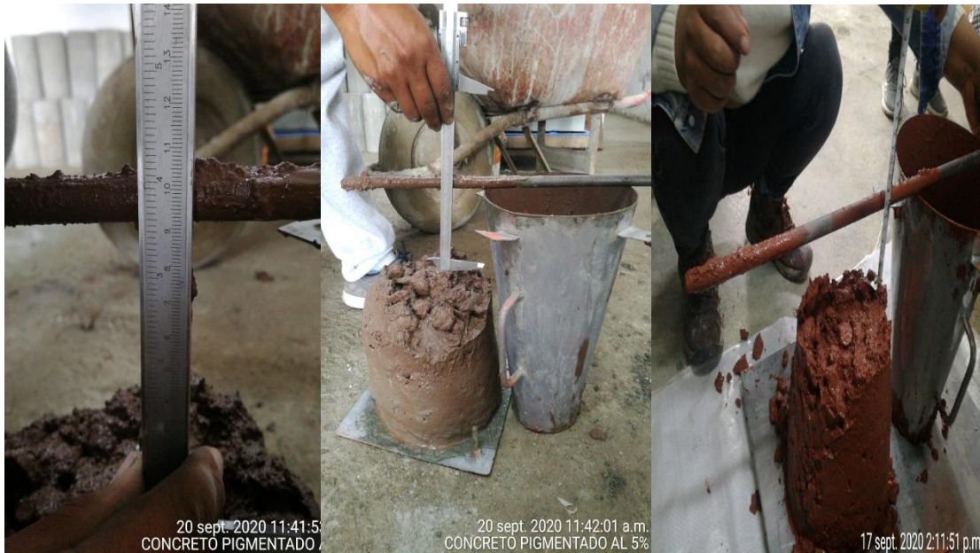
Figura 14: Medida del asentamiento del concreto rojo 3%, 5% y 7%.
