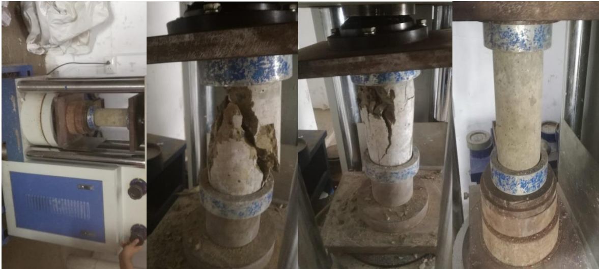
N° 8: Ensayo a compresión del concreto pigmentado amarillo al 3%, 5% y 7%.
