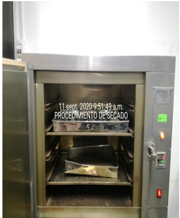
N° 24: Agregado grueso y fino sometido al horno a una temperatura de 105^{\circ} \pm 5\text{ C}
