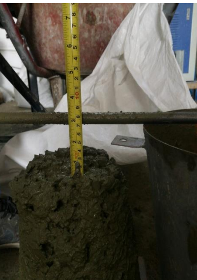
N° 43: Medición de slump para el concreto pigmentado amarillo.
