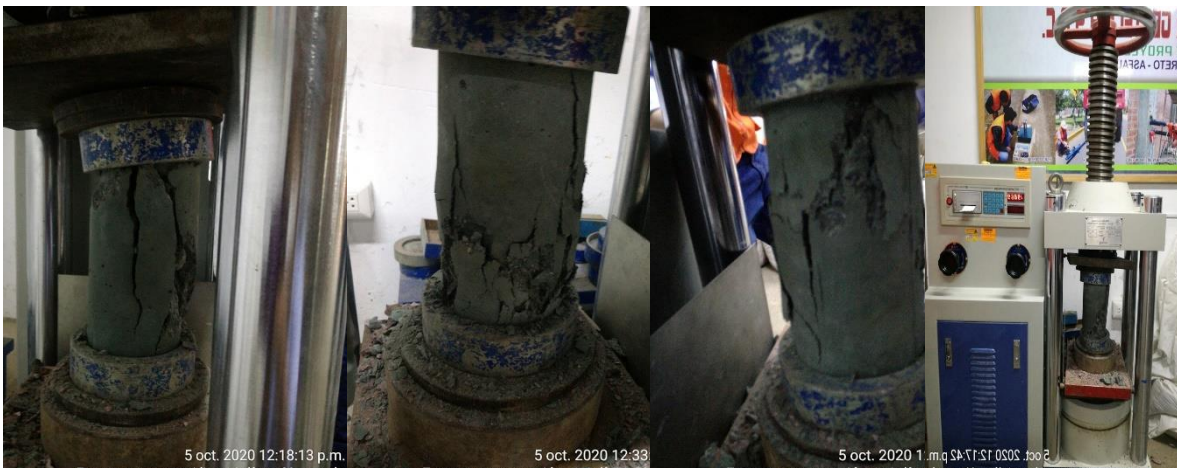
N° 9: Ensayo a compresión del concreto pigmentado verde al 3%, 5% y 7%.
