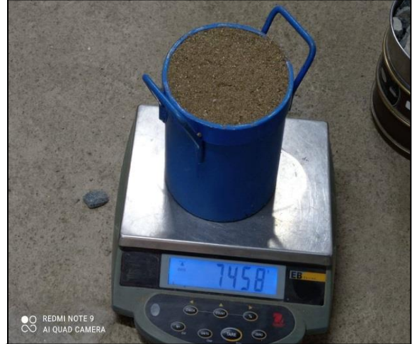
N° 6: Agregado fino compactado y pesado en la balanza calibrada.
