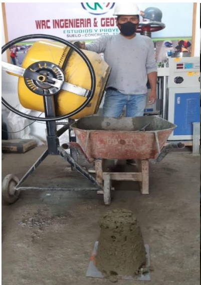
N° 43: Medición de slump para el concreto pigmentado amarillo.
