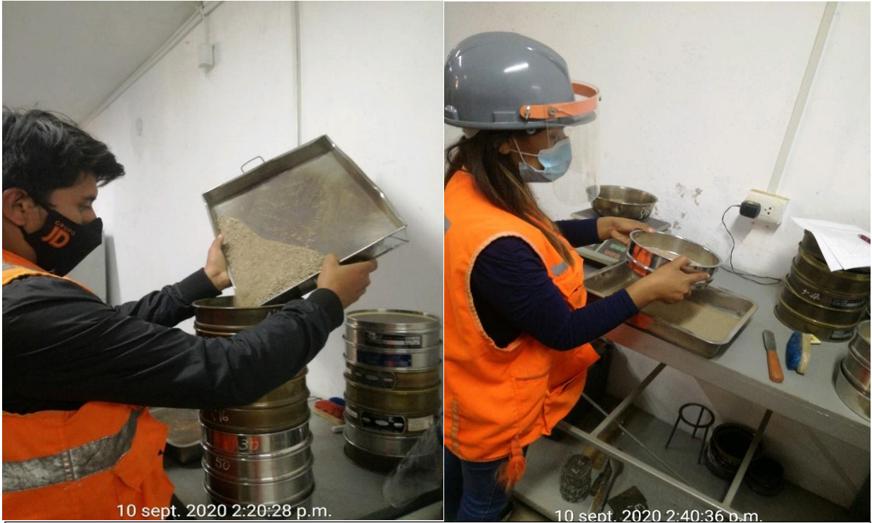
N°1: Tamizado del agregado fino para el ensayo de granulometría.
