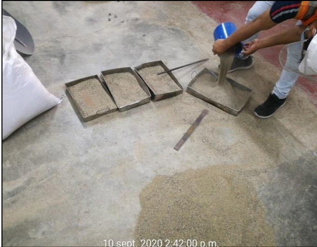
N° 5: En la fotografía se muestra los materiales y herramientas para realizar el ensayo de peso suelto del agregado fino.
