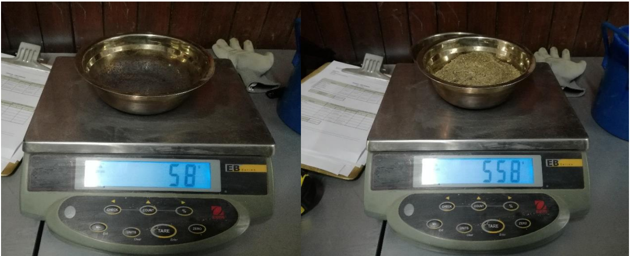
N° 16: En las fotografías se muestran el peso del agregado fino para el ensayo del peso específico y absorción.
