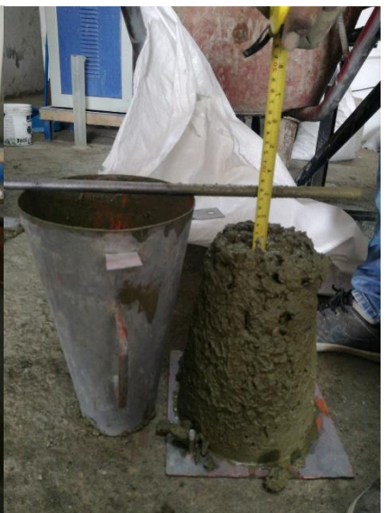
N° 43: Medición de slump para el concreto pigmentado amarillo.
