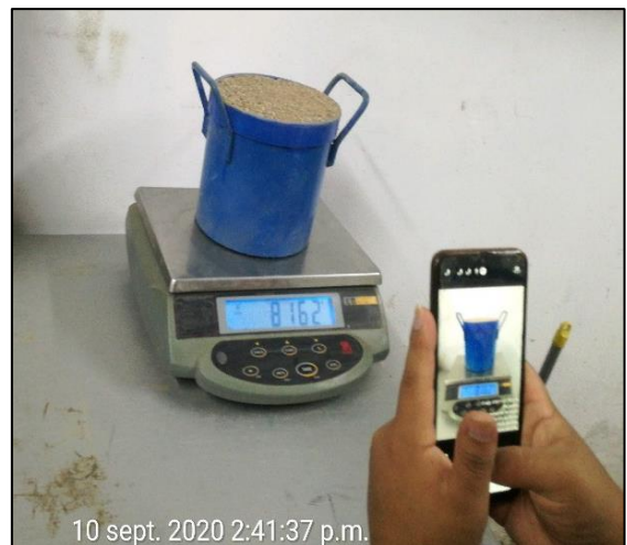
N° 8: En la fotografía se muestra la toma de datos del peso suelto en la balanza calibrada
