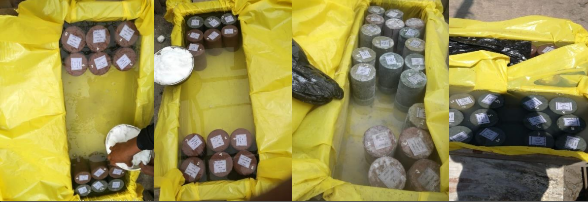
N° 5: Curado de probetas expuestas a sulfatos de magnesio.
