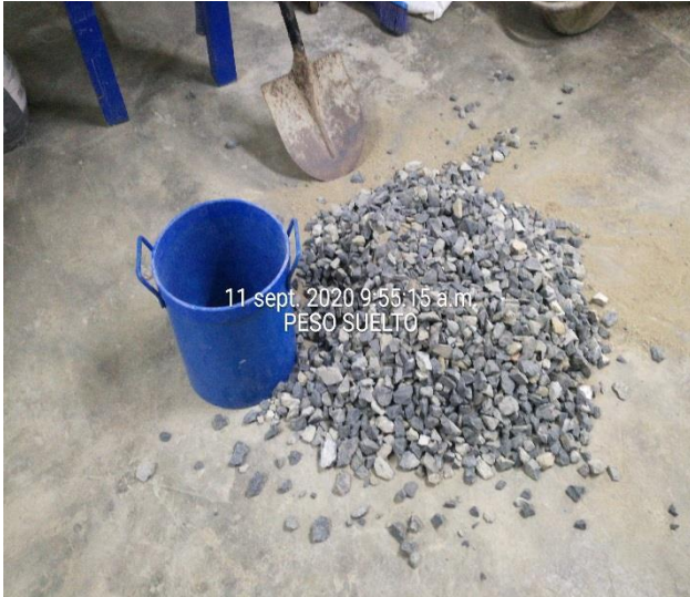
N° 11: Se muestra el agregado (piedra chancada). grueso para el ensayo del peso suelto.
