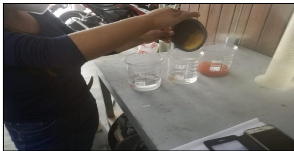
Figura 8: Proceso de humectabilidad del pigmento (ASTM C 979-2005)
