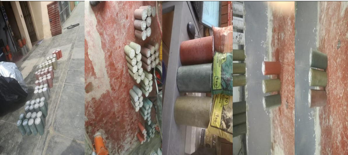
N° 6: Secado de probetas para los ensayos a compresión y tracción.
