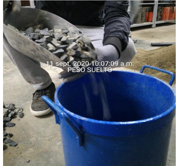
N° 12: Se muestra el llenado del agregado grueso (piedra chancada) en el molde.
