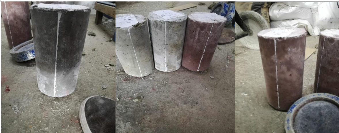
N° 10: Trazo de recta lineal en el centro de la longitud de la probeta para ensayo a tracción.
