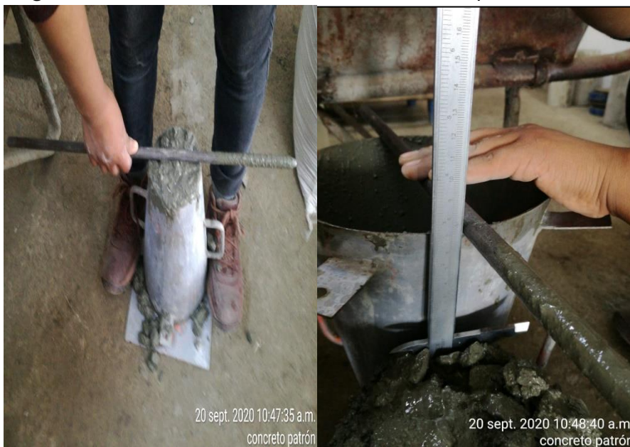
Figura 13: Medida del asentamiento del concreto patrón obteniendo 3.6".
