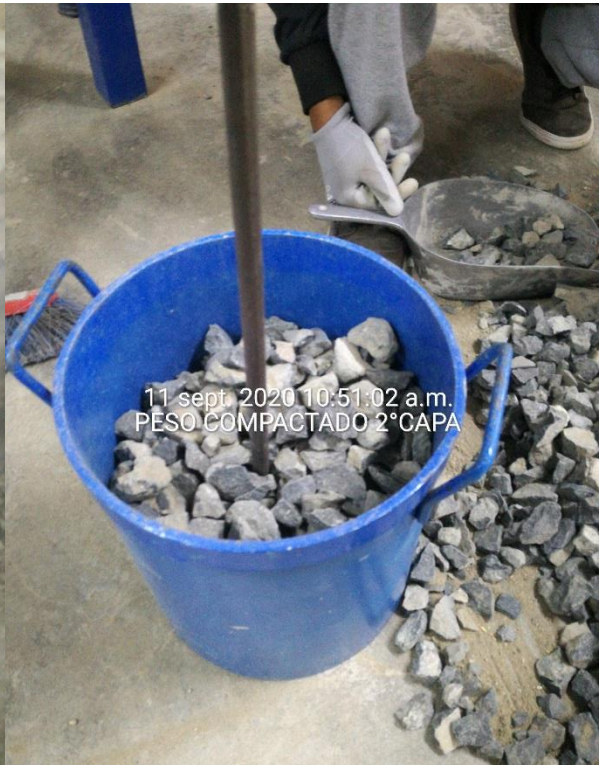
N° 9: Primera y segunda capa de compactación del agregado grueso.
