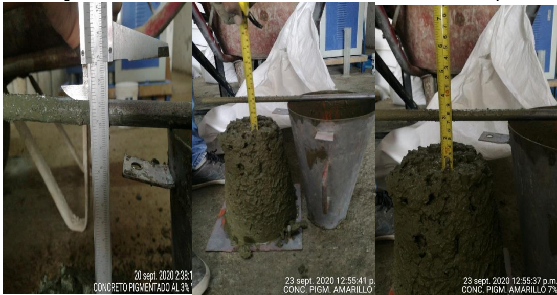
Figura 15: Medida del asentamiento del concreto amarillo 3%, 5% y 7%
