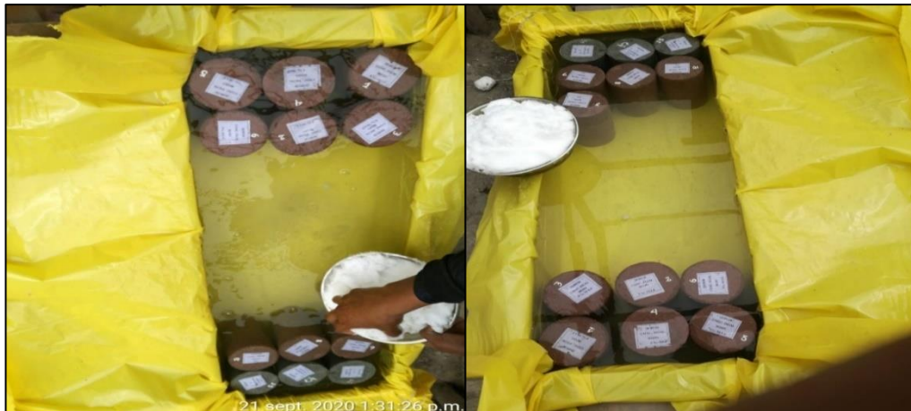
Figura 18: Curado emergido en sulfatos de magnesio (50 g/L).
