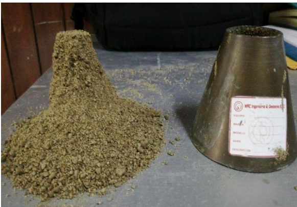
N° 19: Ensayo de cono para densidad de arena.
