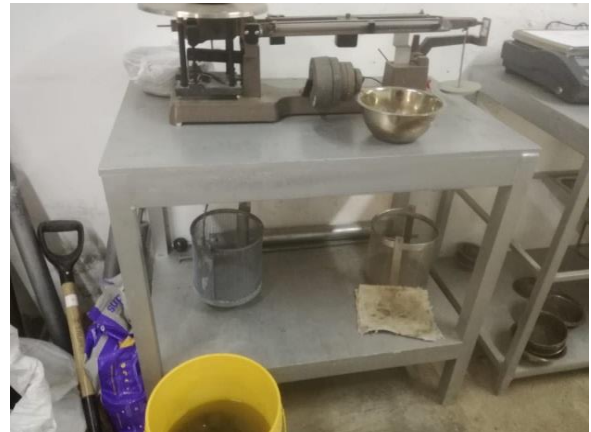
N° 22: Ensayo de peso específico del agregado grueso.
