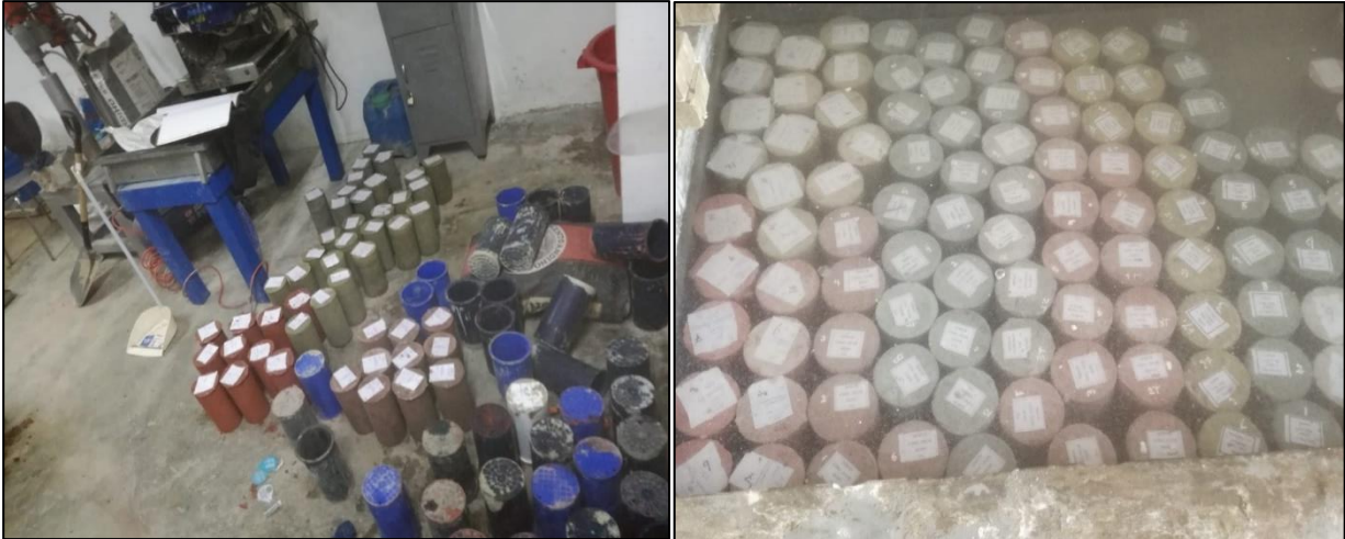
Figura 17: Curado normal de las probetas
