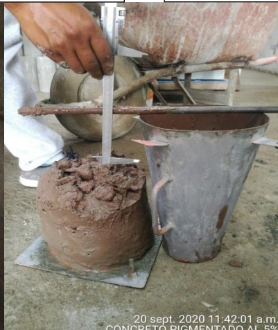
N° 42: Medición de slump para el concreto pigmentado rojo.
