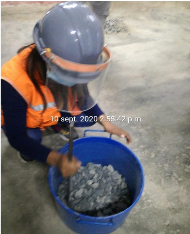
N° 9: Primera y segunda capa de compactación del agregado grueso.
