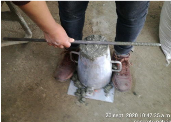
N° 40: Vaciado del concreto patrón en cono de abrams.
