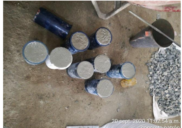
N° 41: Vaciado del concreto patrón en las probetas de 4" x 8".
