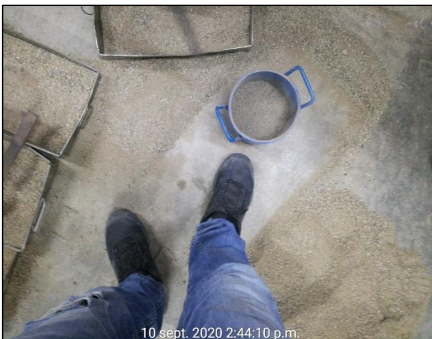
N° 7: Se muestra el llenado del agregado fino sin compactación para el ensayo del peso suelto.
