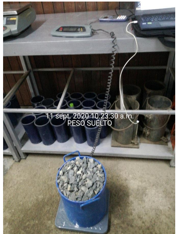
N° 14: En la fotografía se muestra el peso suelto del agregado grueso
