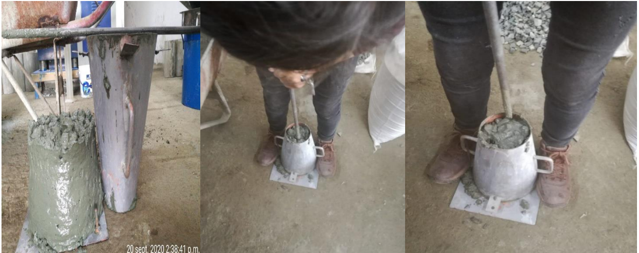
N° 44: Medición de slump para el concreto pigmentado verde.
