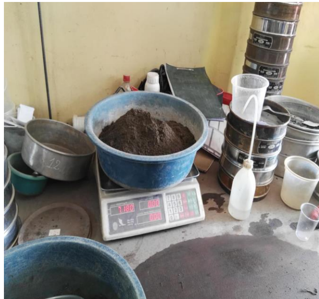
Foto 10: Pesando la muestra para realizar el ensayo de Proctor Modificado
