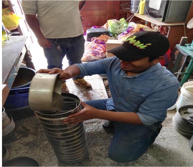
Foto 09: Pasando la muestra por los tamices – Ensayo de Análisis Granulométrico
