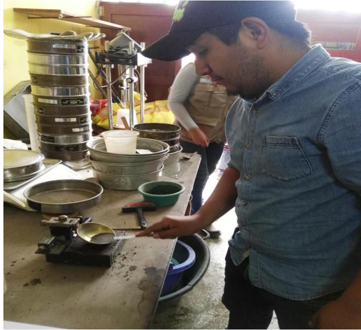
Foto 15: Determinando el límite líquido mediante la cuchara de Casagrande
