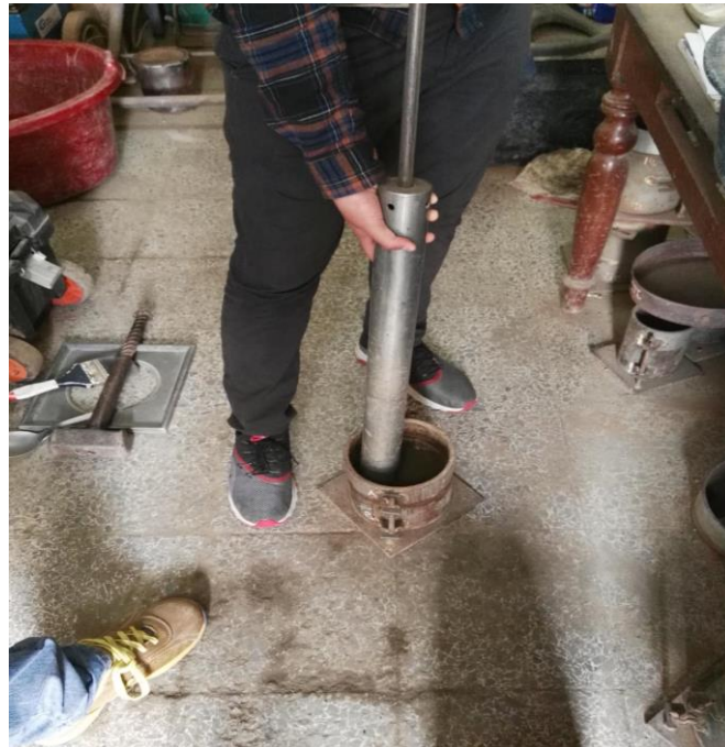
Foto 12: Realizando los golpes para la compactación de la muestra
