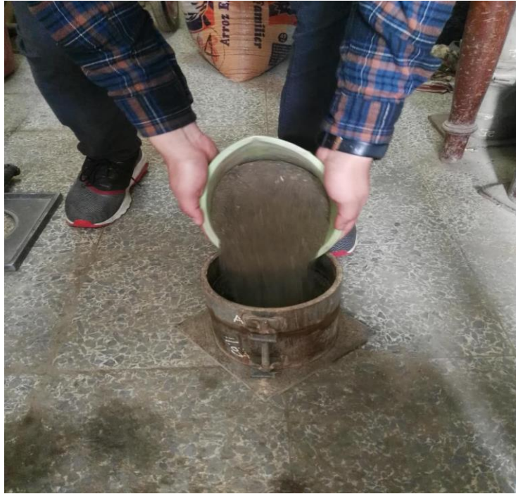
Foto 11: Conformando las capas en el molde para realizar los golpes de compactación
