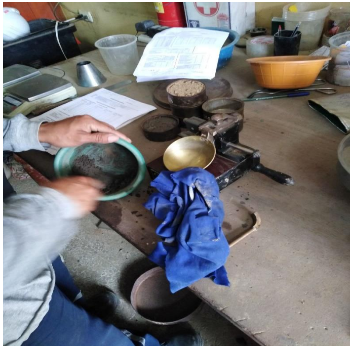
Foto 14: Preparando la muestra para el ensayo de Límite de Atterberg
