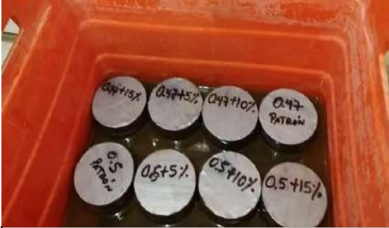
Determinación de la absorción (mm) de las probetas
