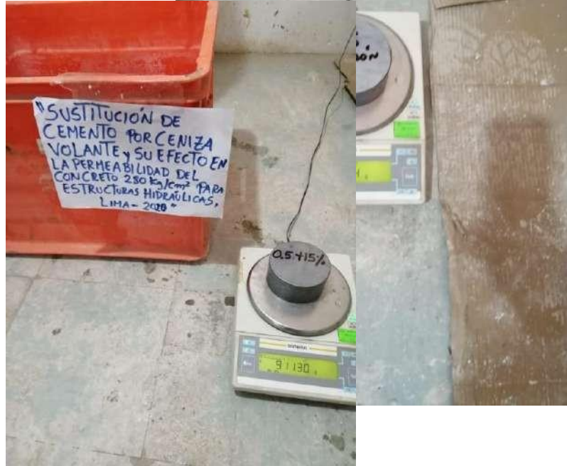
Pesado de la rodaja de concreto en a/c = 0.5 15% CV
