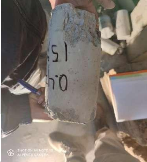
Detalle de falla de la rotura de concreto
