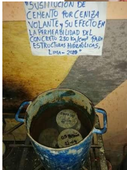
Hervido y ebullición de las rodajas de concreto
