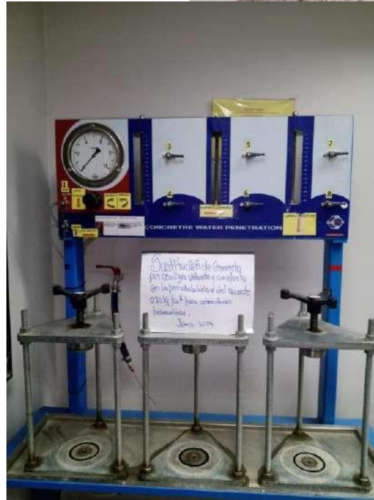
Permeámetro para medir la permeabilidad bajo presión de agua en concretos endurecidos
