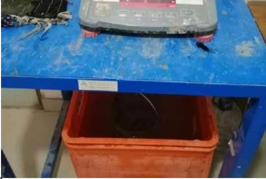
Pesado de las rodajas de concreto
