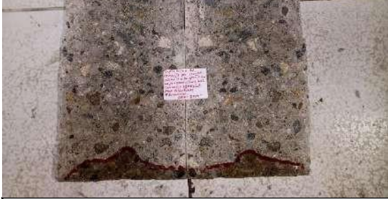
Profundidad de penetración bajo presión de agua
