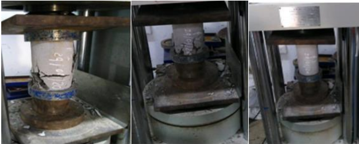
Figura 44: Fractura de probetas del concreto patrón a los 7 día
