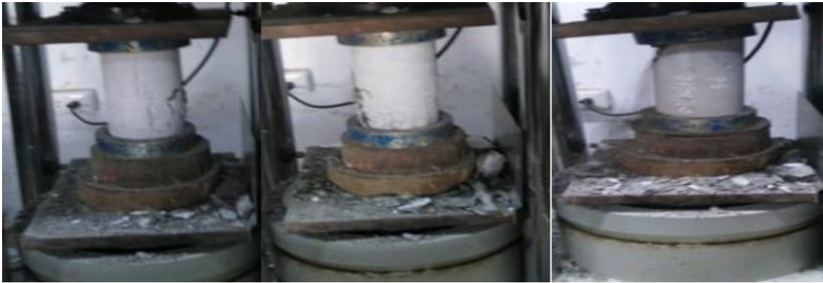
Figura 58: Fractura de probetas del concreto patrón con inmersión de sulfatos a los 28 días
