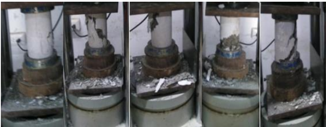
Figura 54: Fractura de probetas con 30% y T1 de polipropileno a los 28 días.
