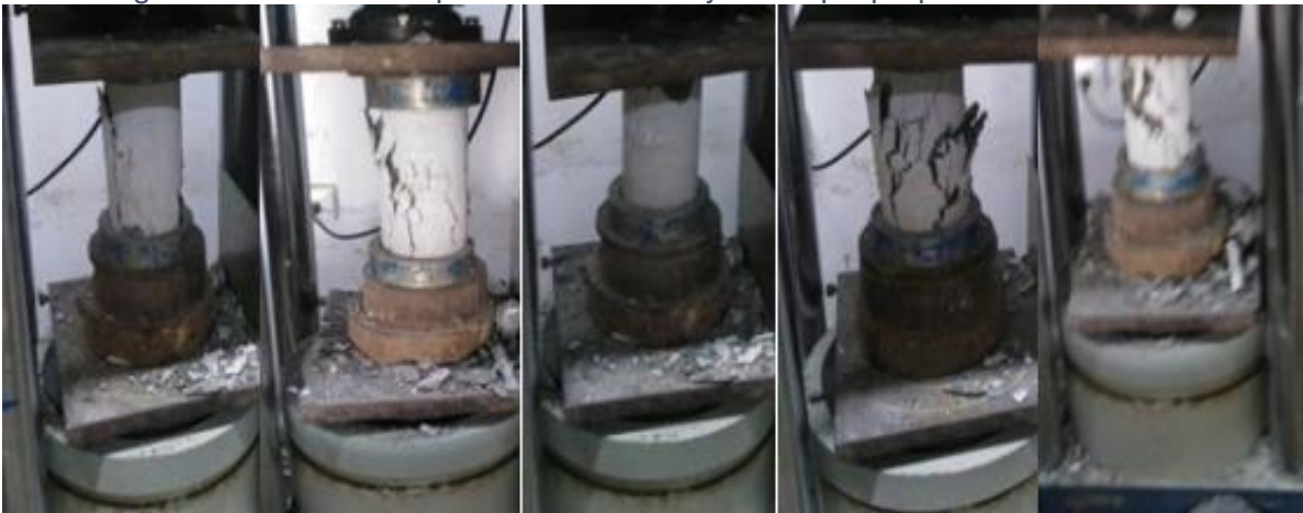
Figura 56: Fractura de probetas con 30% y T2 de polipropileno a los 28 días.
