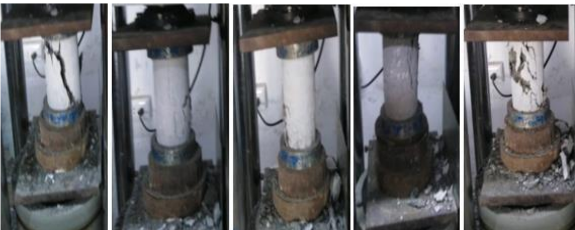
Figura 51: Fractura de probetas con 20% y T1 de polipropileno a los 28 días.
