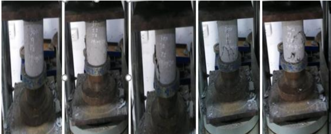
Figura 47: Fractura de probetas con 30% y T1 de polipropileno a los 7 días.
