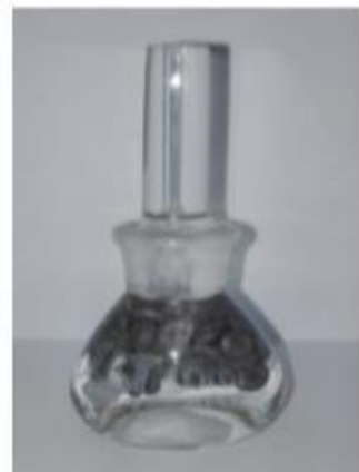
Figura 5: Muestra de polipropileno y ensayo utilizando picnómetro
