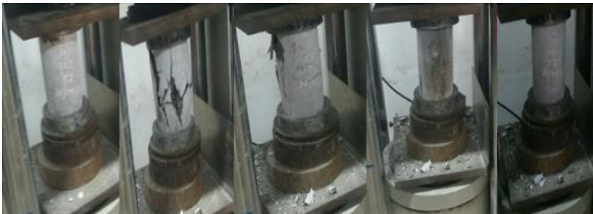
Figura 65: Fractura de probetas con 30% y T2 de polipropileno con inmersión a sulfatos a los 42 días.
