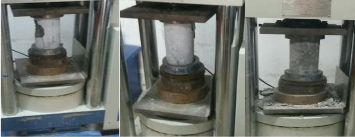
Figura 61: Fractura de probetas del concreto patrón con inmersión de sulfatos a los 42 días
