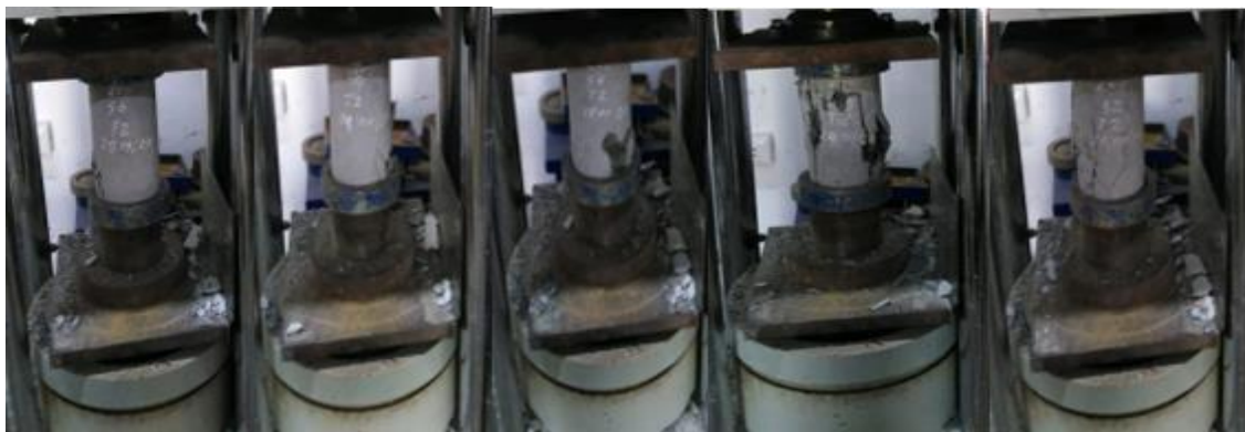
Figura 46: Fractura de probetas con 20% y T2 de polipropileno a los 7 días.
