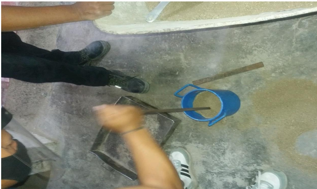
Figura 27: Ensayo de peso unitario del agregado fino.
