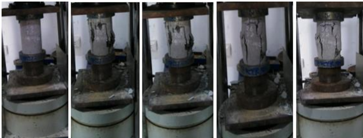
Figura 48: Fractura de probetas con 30% y T2 de polipropileno a los 7 días.
