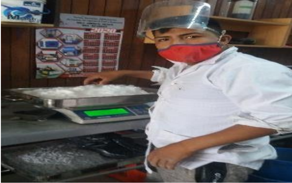
Figura 40: Pesado de sulfato de magnesio para el curado.
