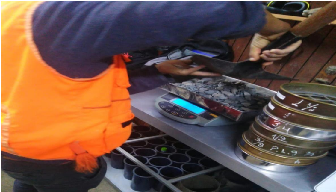
Figura 26: Tamizaje del agregado grueso.
