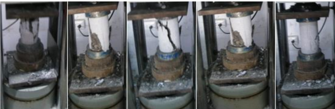
Figura 60: Fractura de probetas con 30% y T2 de polipropileno con inmersión a sulfatos a los 28 días.
