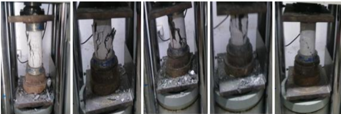
Figura 50: Fractura de probetas con 20% y T1 de polipropileno a los 28 días.
