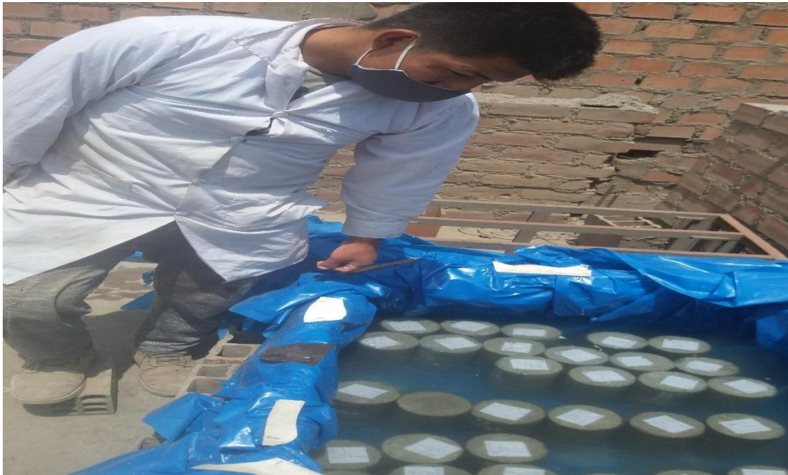
Figura 41: Curado en sulfato de magnesio.
