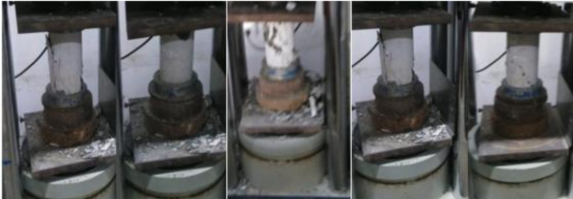
Figura 59: Fractura de probetas con 30% y T1 de polipropileno con inmersión a sulfatos a los 28 días.
