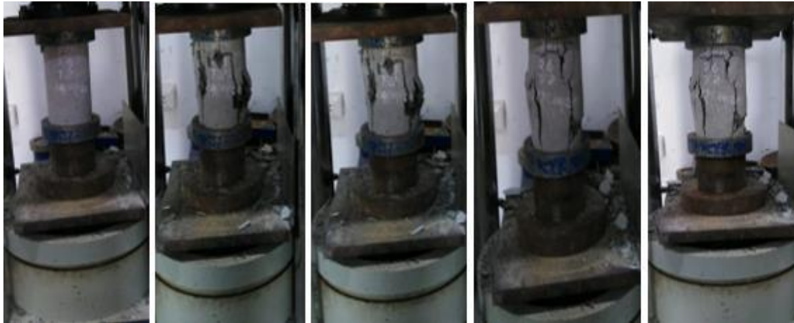
Figura 64: Fractura de probetas con 30% y T2 de polipropileno con inmersión a sulfatos a los 42 días.
