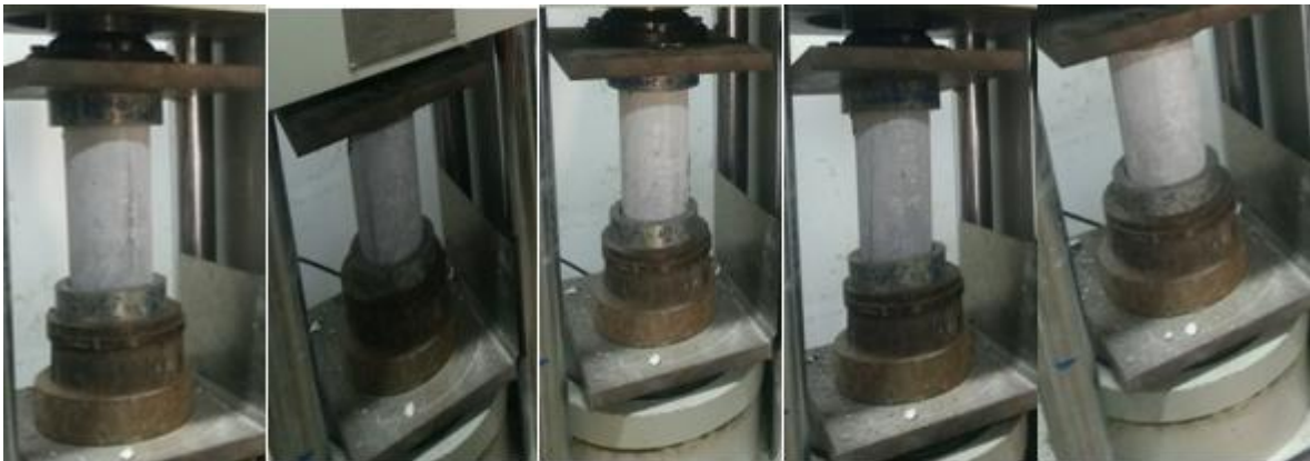
Figura 63: Fractura de probetas con 30% y T1 de polipropileno con inmersión a sulfatos a los 42 días.
