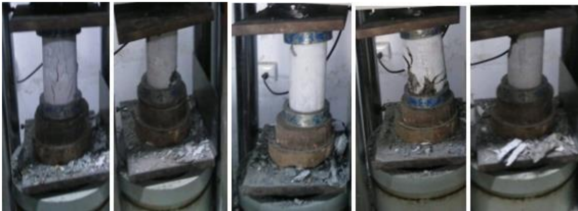
Figura 62: Fractura de probetas con 30% y T1 de polipropileno con inmersión a sulfatos a los 42 días.
