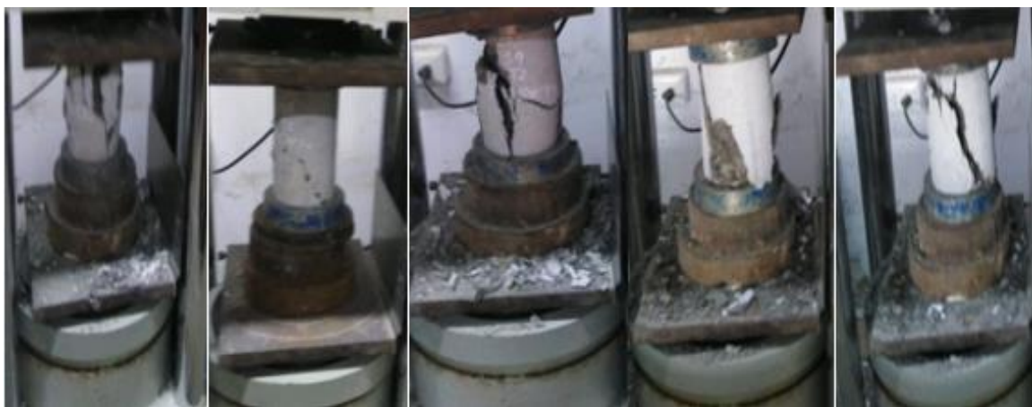
Figura 57: Fractura de probetas con 30% y T2 de polipropileno a los 28 días.
