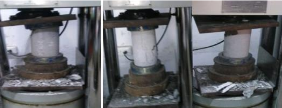
Figura 49: Fractura de probetas del concreto patrón a los 28 días.
