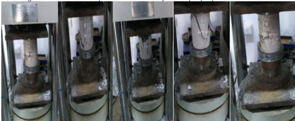
Figura 45: Fractura de probetas con 20% y T1 de polipropileno a los 7 días.
