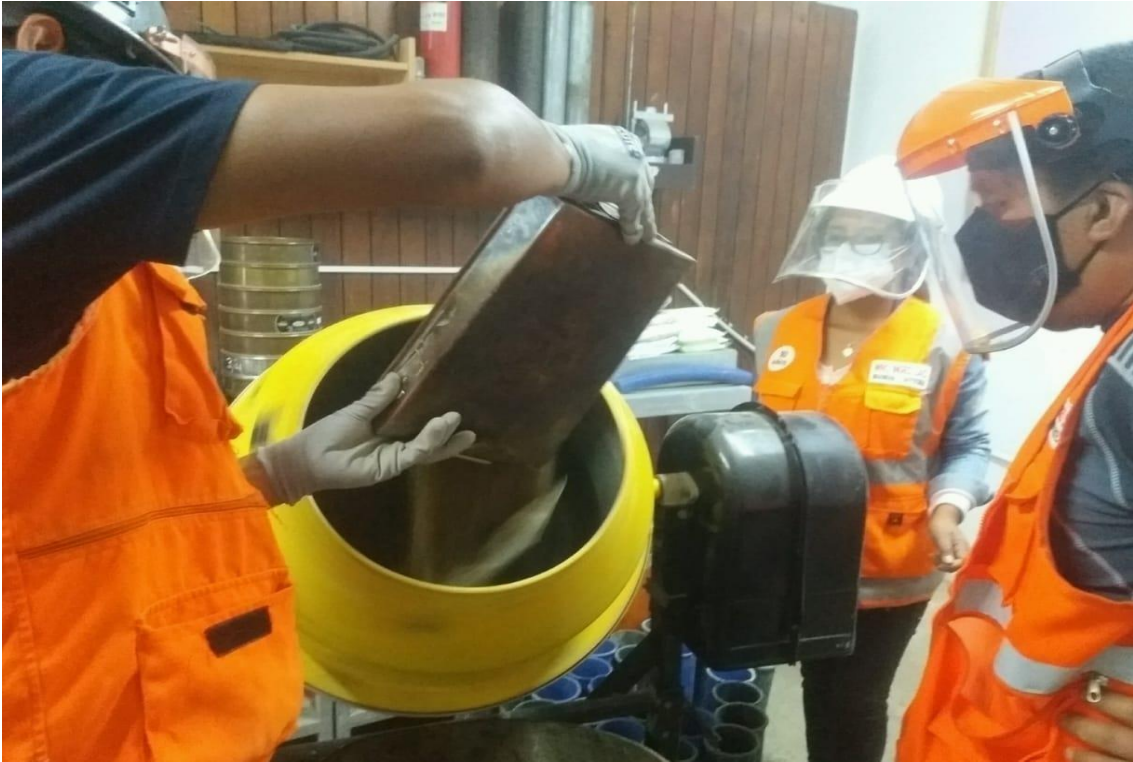
Figura 32: Mezclado del concreto en trompito.
