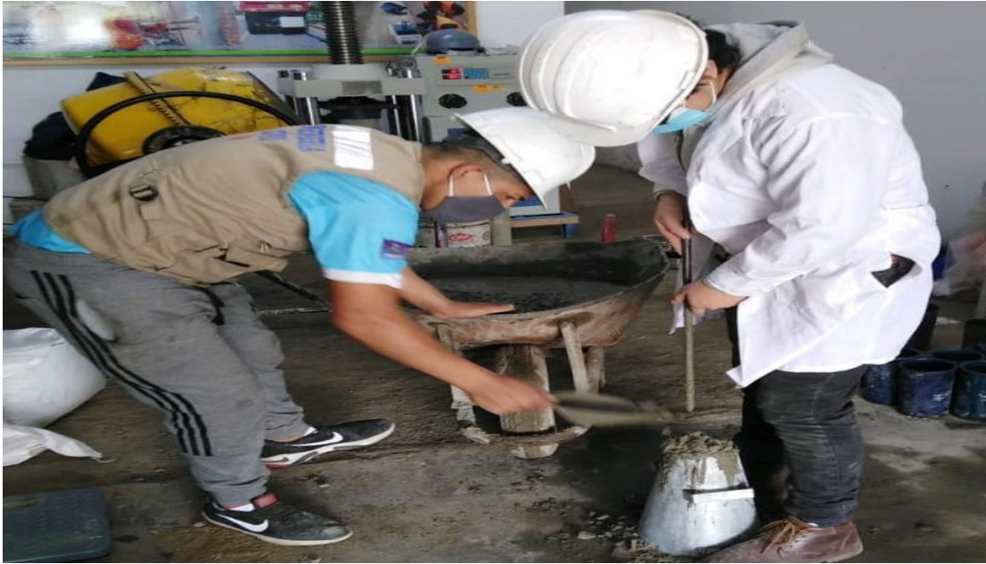
Figura 34: Ensayo de slump concreto patrón.
