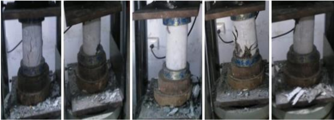
Figura 52: Fractura de probetas con 20% y T2 de polipropileno a los 28 días.
