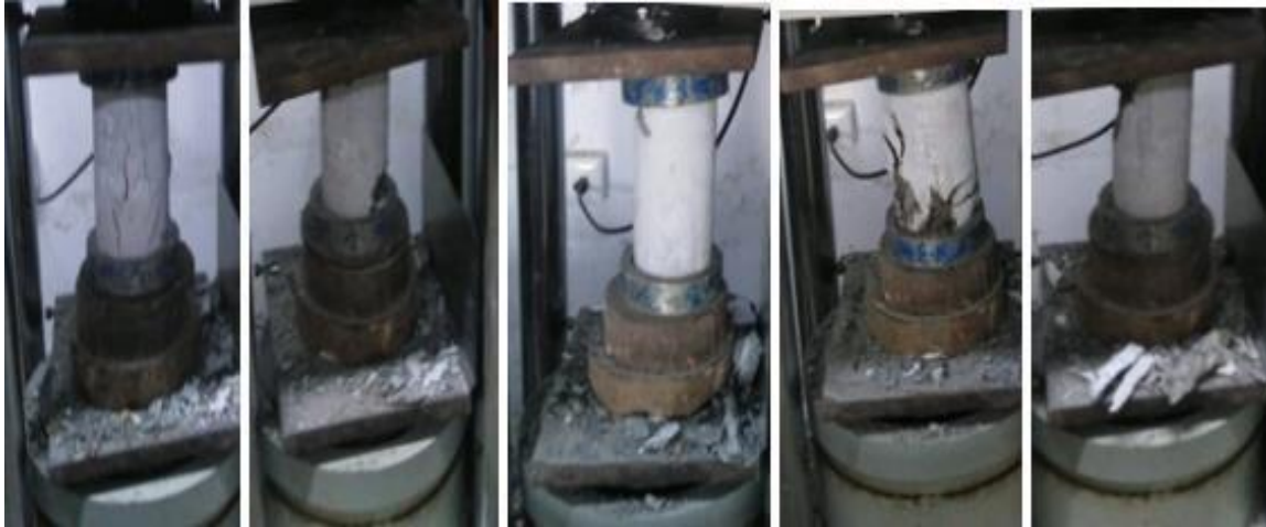
Figura 55: Fractura de probetas con 30% y T1 de polipropileno a los 28 días.
