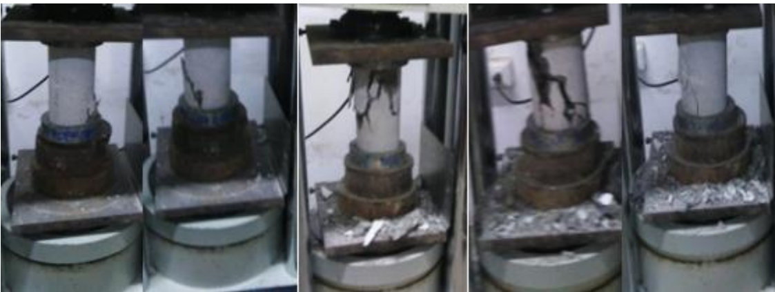
Figura 53: Fractura de probetas con 20% y T2 de polipropileno a los 28 días.
