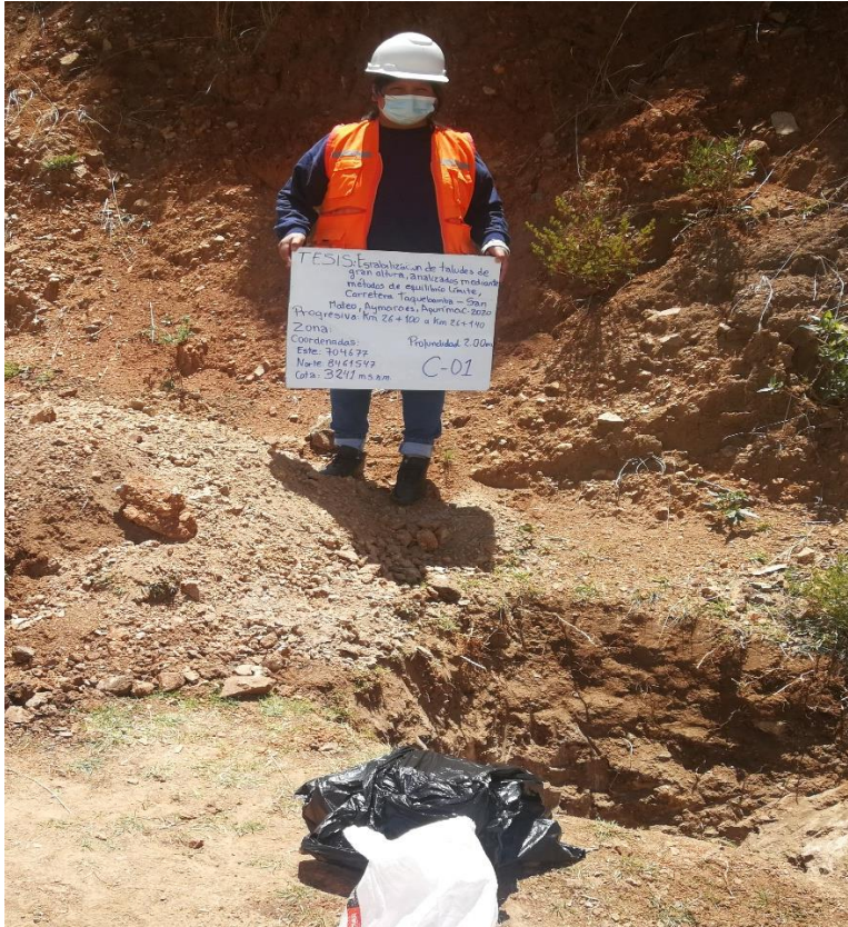
Figura 1. Obtención de muestra de calicata tramo km 26+100 a km 26+140
