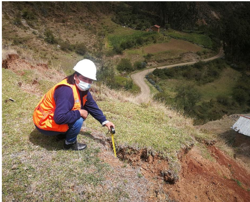
Figura 2. Medición de escarpes tramo km 26+500 a km 26+640
