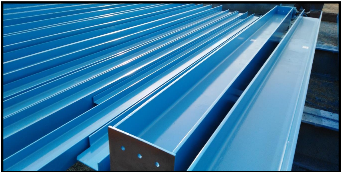
Anexo 12. Tratamiento de superficie de vigas principales, proyecto Nueva refinería.
