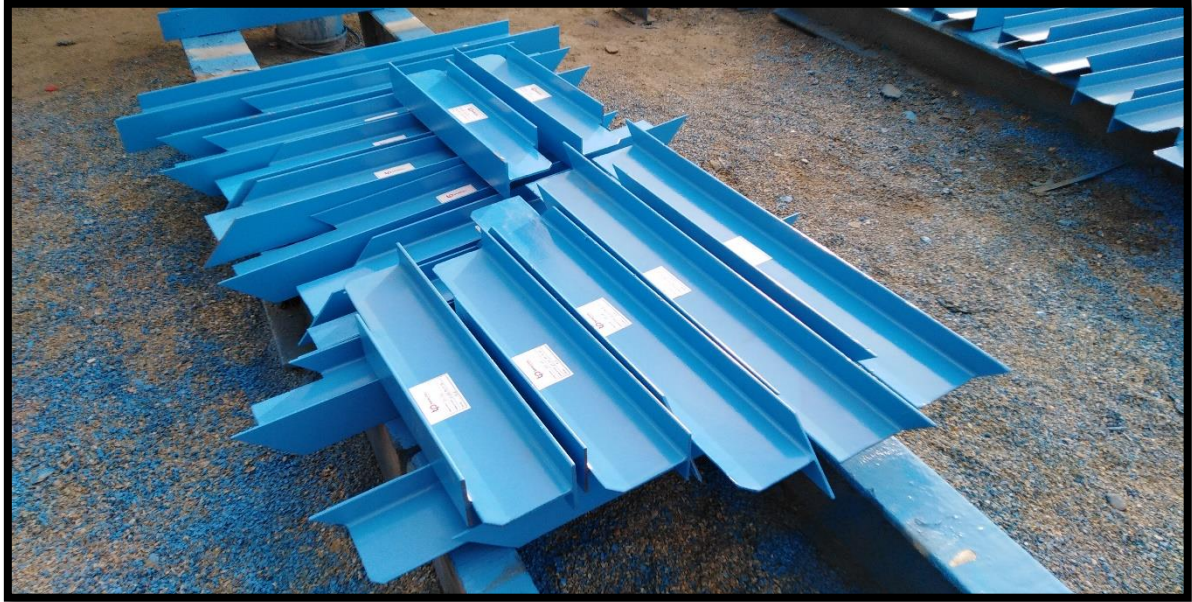
Anexo 11. Tratamiento de superficie y rotulado de elementos, proyecto Nueva refinería.
