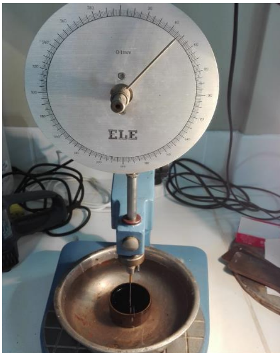
Imagen 3. Ensayo de penetración 25° C.
