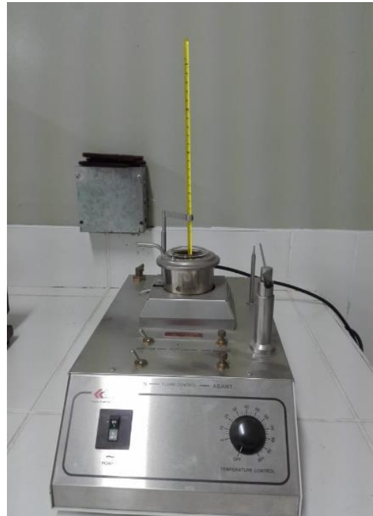
Imagen 2. Ensayo de punto de Inflamación.
