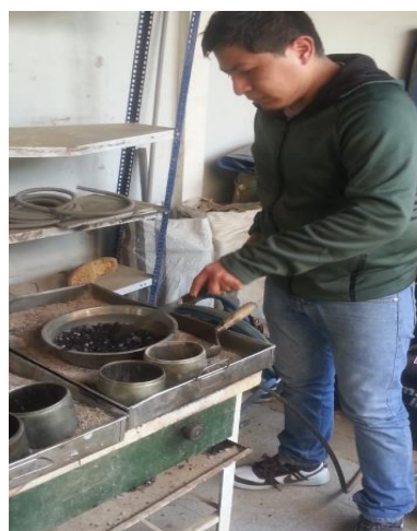
Figura 32. Mezclando los agregados con las mezclas asfálticas
