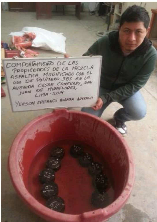
Imagen 11. Reposar en agua 15 min para tener peso en aire.
