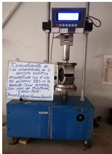
Figura 18. Ensayo de estabilidad y flujo
