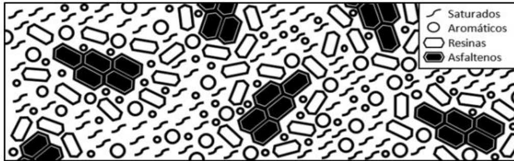
Figura 8. Composición del asfalto
