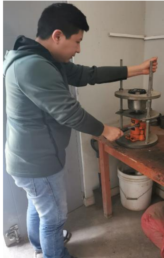
Imagen 10. El extractor es para retirar las probetas.
