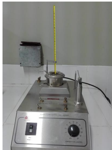
Figura 13. Ensayo de punto de inflamación
