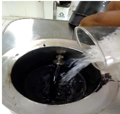
Figura 5. Asfalto caliente modificado con polímero SBS
