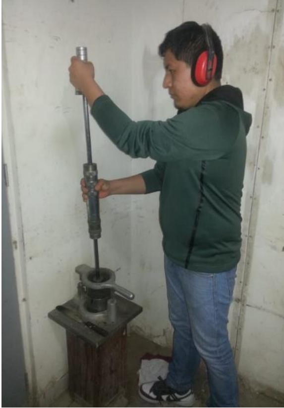
Imagen 9. Compactación de las mezclas Asfálticas.
