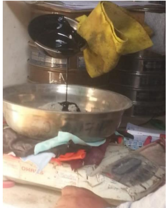
Imagen 6. Peso de agregado añadiendo bitumen.
