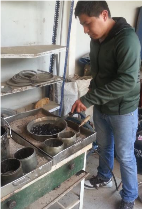
Imagen 7. Mezclando los agregados con las mezclas asfálticas
