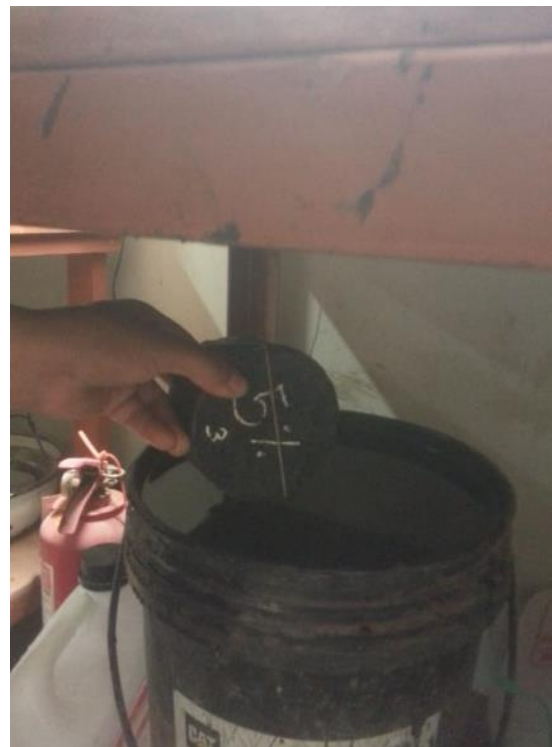
Imagen 12. Volumen de las briquetas por desplazamiento.
