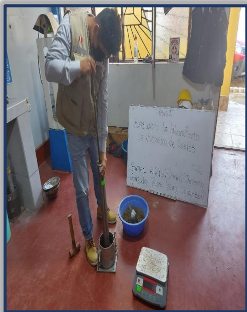
Figura N°11: Se procedió a realizar el ensayo de CBR.
