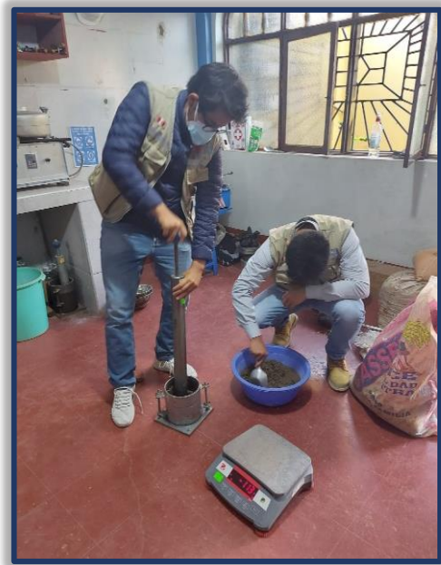
Figura N°12: Se procedió a realizar el ensayo de proctor modificado.
