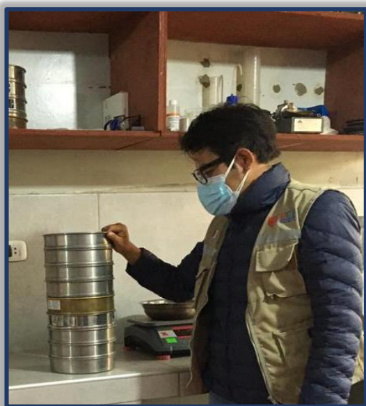
Figura N°08: Se realizó el ensayo granulométrico a las muestras.
