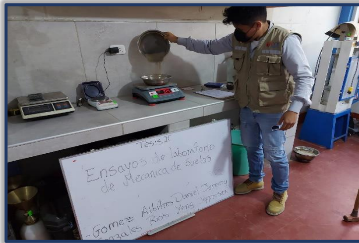
Figura N°10: Se procedió al pesado de la muestra para realizar los ensayos de límites de Atterberg.
