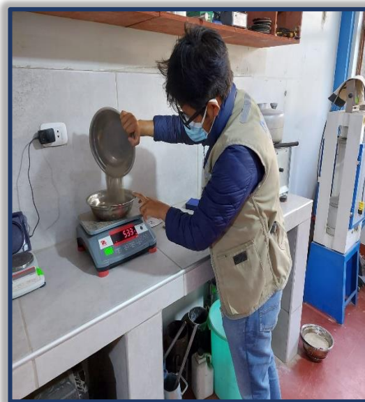
Figura N°09: Se realizó el pesado de la muestra para el ensayo de contenido de humedad.
