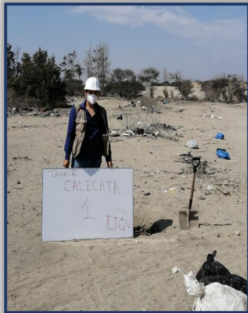
Figura N°03: Se procedió a realizar la calicata 1.
