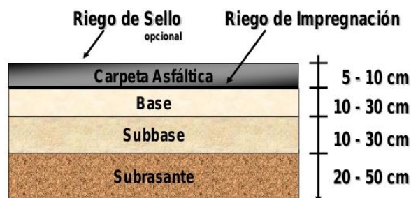
Figura 39: Sección Transversal de pavimento flexible
