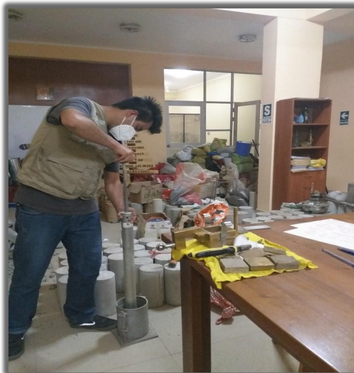
Fotografía 10: Procedimiento para compactar el suelo (CBR)
