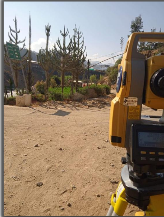
Fotografía 1: Primera Estación del Levantamiento topográfico
