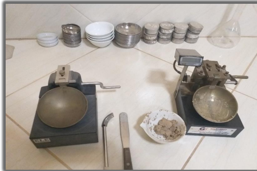
Fotografía 9: Copa Casagrande para hallar el limite liquido de la calicata
