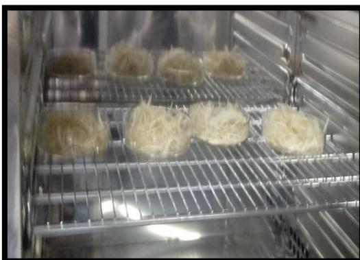
Figura 6: Obtención de la humedad de las plumas de pollo a 60 °C.
