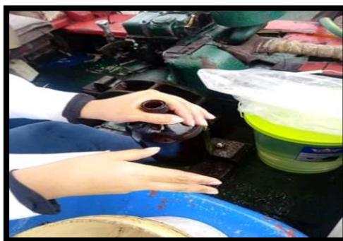
Figura 9: Muestreo de agua para hidrocarburos totales de petróleo
