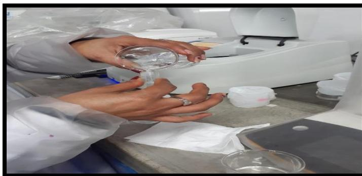
Figura 19: Análisis los hidrocarburos totales de petróleo en el agua tratada
