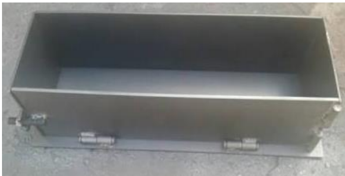
Figura 5: probeta tipo viga de 15.5 x 15.5 x 53 centímetros
