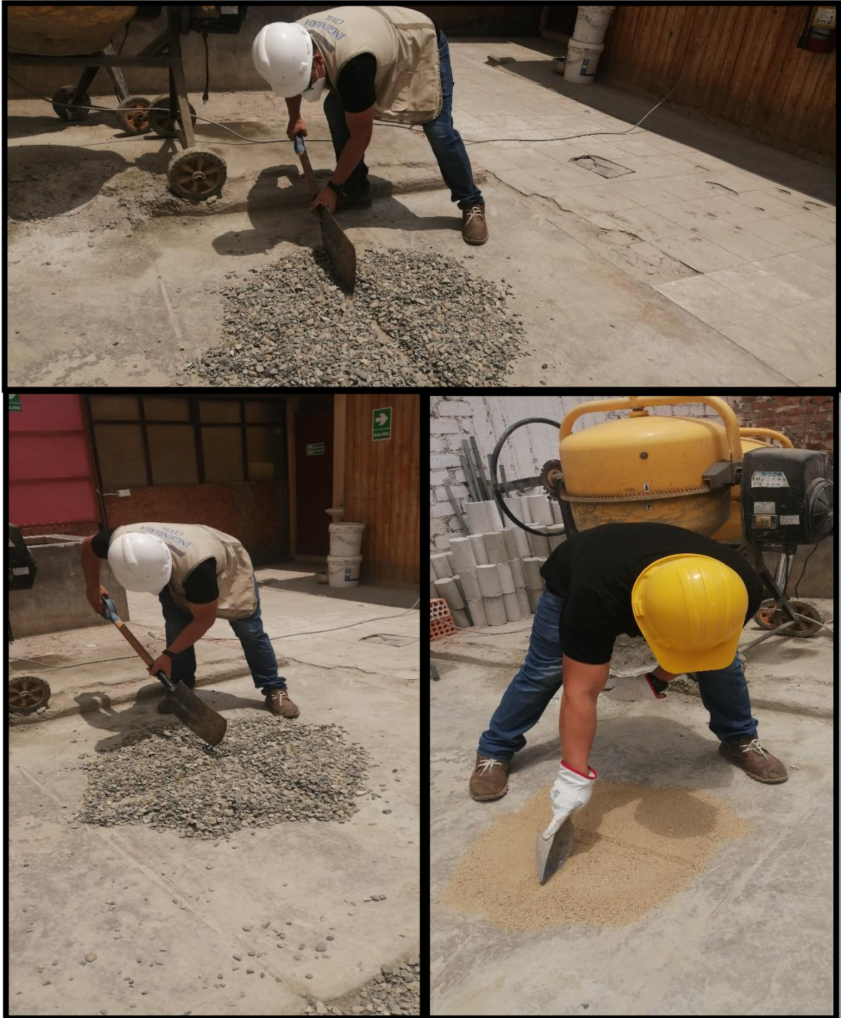
Anexo 7.2. Cuarteo del agregado grueso y fino para uniformizar y obtener una muestra representativa del material a ensayar
