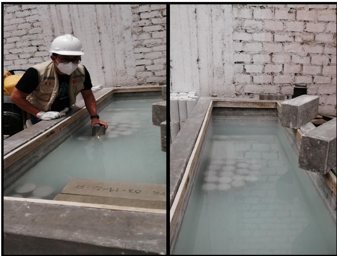
Anexo 7.10. Curado del concreto armado para los 7,14 y 28 días
