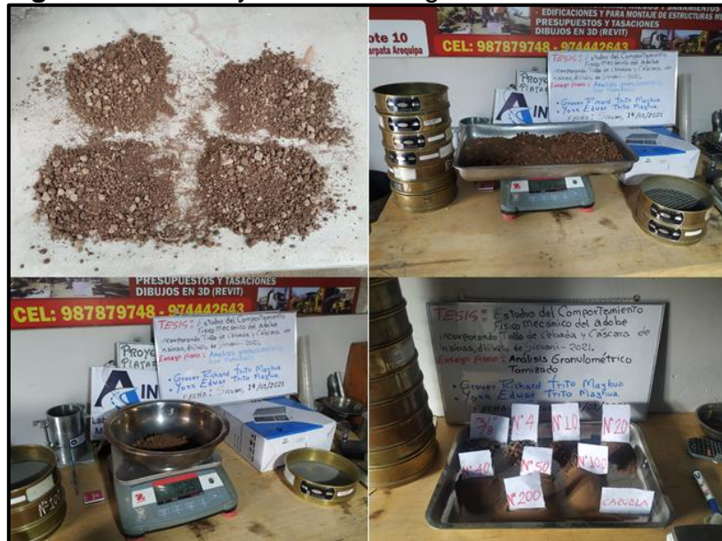
Figura 8: Ensayo del análisis granulométrico del suelo
