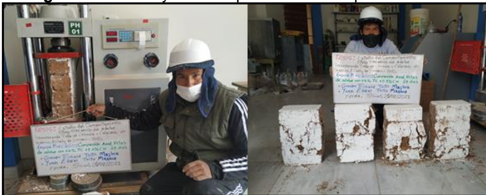
Figura 31: Ensayo de compresión axial en pilas de adobe.
