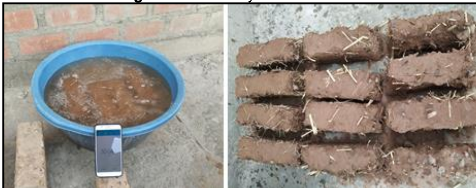
Figura 26: Ensayo de absorción.
