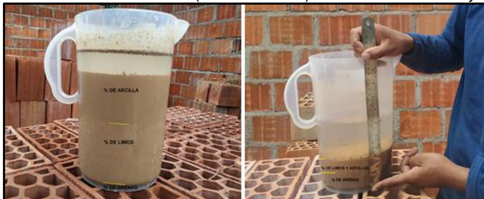
Figura 7: Prueba de la botella (sedimentación) - Cantera de Chumo y Trapiche
