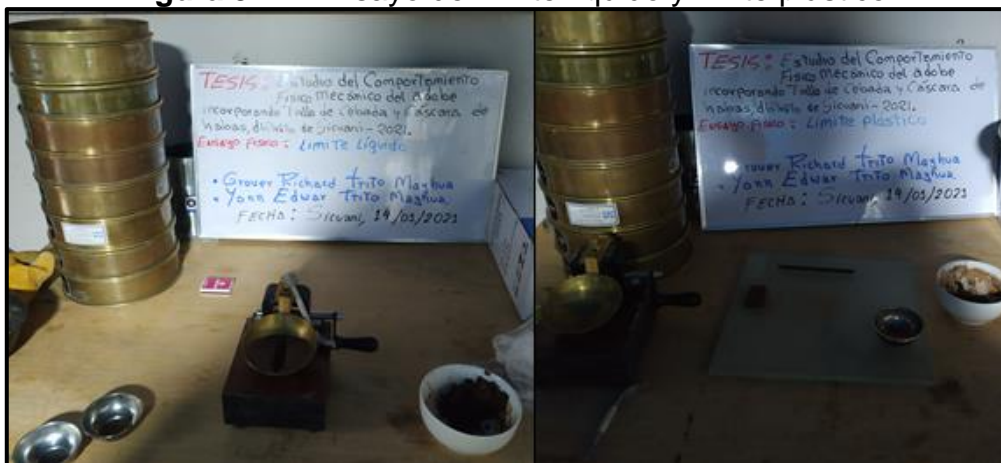
Figura 9: Ensayo del límite líquido y limite plástico
