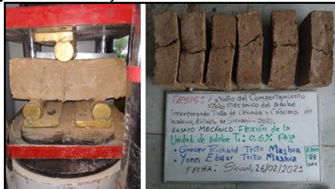
Figura 28: Ensayo de flexión de la unidad de adobe.
