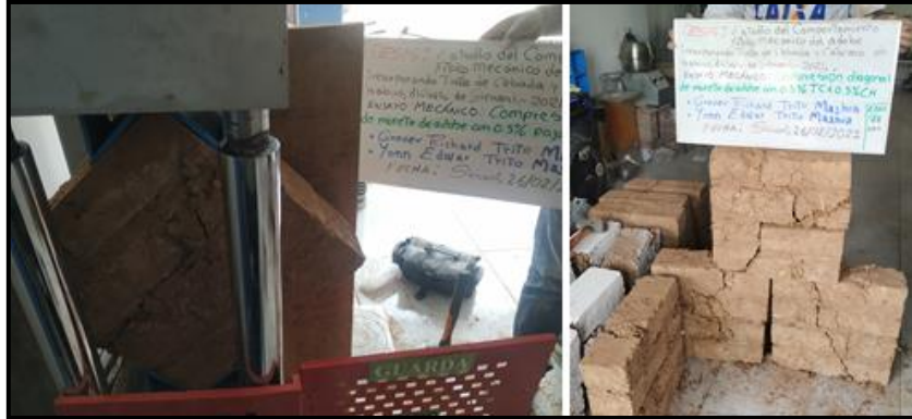
Figura 32: Ensayo de compresión diagonal en muretes de adobe.
