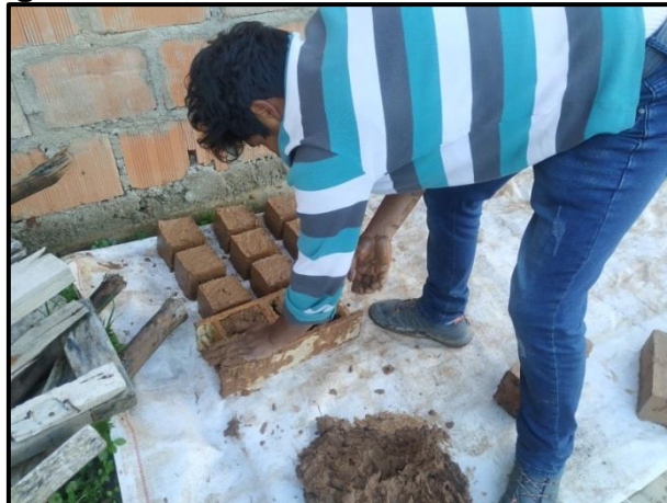
Figura 21: Producción de cubos de mortero
