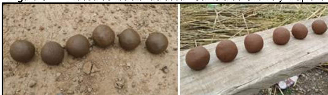
Figura 6: Prueba de resistencia seca - Cantera de Chumo y Trapiche
