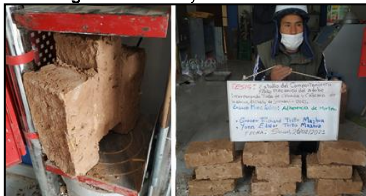
Figura 30: Ensayo de adherencia.
