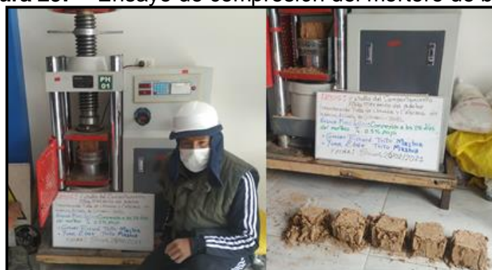
Figura 29: Ensayo de compresión del mortero de barro.
