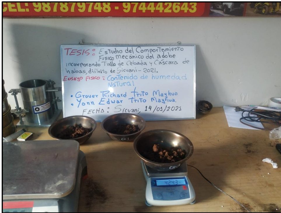
Fotografía 09: Vista del ensayo de contenido de humedad de la cantera de Trapiche.
