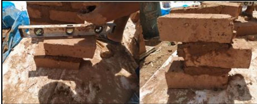
Figura 22: Pilas de adobe para la adherencia del mortero
