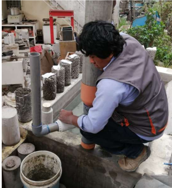
Fig. 45: Ensayo de permeabilidad de los especímenes.
