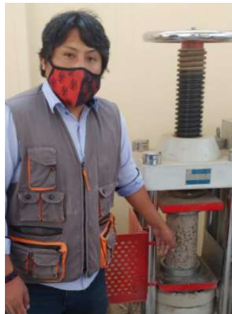
Fig. 31: Roturas de probetas en prensa para obtener la resistencia a la compresión.
