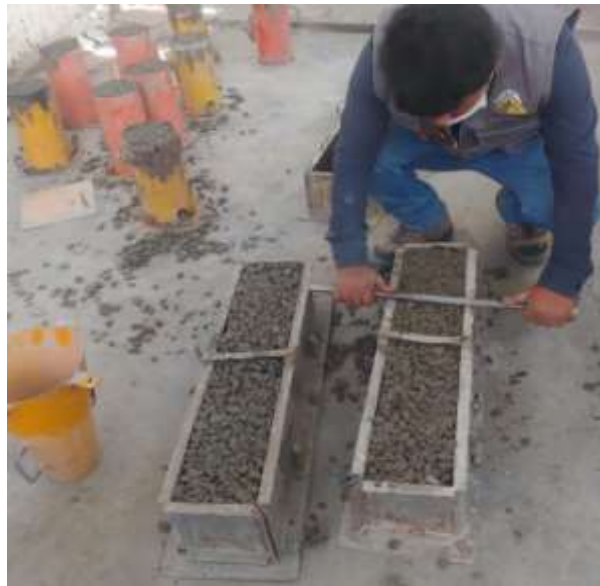
Fig. 28: Enrasado en moldes de viga para concreto permeable.
