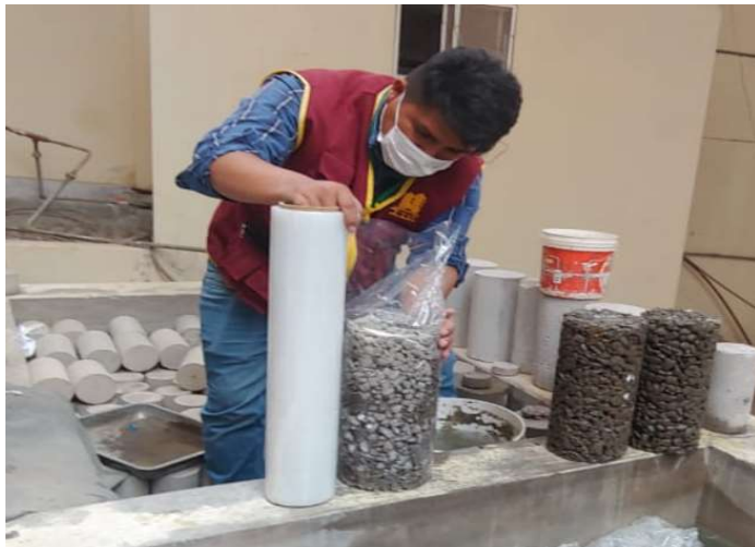
Fig. 44: Recubrimiento de los especímenes para ser ensayados.
