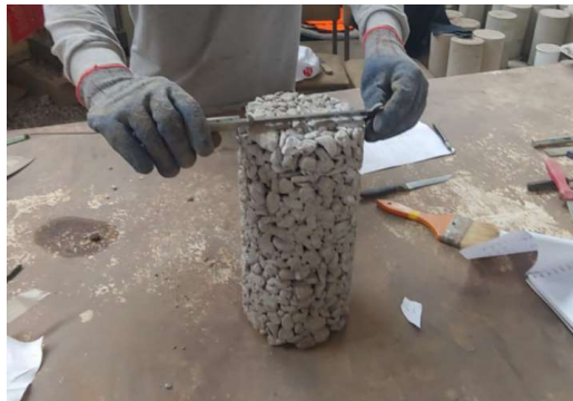
Fig. 30: Medición del diámetro de probetas cilíndricas de concreto permeable
