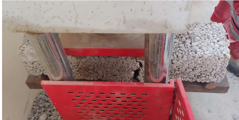
Fig. 37: Rotura de viga de concreto permeable.
