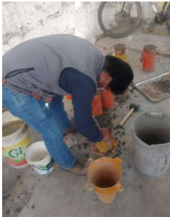
Fig. 26: Enrasado de probetas cilíndricas de concreto permeable.
