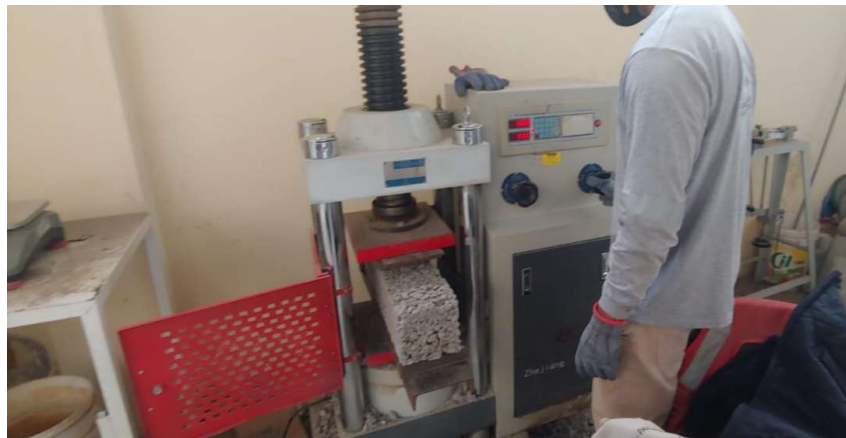
Fig. 36: Ensayo de resistencia a la flexión para vigas de concreto permeable.
