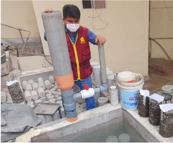
Fig. 43: Permeámetro diseñado para el ensayo de permeabilidad.
