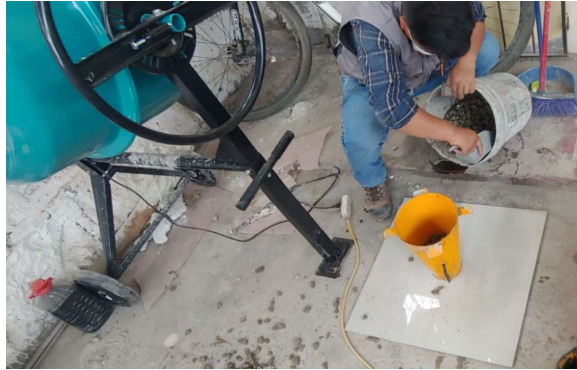
Fig. 21: Llenado de cono de Abrams invertido.
