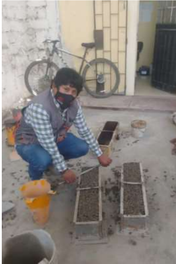
Fig. 29: Acabado de muestras para vigas de concreto permeable.
