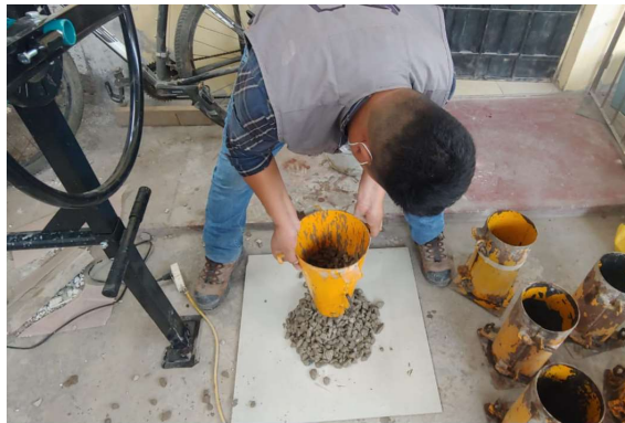
Fig. 22: Ensayo de cono de Abrams invertido.
