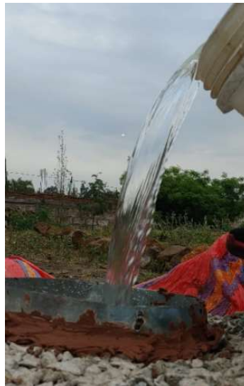
Fig. 54: Ensayo de infiltración del prototipo.
