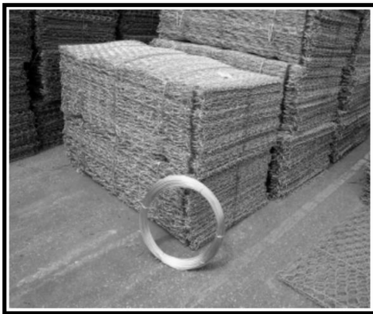
Figura 3. Fardos de Gaviones y ralla de alambre de amarre.
