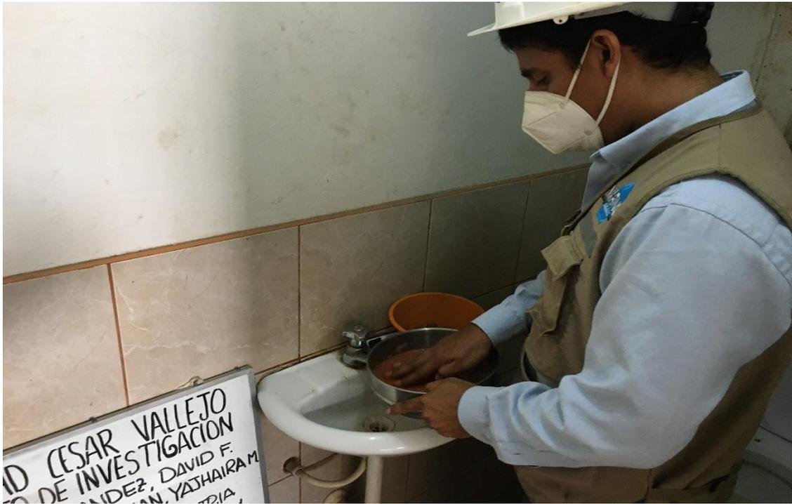
Fotografía 16. Vista del lavado del ensayo de granulometría, calicata 10, muestra 3
