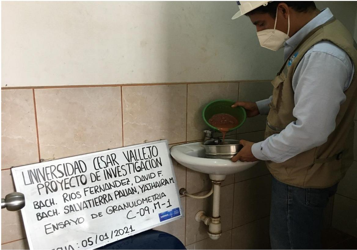
Fotografía 17. Vista del lavado del ensayo de granulometría, calicata 09, muestra 1.
