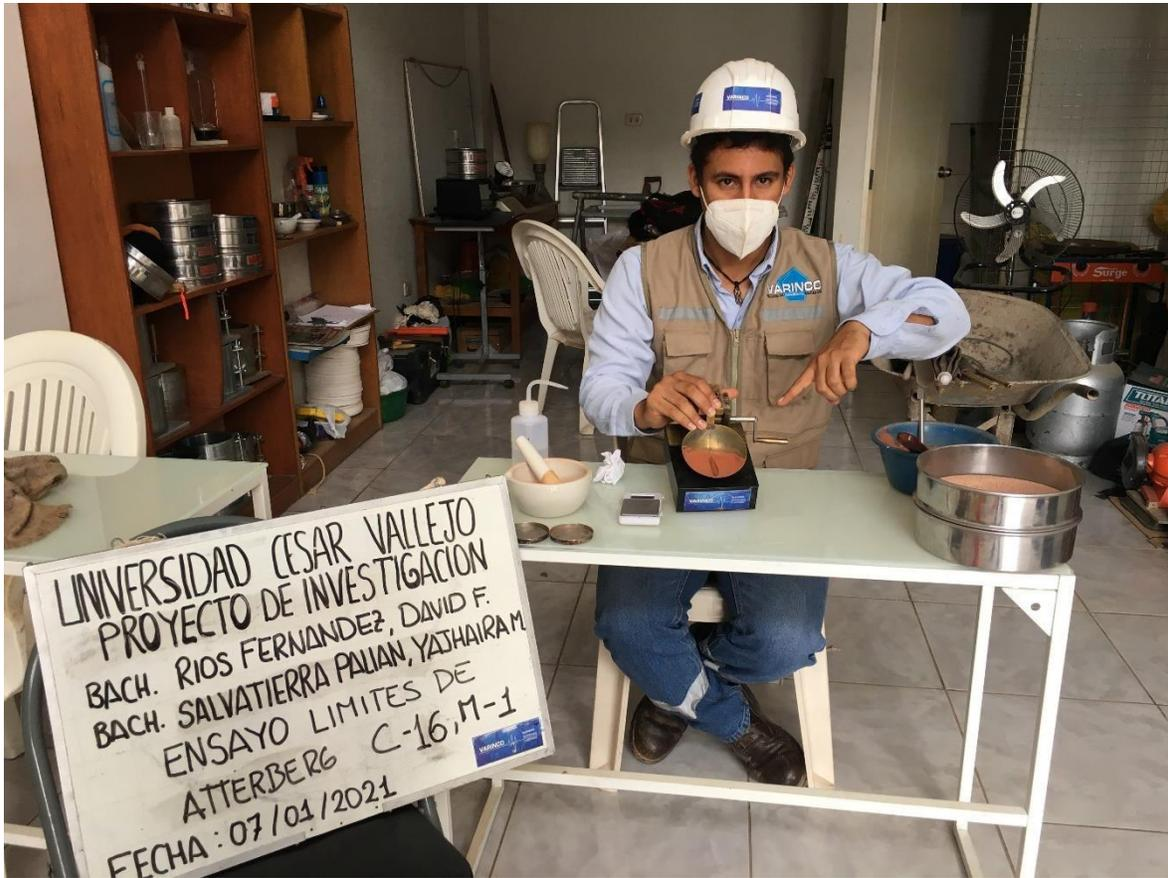
Fotografía 18. Vista del ensayo de Limite Liquido, calicata 16, muestra 1.
