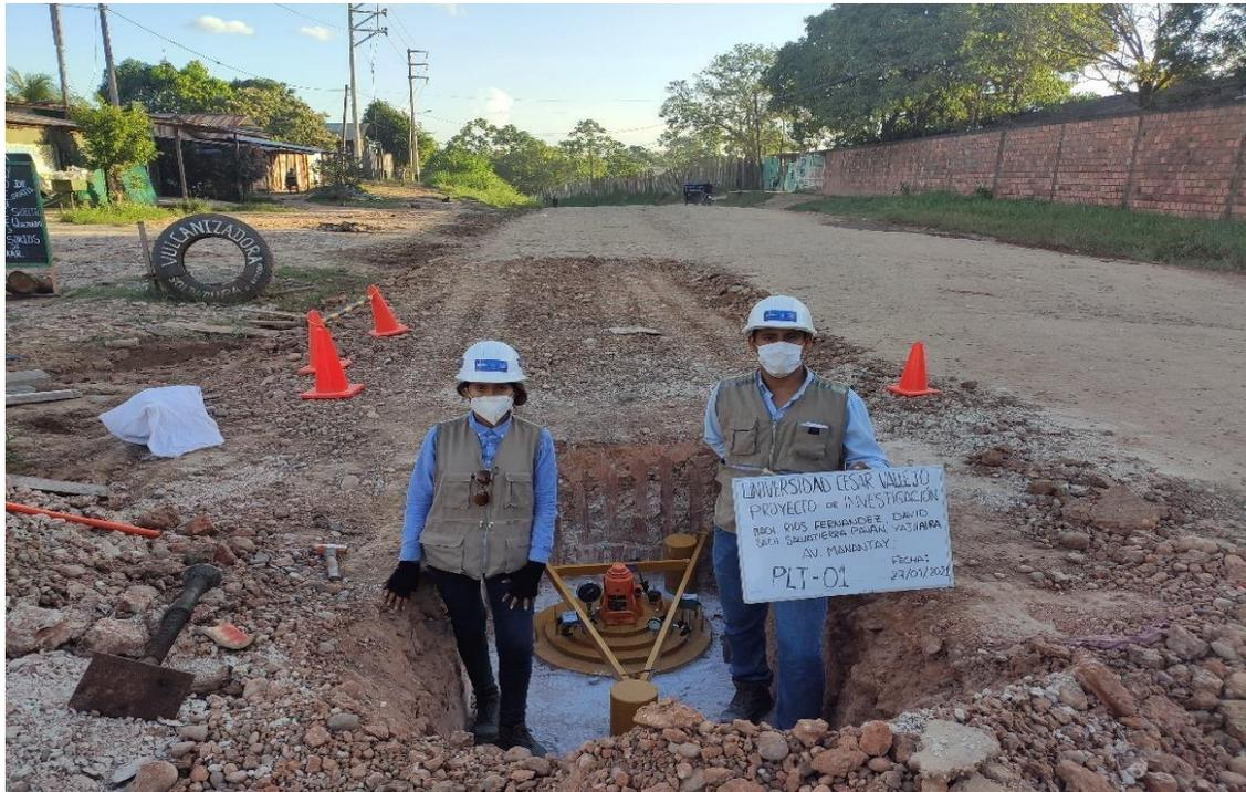
Fotografía 22. Vista después del ensayo 01 de Placa de Carga Estática No Repetida en Av. Manantay.
