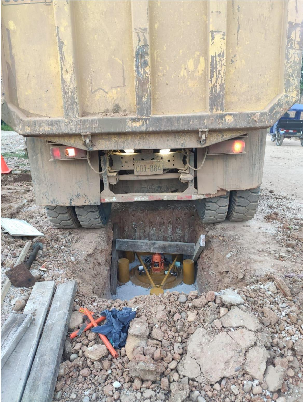
Fotografía 20. Colocación del Volquete en zona de ensayo N° 01 de Placa de Carga Estática No Repetida en Av. Manantay.
