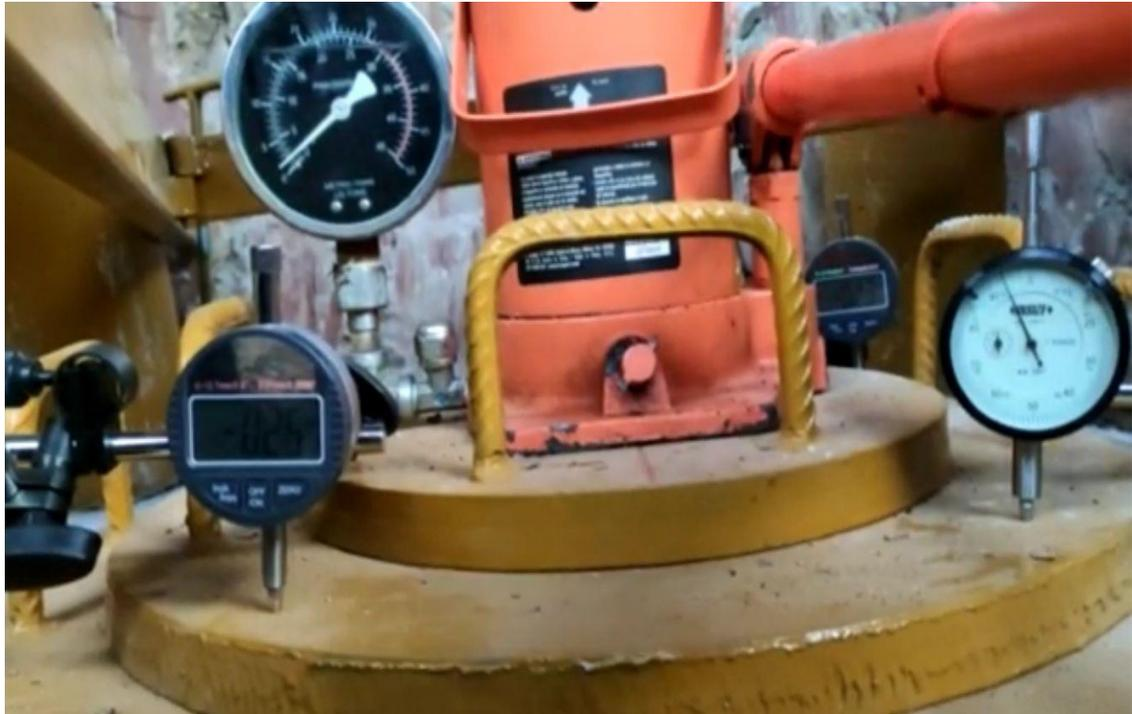
Fotografía 21. Vista del ensayo 01 de Placa de Carga Estática No Repetida en Av. Manantay.
