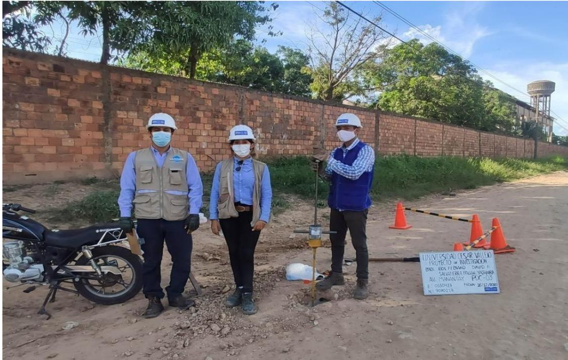
Fotografía 8. Ensayo in situ PDC 03 en Av. Manantay.
