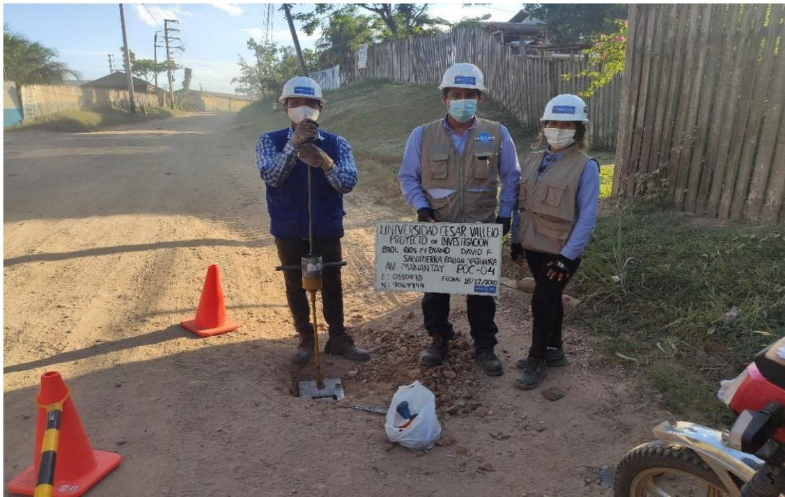
Fotografía 9. Ensayo in situ PDC 04 en Av. Manantay.
