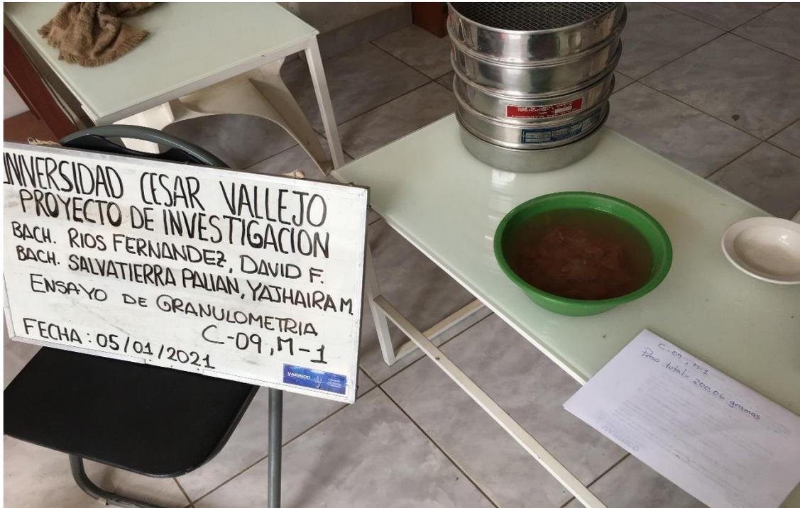
Fotografía 14. Humectación de muestra para ensayo de Granulometría, calicata 09, muestra 1.
