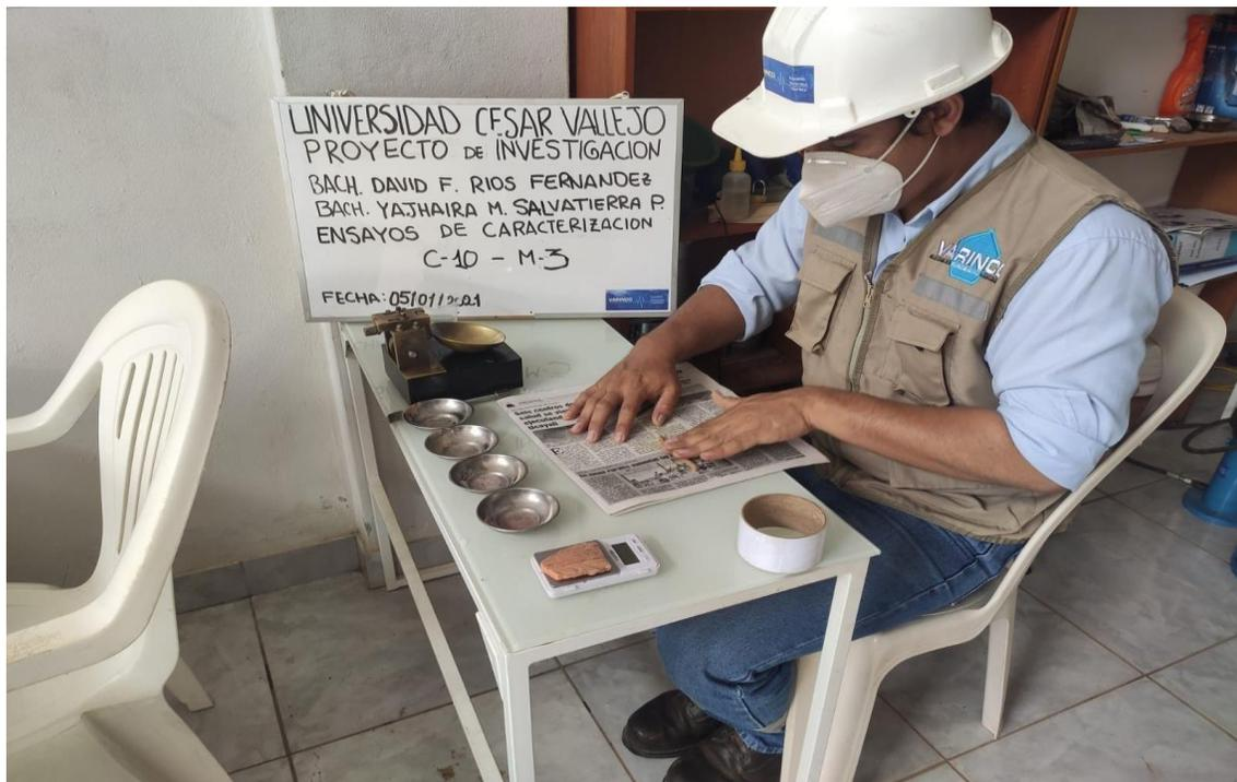
Fotografía 19. Vista del ensayo de Limite Liquido, calicata 10, muestra 3.
