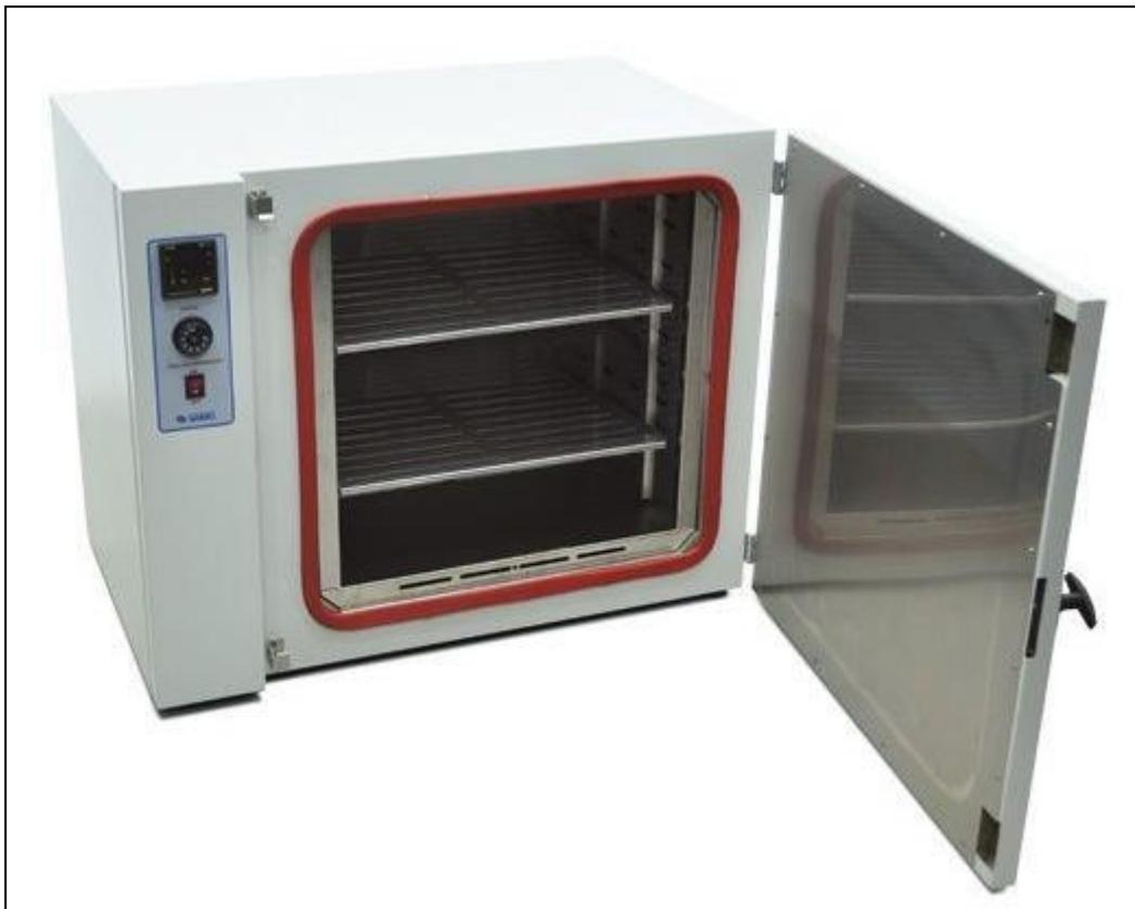
*Figura 2. Horno para los ensayos de contenido de humedad.*
