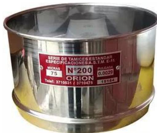
*Figura 3. Malla especial de lavado de muestras de Suelos.*
