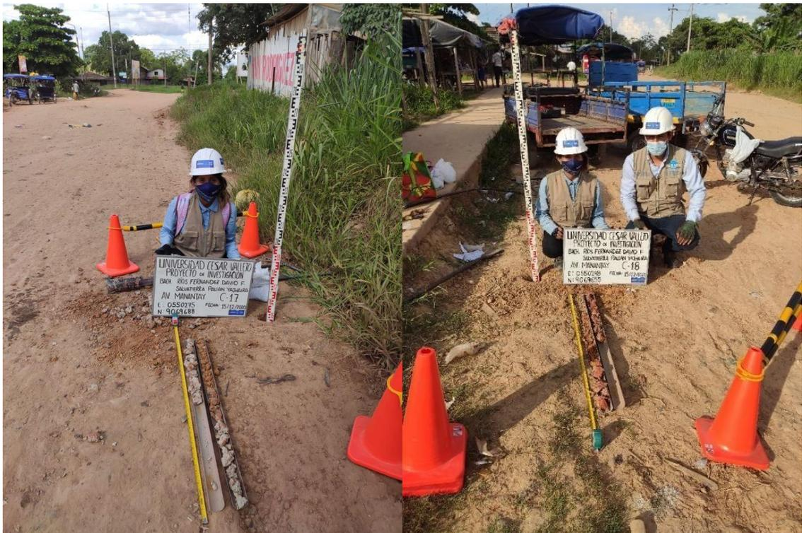
Fotografía 6 y 7. Exploración geotécnica, calicatas 17 y 18, respectivamente.
