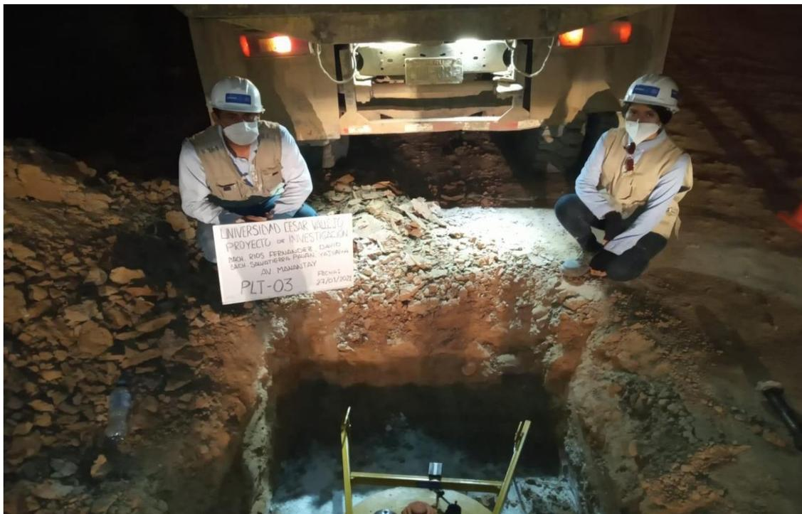
Fotografía 23. Vista después del ensayo 03 de Placa de Carga Estática No Repetida en Av. Manantay.
