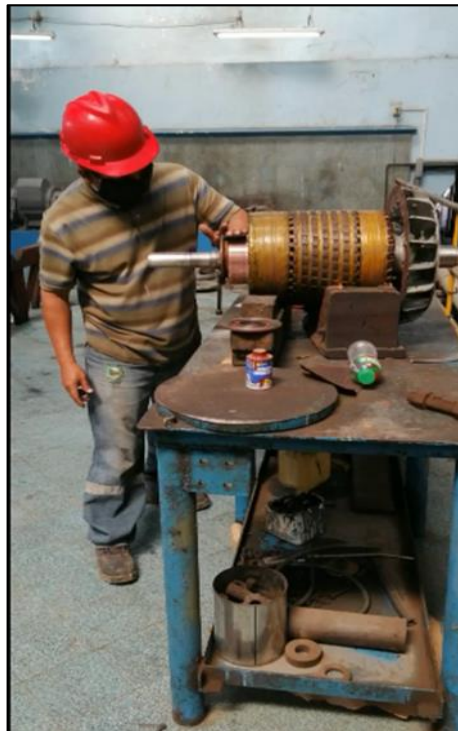
Figura 21. Reparación del motor de la excitatriz
