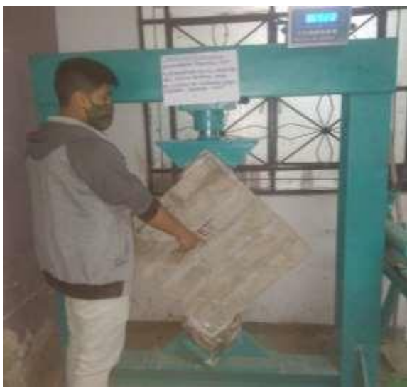
Figura 20: Ensayo de resistencia a compresión del murete. Figura 21: Forma de falla del murete
