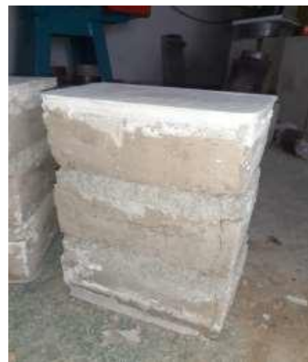
Figura 19: Forma de falla del pila.
