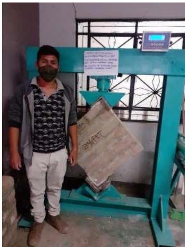
Figura 56: Ensayo de corte diagonal en muretes.
