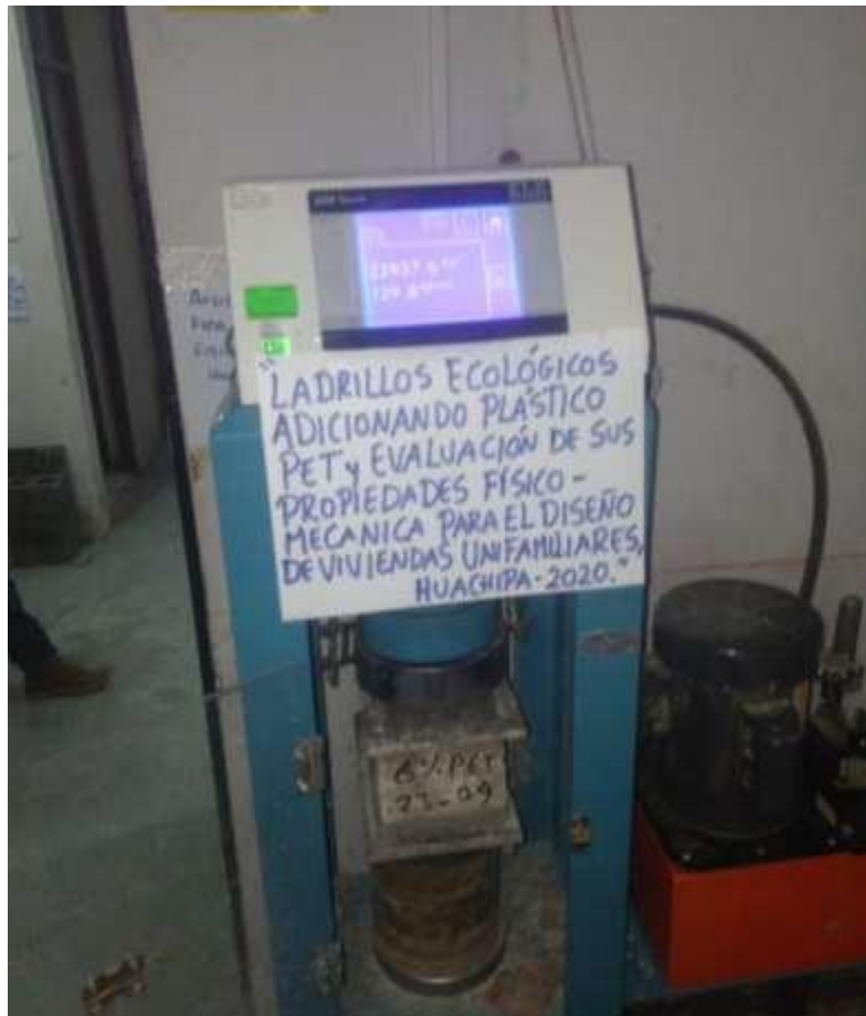
Figura 52: Ensayo a la compresión del ladrillo con 6% de PET.
