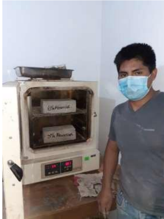
Figura 64: Ensayo de absorción- secado del ladrillo en el horno por 24hrs.
