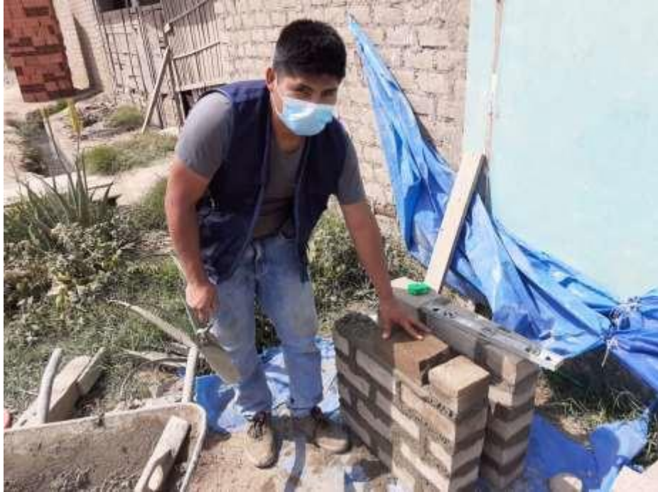
Figura 46: Construcción de muretes para los diferentes porcentajes de PET.
