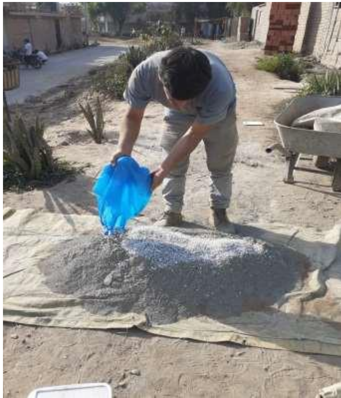
Figura 39: Proceso de mezclado en seco de arcilla, cemento y plástico PET.
