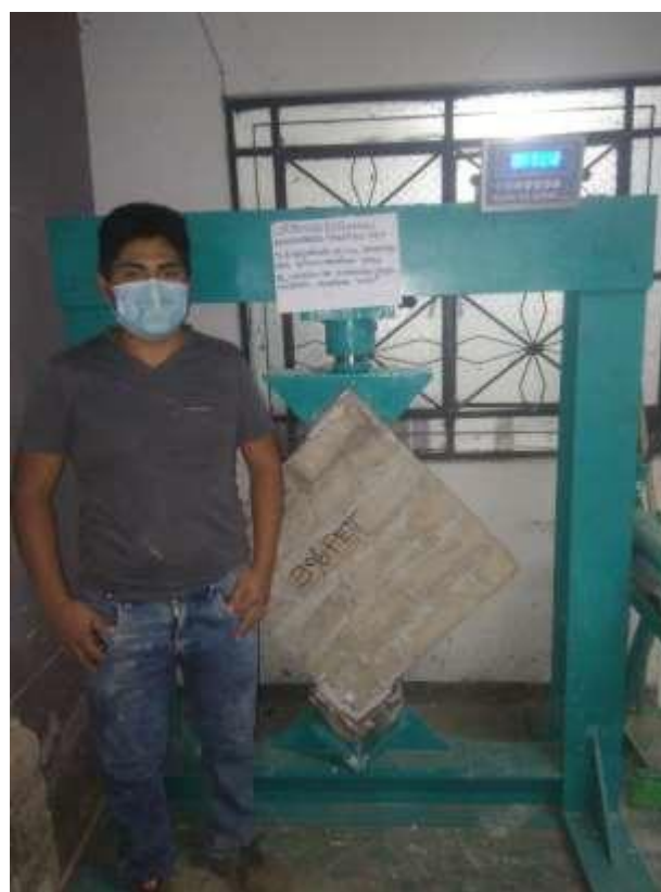
Figura 56: Ensayo de corte diagonal en muretes.
