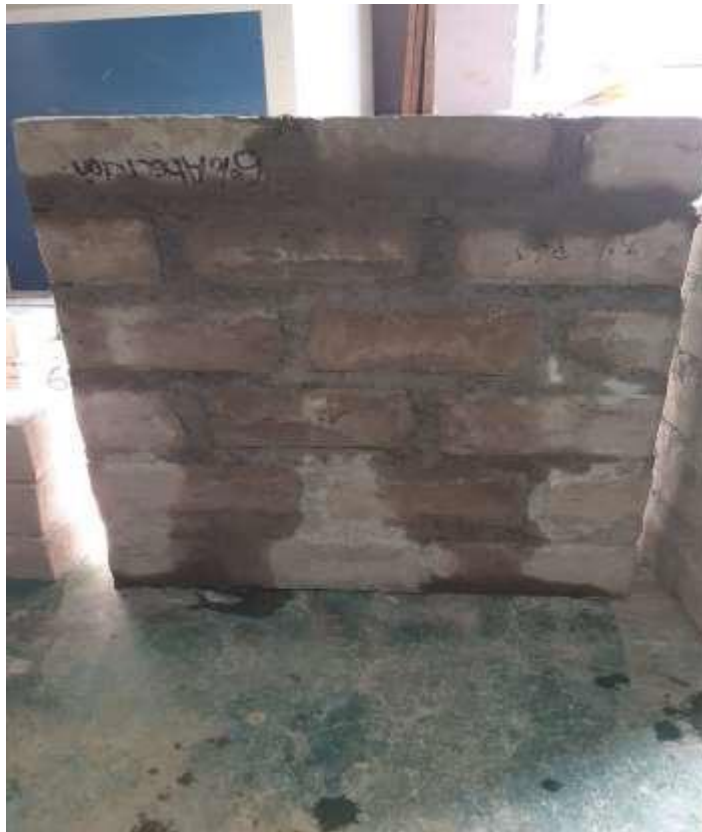
Figura 47: muretes de 60cmx60cm para ensayo de laboratorio.
