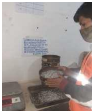
Figura 14: Ensayo granulométrico del PET.
