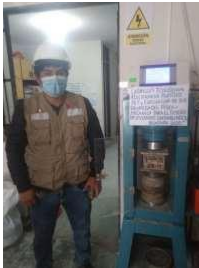
Figura 17: Ensayo de resistencia a compresión de unidad de albañilería.
