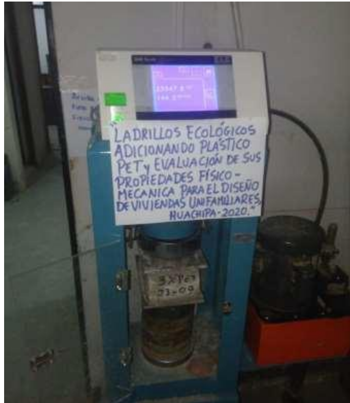
Figura 50: Ensayo a la compresión del ladrillo con 3% de PET.
