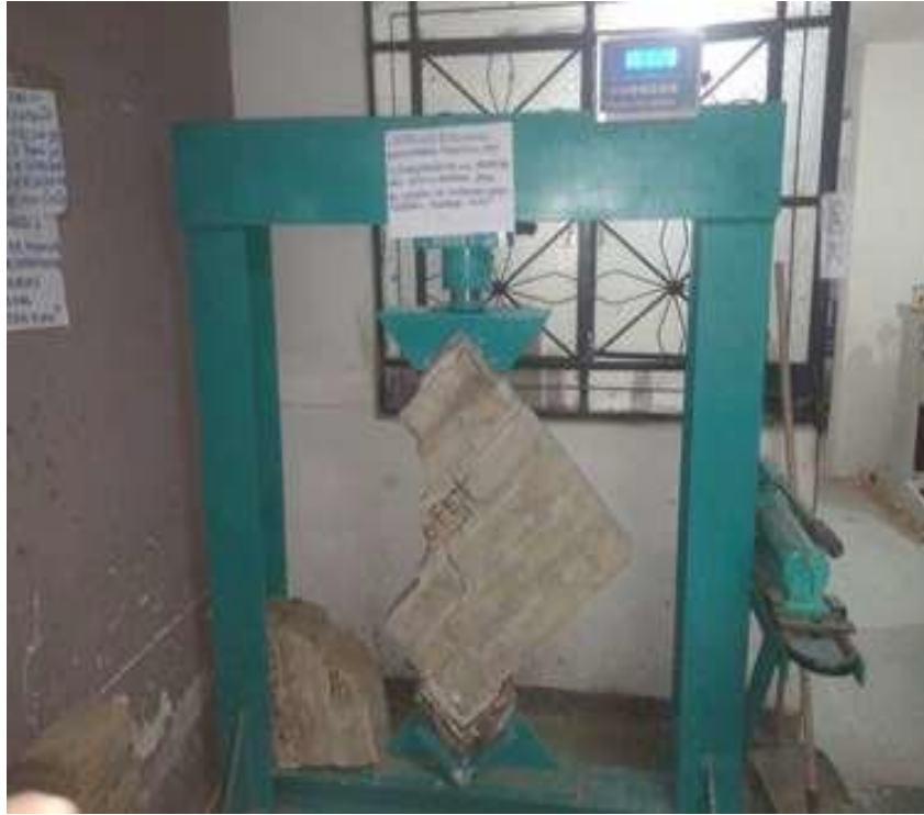
Figura 58: Falla del murete.
