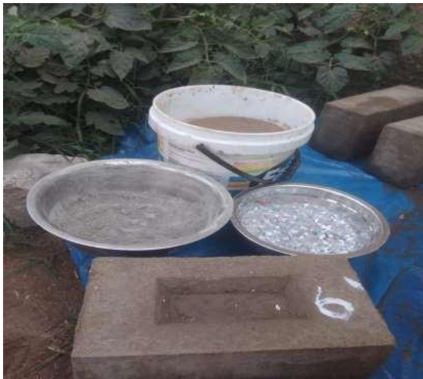
Figura 41: materiales (arcilla, cemento y plástico PET) para el ladrillo ecológico.
