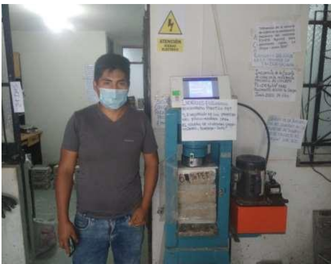
Figura 18: Ensayo de resistencia a compresión en pilas.
