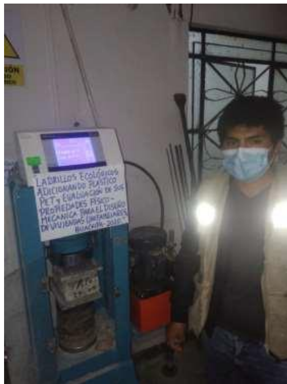
Figura 53: Ensayo de resistencia a la compresión del ladrillo con 9% de PET.
