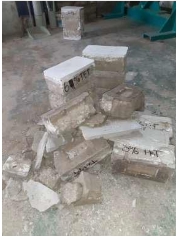
Figura 60: Falla de pilas.
