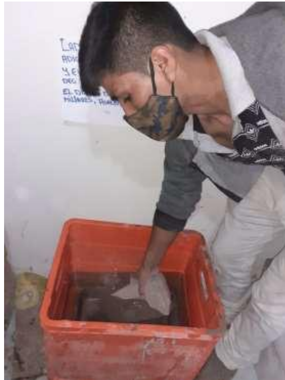
Figura 65: Ensayo de absorción- sumergido de los ladrillos en el agua por 24hrs.
