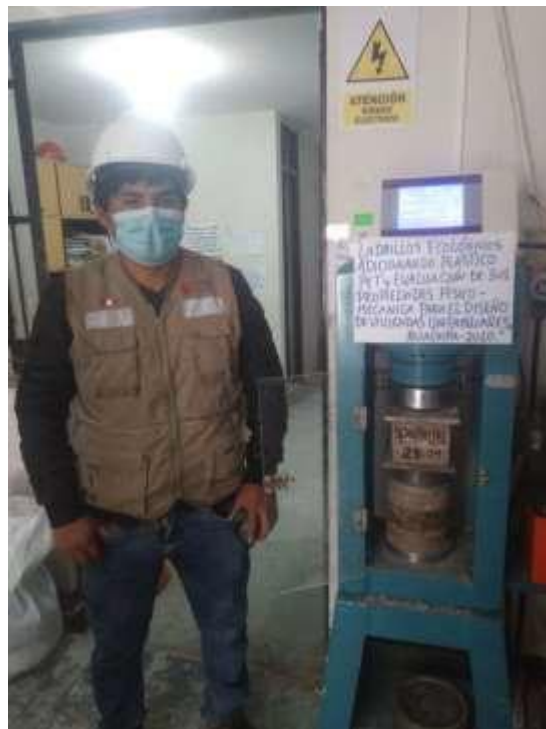
Figura 49: Ensayo de resistencia a la compresión del ladrillo con 3% de PET.
