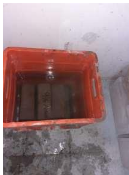
Figura 22: Secado del ladrillo ecológico en el horno. Figura 23: Ladrillos sumergidos en el agua.
