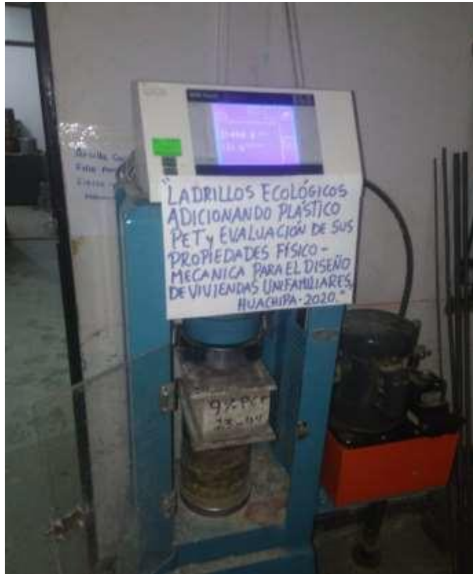
Figura 54: Resultado de ensayo a la compresión del ladrillo con 9% de PET.
