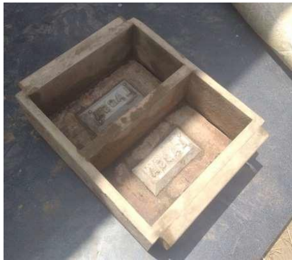
Figura 9: Molde de madera para los ladrillos ecológicos.
