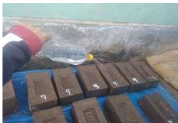
Figura 11. Curado de los ladrillos ecológicos después de 24 horas.
