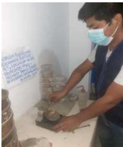
Figura 15: Ensayo de límite líquido (uso de la copa de Casagrande).
