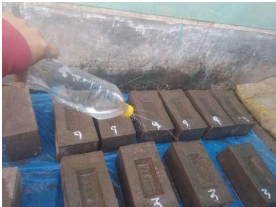
Figura 43: Curado de los ladrillos ecológicos.
