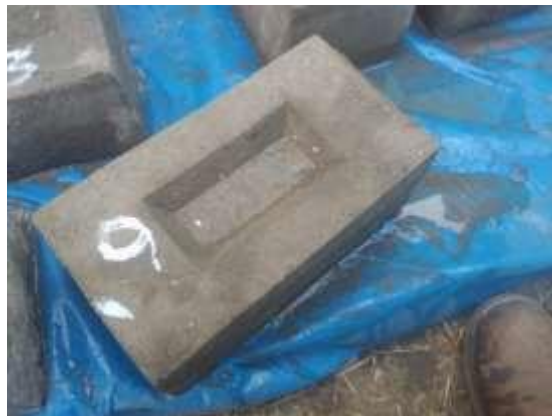
Figura 10: Ladrillo ecológico terminado con 9% de PET.
