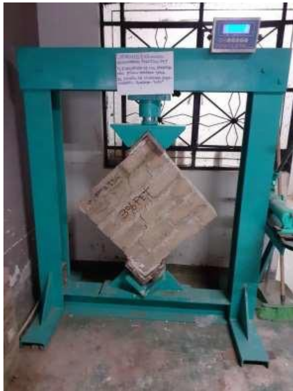
Figura 55: Ensayo de corte diagonal en muretes.
