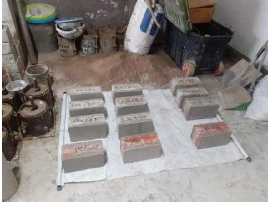
Figura 48: Refrentado o capeado de la unidad de albañilería.
