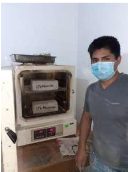
Figura 22: Secado del ladrillo ecológico en el horno. Figura 23: Ladrillos sumergidos en el agua.
