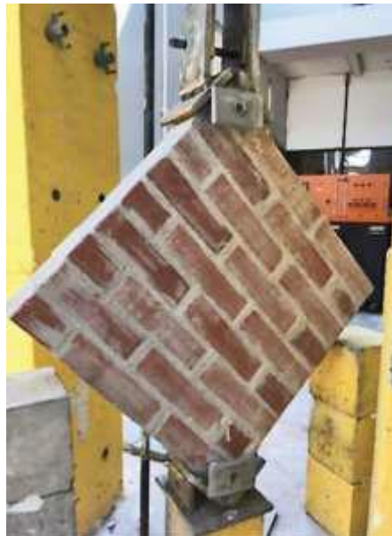
Figura 7. Ensayo de resistencia a la compresión diagonal
