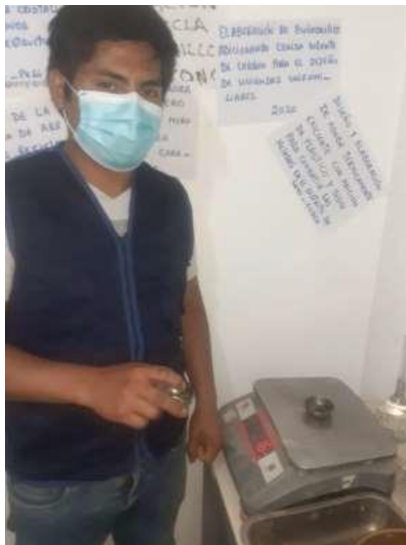
Figura 63: Ensayo de límites de atterberg- tarado de los cilindros antes de poner al horno.
