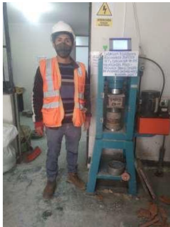
Figura 51: Ensayo de resistencia a la compresión del ladrillo con 6% de PET.
