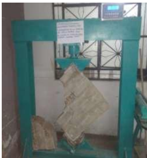
Figura 20: Ensayo de resistencia a compresión del murete. Figura 21: Forma de falla del murete
