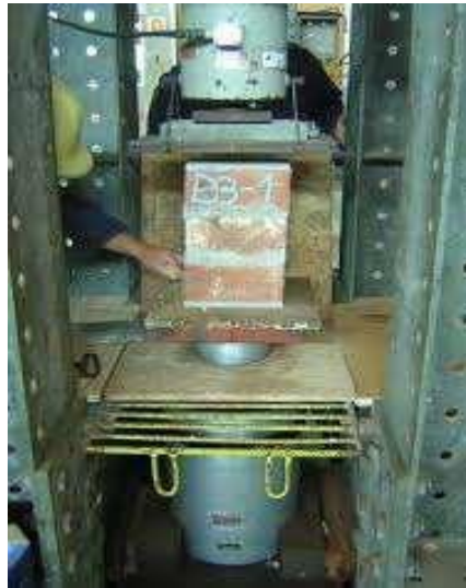
Figura 5. Ensayo de resistencia a la compresión axial.
